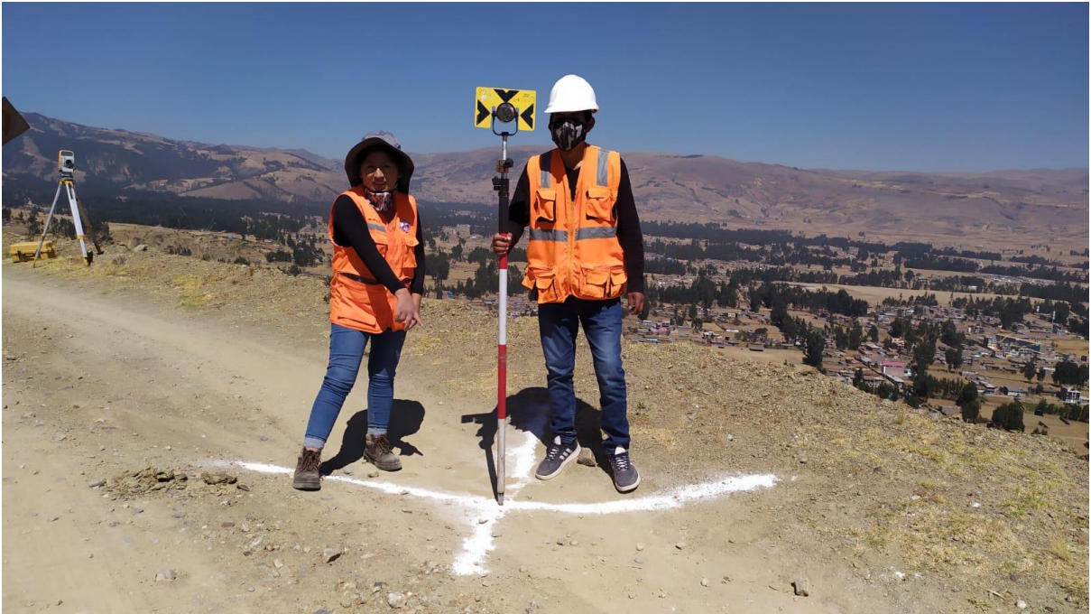
figura 38: Pintado y reconocimiento de las dianas , para iniciar el levantamiento con el dron
