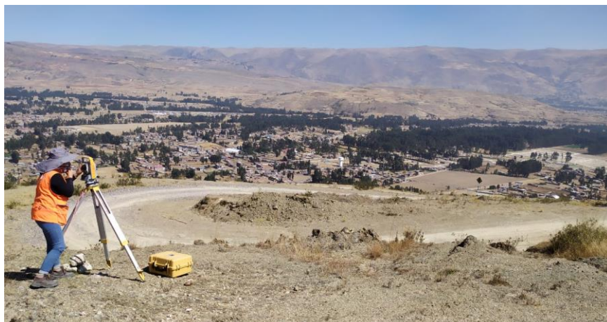
figura 37: levantamiento topográfico con estación total
