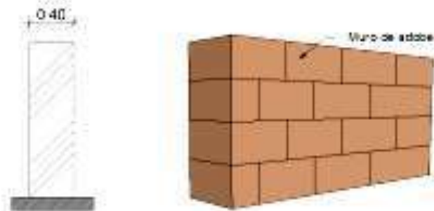
Figura 30. Muro de adobe – Vivienda experimental
