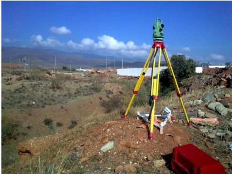
Ubicación de los puntos BM para el levantamiento topográfico
