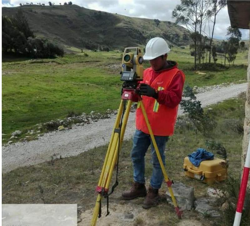
Cambio de estación en puntos no visibles por la topografía
