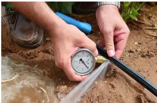
Figura 11. Instalación de manómetro
