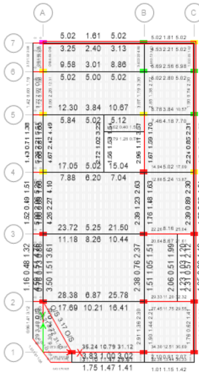
Figura 92. Área de acero necesario en planta del piso 3, calculado en el programa ETABS. Elaborado por el investigador.
