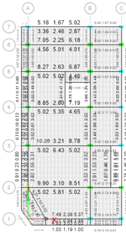
Figura 39. Área de acero necesario en planta para el piso 3, calculado en el programa ETABS. Elaborado por el investigador.
