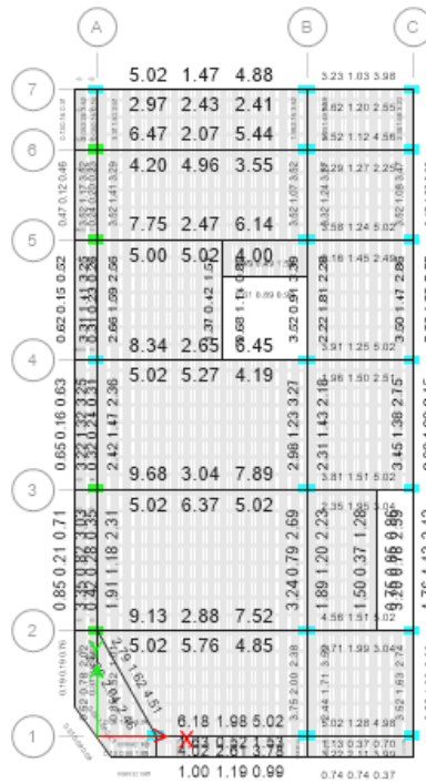
Figura 40. Área de acero necesario en planta para el piso 4, calculado en el programa ETABS. Elaborado por el investigador.
