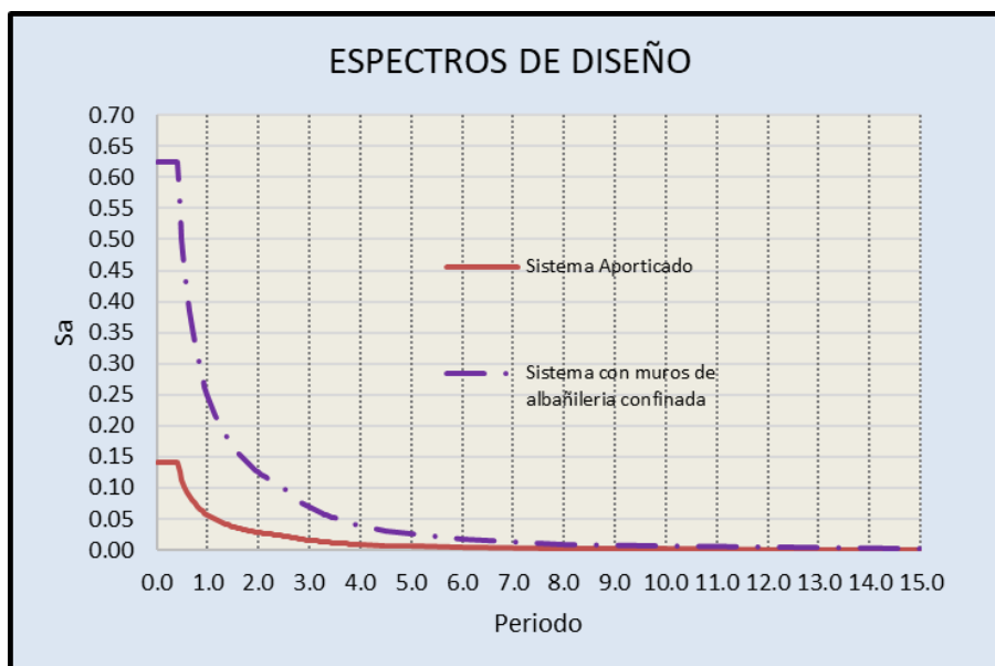
Figura 100. Diagrama del espectro para el diseño, periodo - aceleración.
