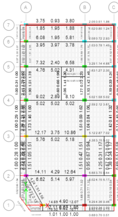
Figura 94. Área de acero necesario en planta del piso 5, calculado en el programa ETABS. Elaborado por el investigador.
