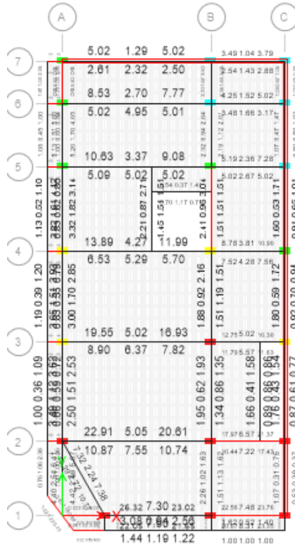
Figura 93. Área de acero necesario en planta del piso 4, calculado en el programa ETABS. Elaborado por el investigador.
