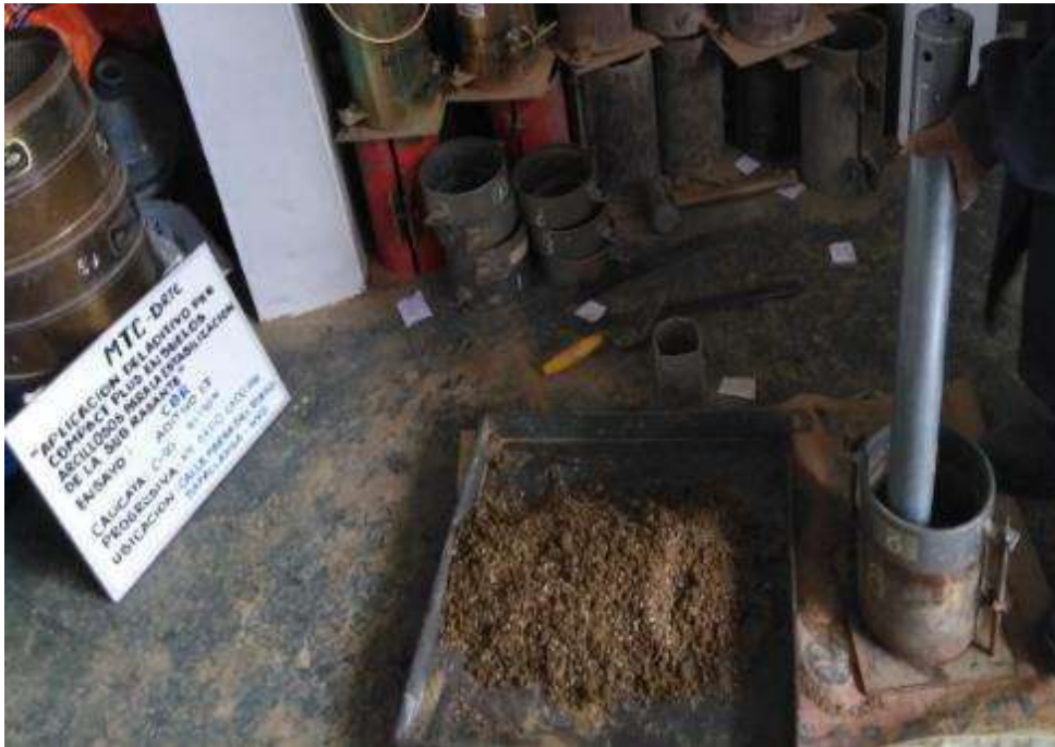
Fuente propia: Compactación del espécimen en 3 capas.
