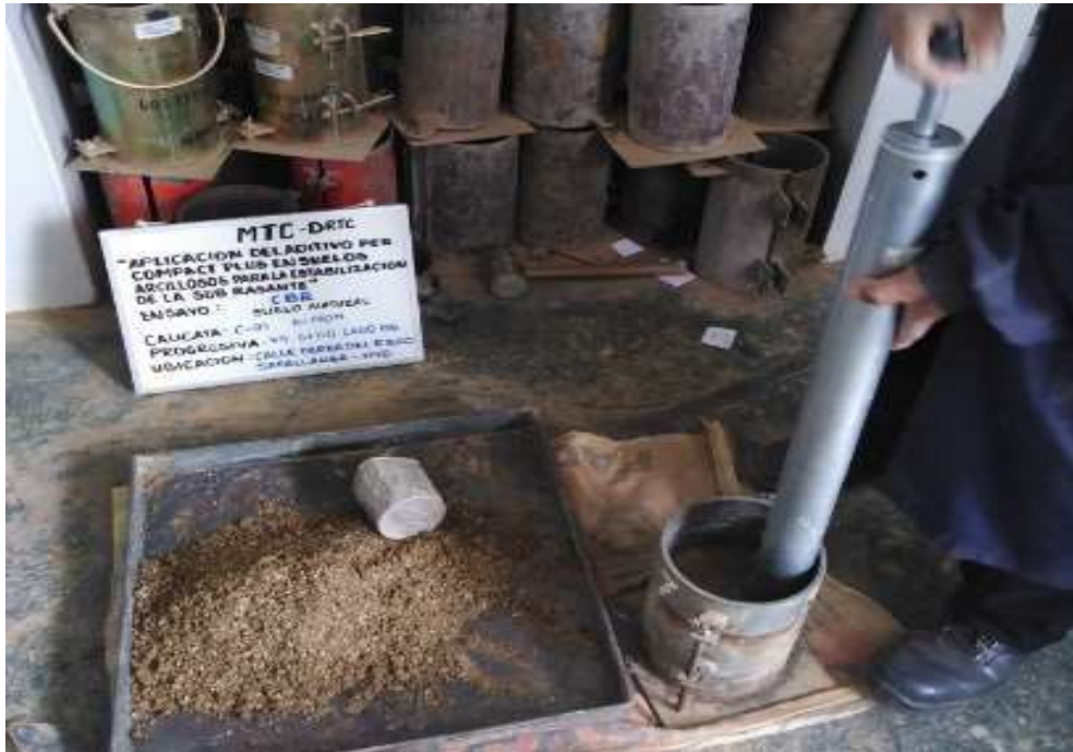
Fuente propia: Compactación del espécimen en 3 capas.
