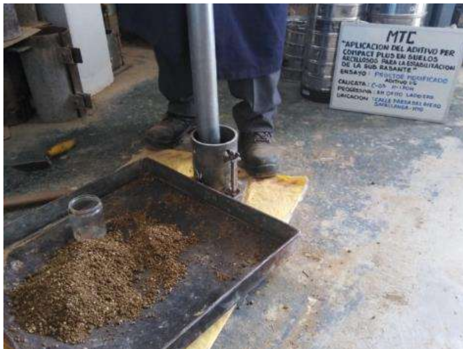
Fuente propia: Compactación de cada capa con 25 golpes.
