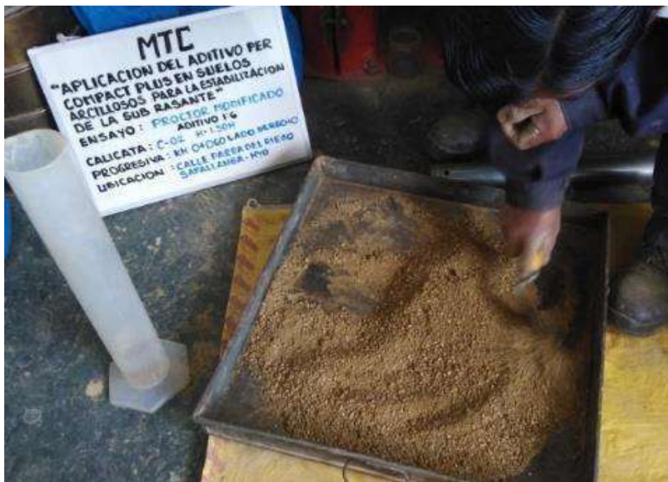
Fuente propia: Mezcla de suelo más la dilución del segundo espécimen.
