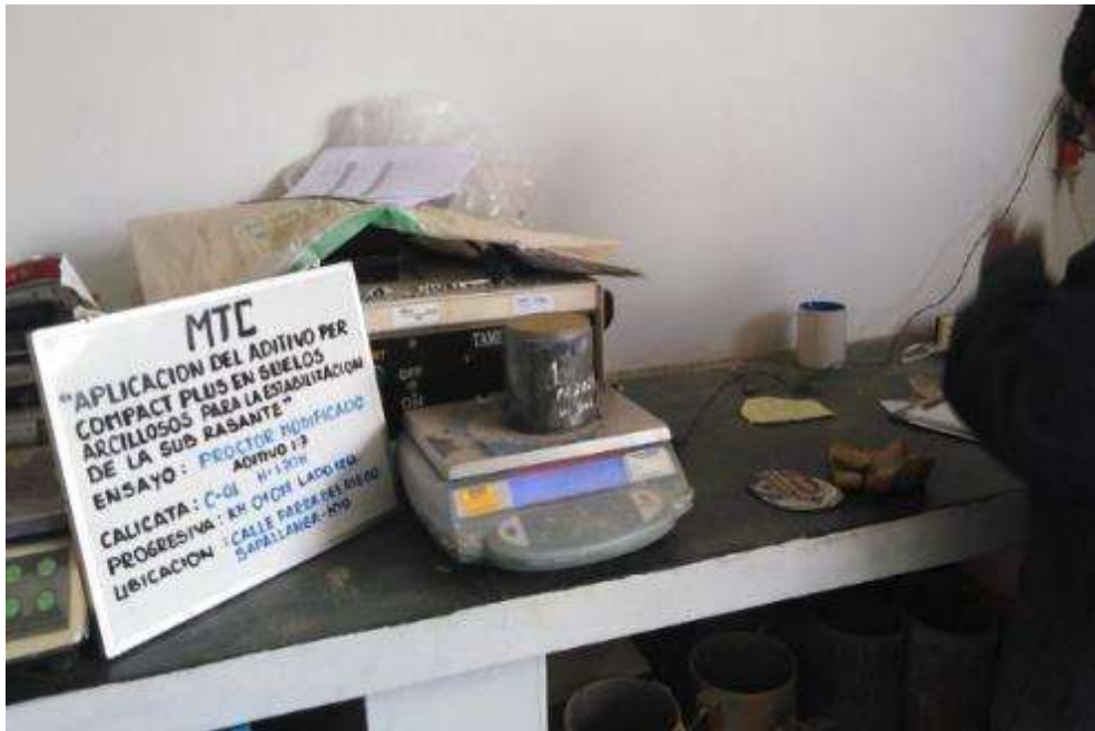
Fuente propia: Peso del molde más la muestra compactada en 5 capas.
