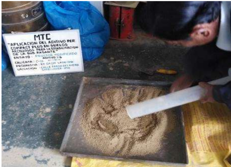
Fuente propia: Mezcla del suelo con la dilución del primer espécimen.
