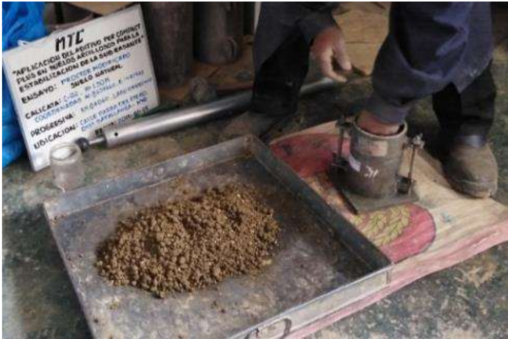
Fuente propia: Colocación de la mezcla en el molde por capas.
