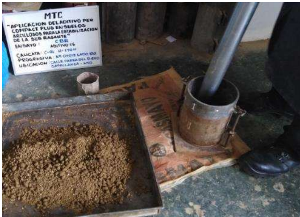
Fuente propia: Compactación del espécimen en 3 capas.
