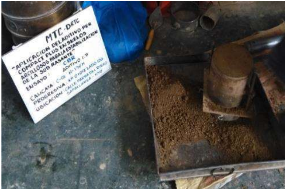
Fuente propia: Retiro del collar y enrase del espécimen
