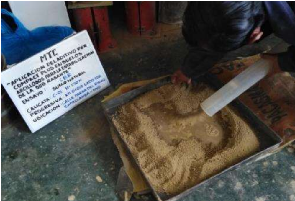
Fuente propia: Preparación de espécimen con la humedad óptima que se determinó con el Proctor Modificado.
