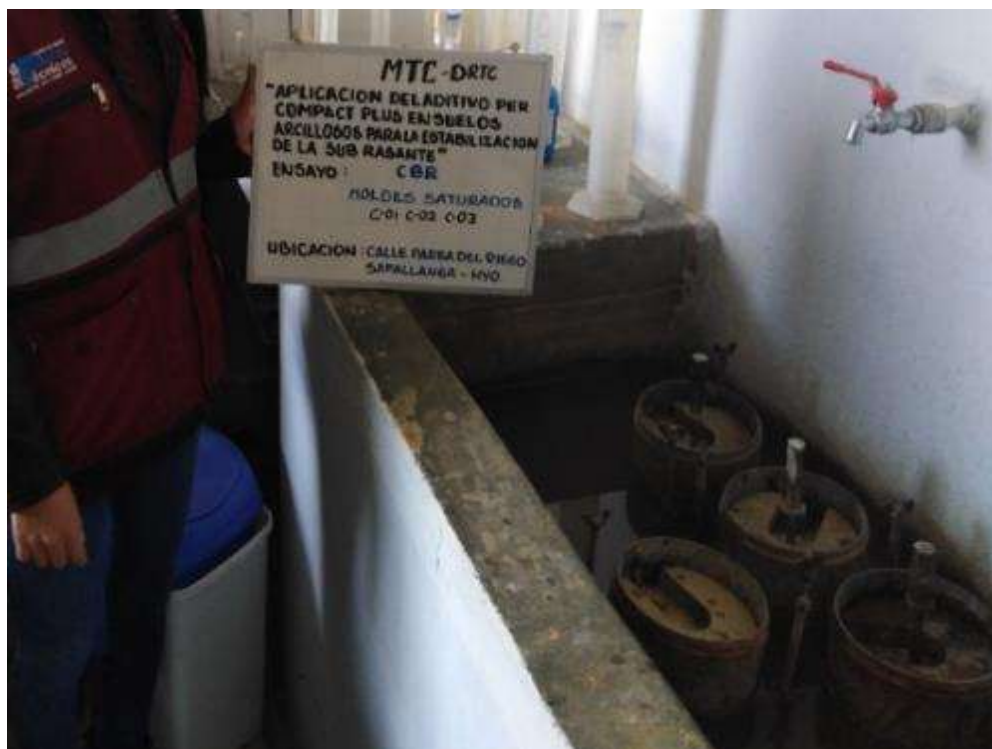
Fuente propia: Moldes preparados para ser sumergidos en el tanque con la sobrecarga colocada.
