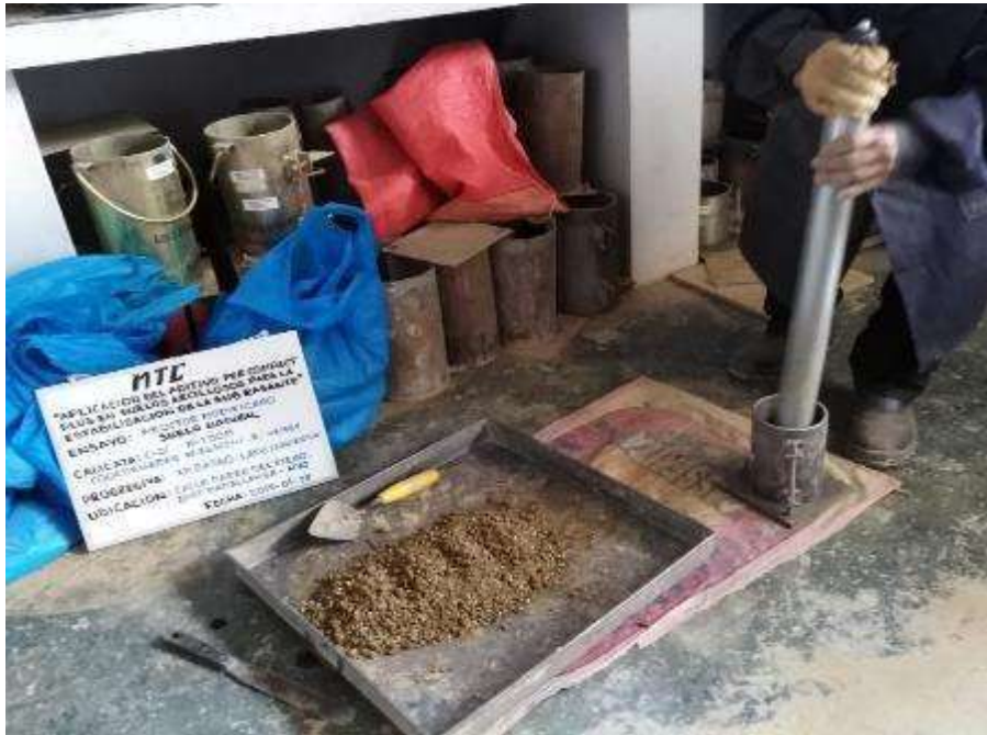
Fuente propia: Compactación de la muestra por capas.
