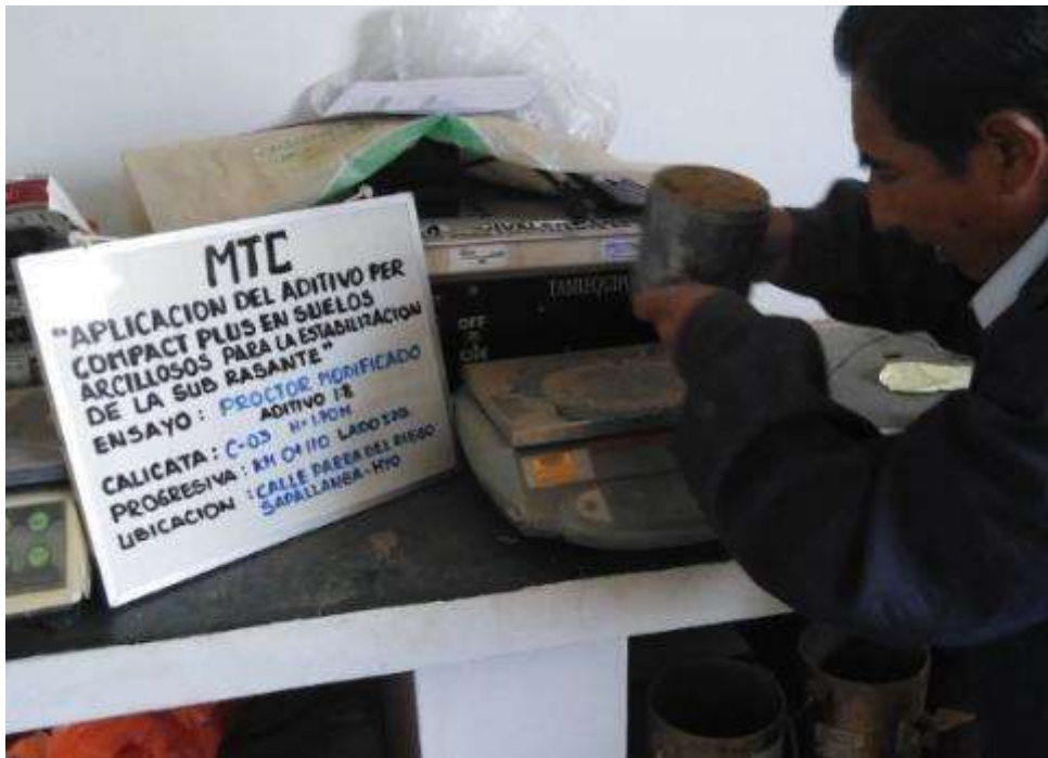
Fuente propia: Registro de la masa del espécimen y molde.
