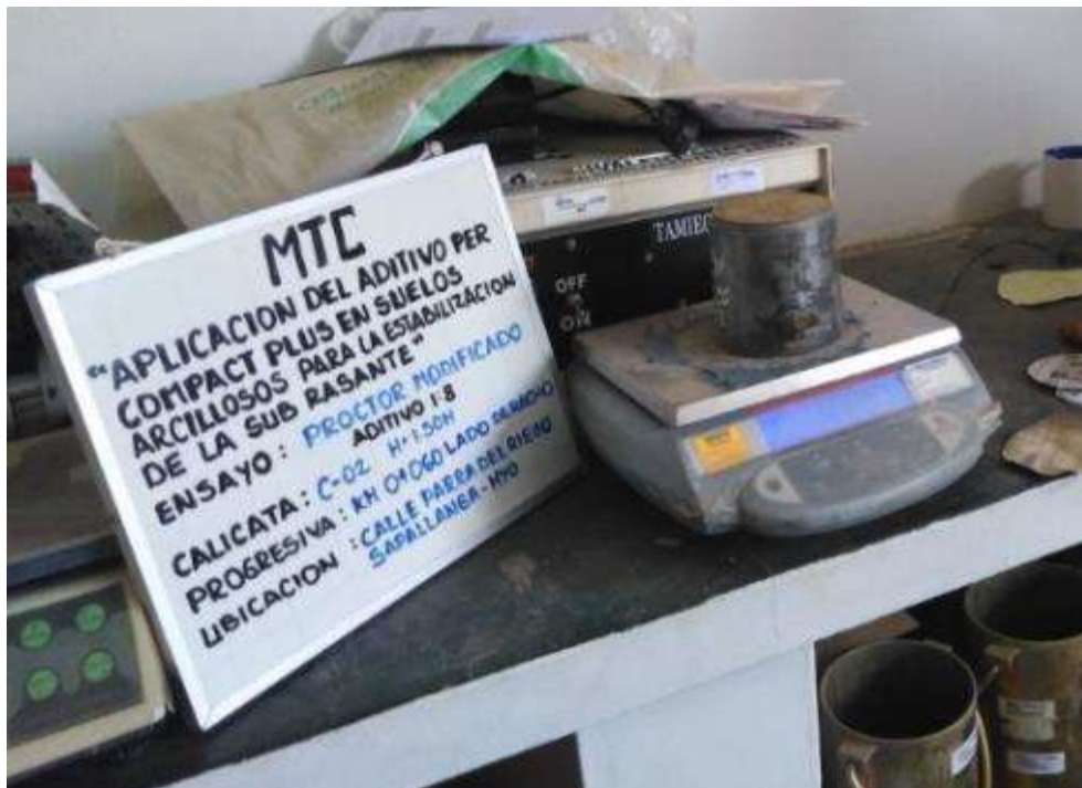
Fuente propia: Peso del molde más la muestra compactada en 5 capas.
