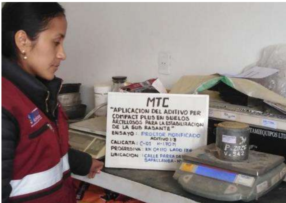
Fuente propia: Registro de la masa del espécimen y molde.
