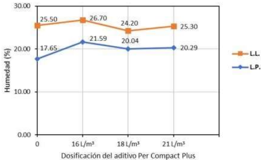
Figura 20. Variación de límites de consistencia con el aditivo de la calicata C-02
