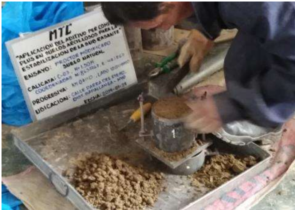
Fuente propia: Enrase del espécimen compactado con una regla recta.
