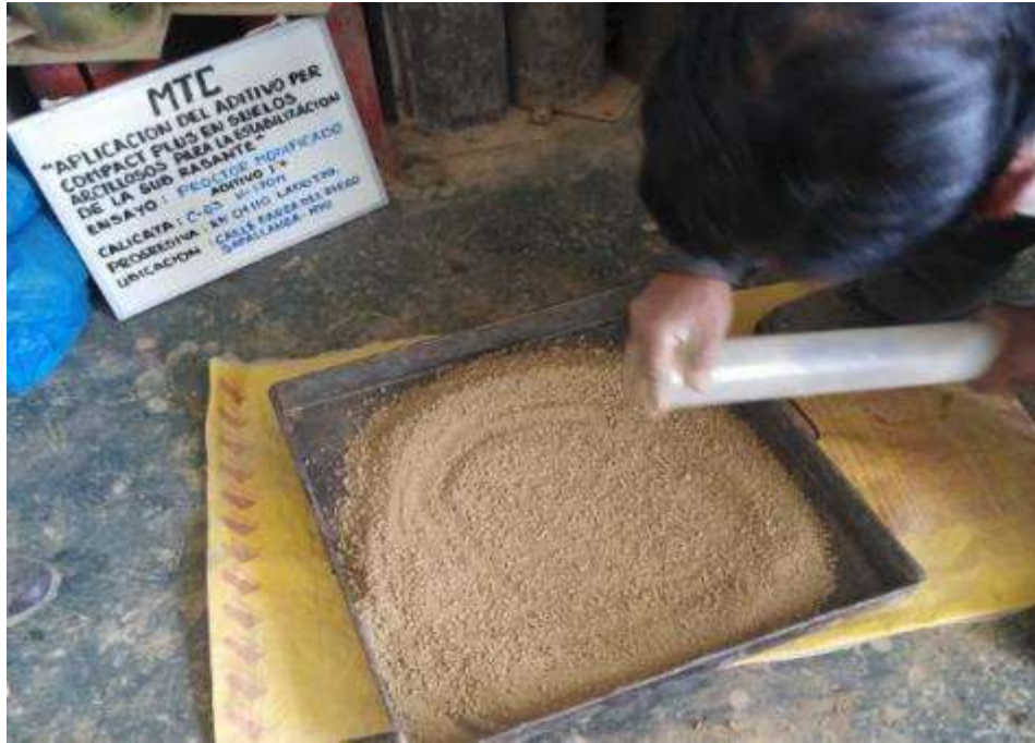
Fuente propia: Preparación de espécimen con la dilución.
