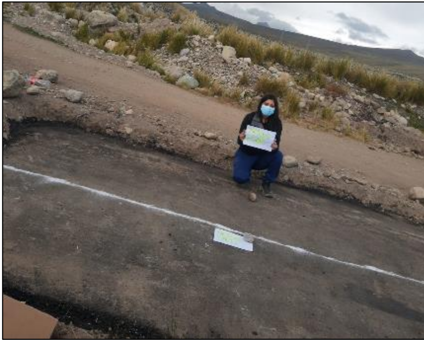
Fotografía 9. Tramo de prueba elaborado con metodología Shell
