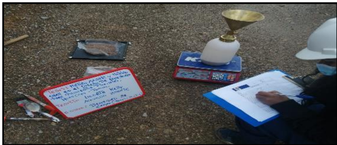
Fotografía N°7: Peso del cono con la arena que quedo.
