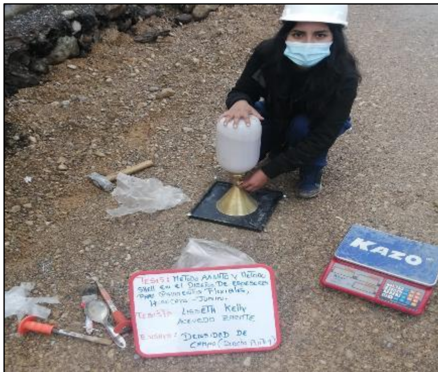
Fotografía 3. Medición de la densidad de campo o el grado de compactación de la base granular.
