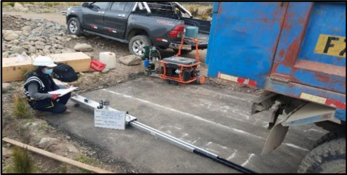
Fotografía N°3: Lectura de la viga Benkelman después de arrancado el volquete de 8 toneladas – Método SHELL.
