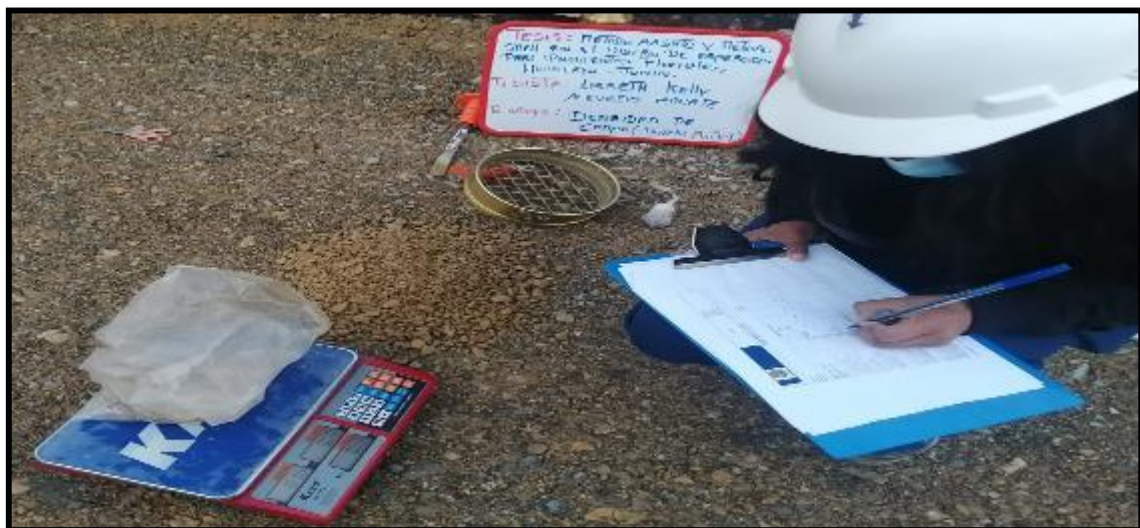
Fotografía N°10: Peso del agregado grueso.
