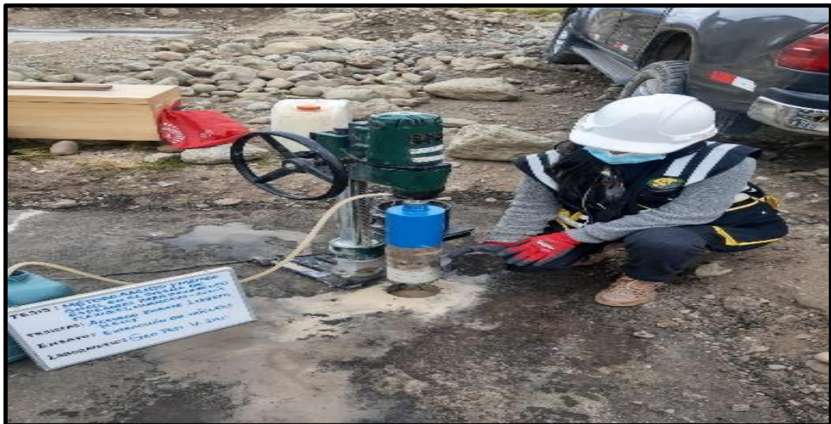
Fotografía N°4: Extracción de núcleos – Método SHELL.
