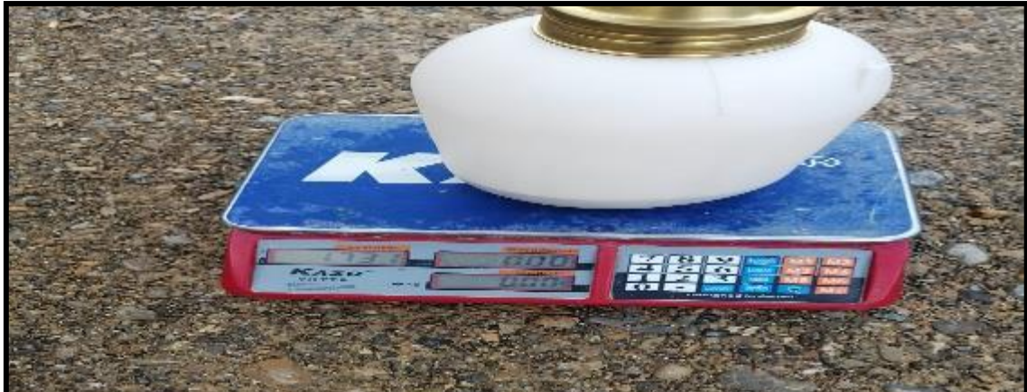
Fotografía N°8: Peso del cono con la arena restante.
