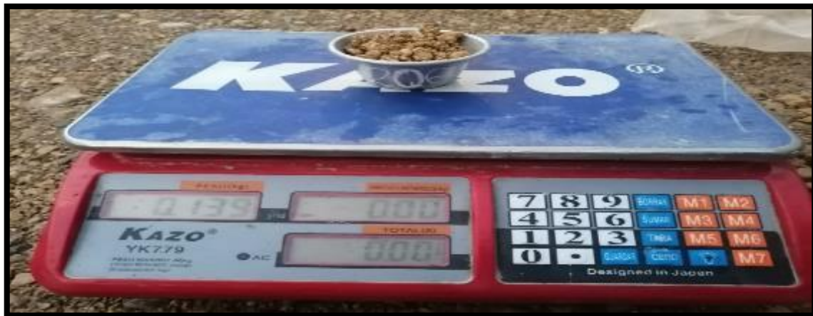
Fotografía N°12: Peso de la tara con el material extraído.
