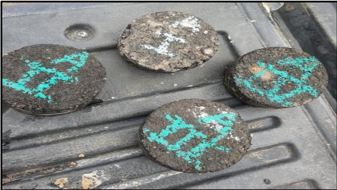
Fotografía N°6: Núcleos extraídos – Método SHELL y Método AASHTO.
