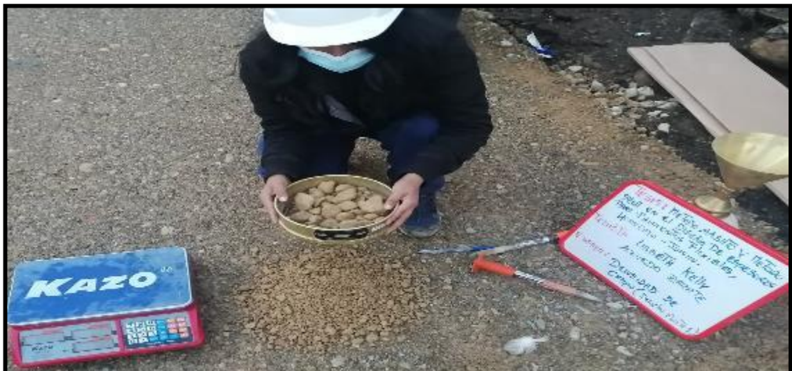
Fotografía N°9: Tamizaje para retener el agregado grueso.
