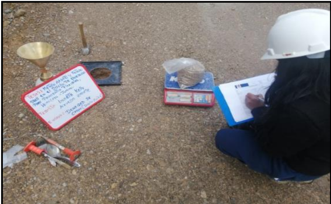
Fotografía N°4: El peso obtenido pasamos a registrarlo en el formato densidad de campo.
