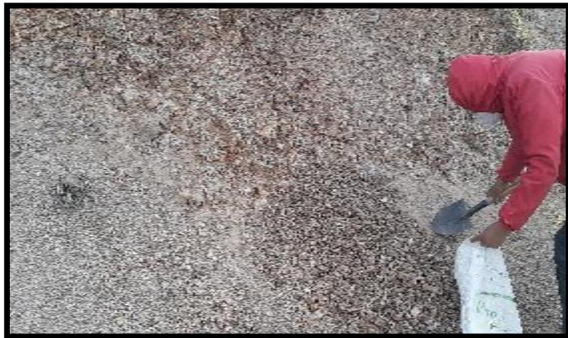
Foto 17 Extracción de muestra de cantera
