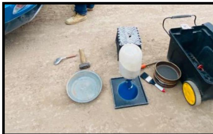
Foto 36 Colocación de arena calibrada
