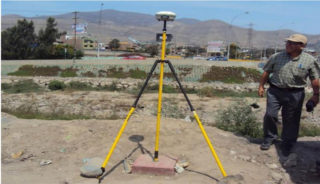
Figuras 15.- Ubicación del BM con el Topógrafo
