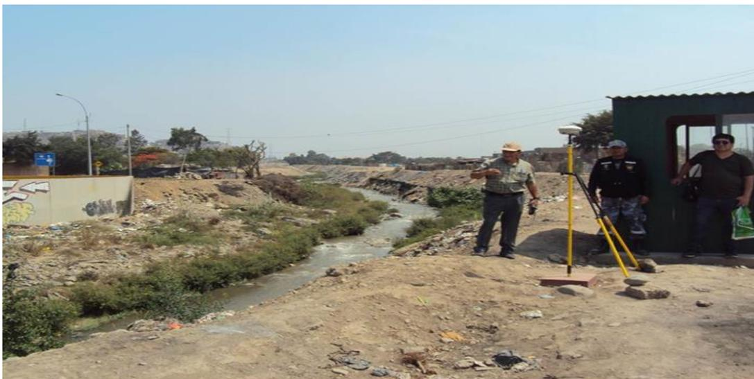
Figuras 16.- Marcación del BM1 sobre el punto de control
