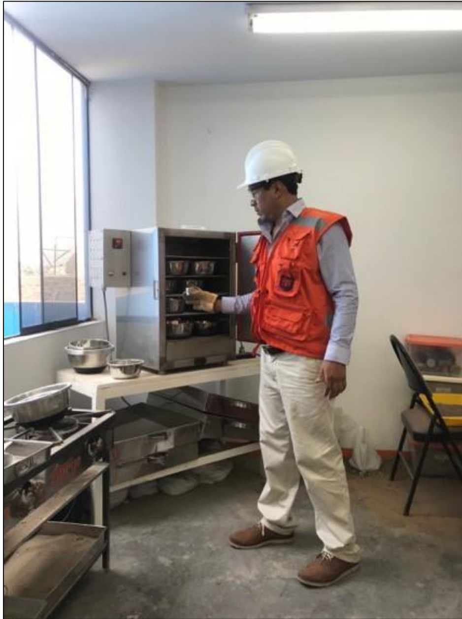
Fotografía N° 02.- determinación contenido de humedad en muestras de suelo; según NTP 339.126-ASTM D2216
