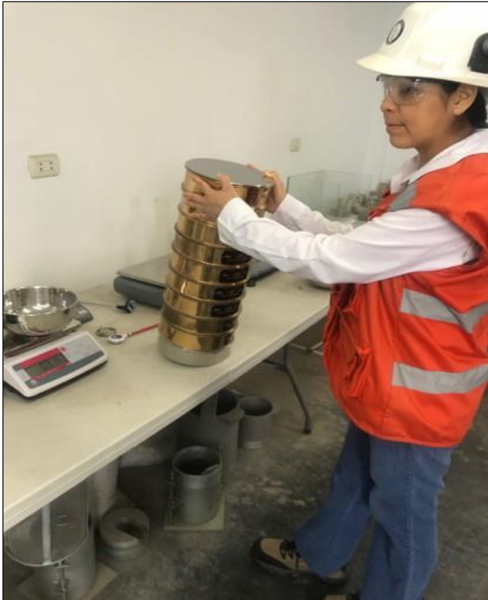
Fotografía N° 01.- realización de tamizado en suelos, según NTP 339.128 - ASTM D422
