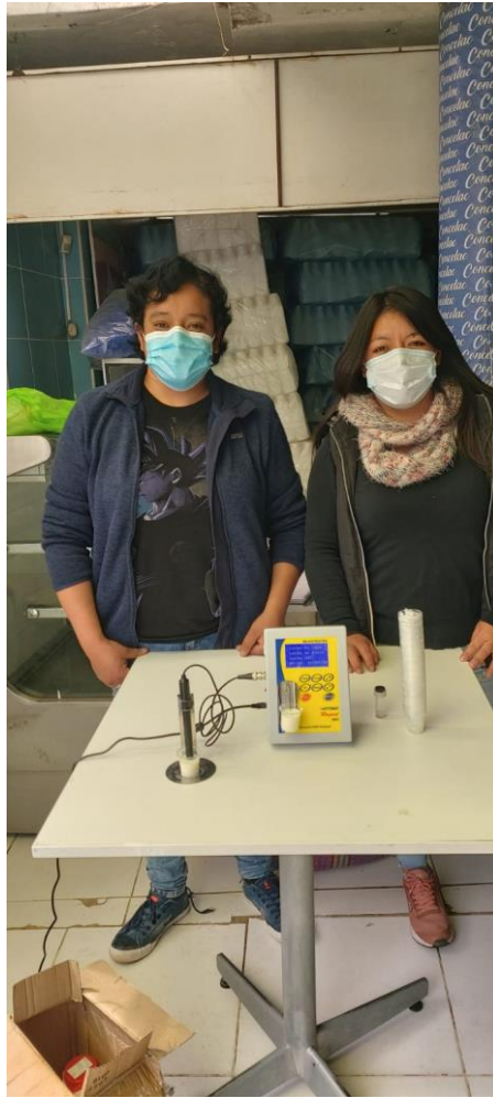
Figura 4: Equipo LACTOSCAM, para el procesamiento de muestras
