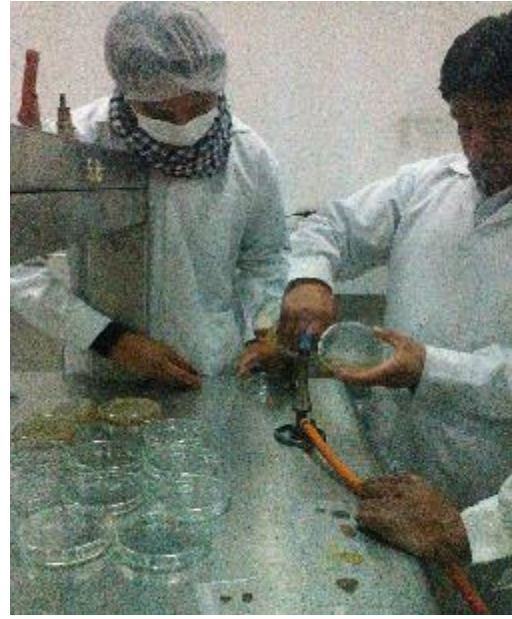
HOMOGENIZANDO LAS MUESTRAS RECOLECTADAS, VERTIENDO EL AGAR EN LAS PLACAS PETRY
