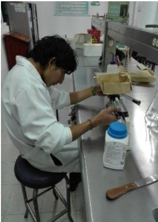
REALIZANDO EL PESAJE EN GRAMOS DEL AGAR SABORAUD DEXTROSA EN POLVO PARA RESTITUIRLO CON AGUA DESTILADA Y CALENTADO EN UNA HORNILLA ELECTRICA PARA LUEGO SER AUTOCLAVADO.
