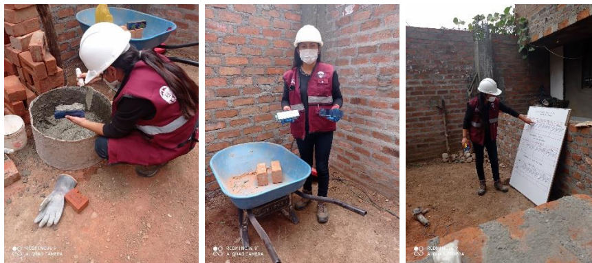
Carretilla, guantes de jebe, balde de 20L, flexómetro, nivel de mano, plancha de batir, pizarra acrílica, moldes para los cubos de mortero.
