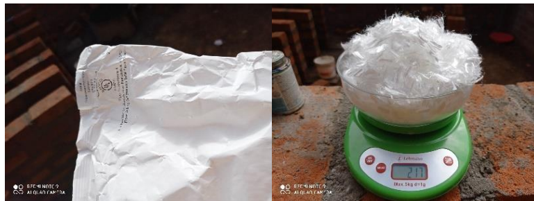
Figura 9: Fibra Sintética de alta tenacidad Fibermesh 150-12mm
