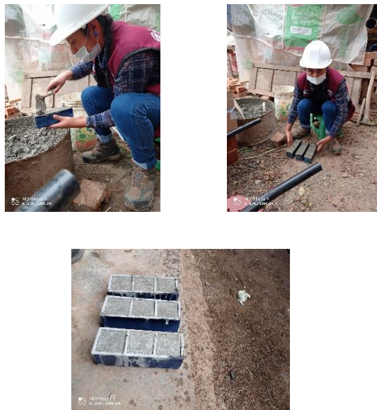
Figura 24: Se observa la elaboración de 09 especímenes de cubos de mortero de 5cm de lado con la incorporación del 100% de fibra sintética
