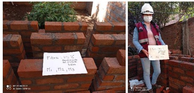
Figura 11: Se observa 09 especímenes de pilas de tres hiladas de ladrillo con la incorporación del 75% de fibra sintética
