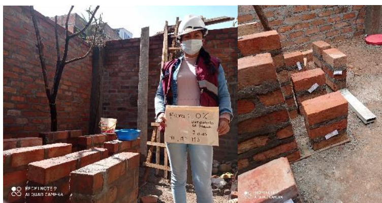
Figura 10: Se observa 09 especímenes de pilas de tres hiladas de ladrillo con la incorporación del 0% de fibra sintética
