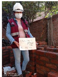
Figura 17: Se observa 09 especímenes de muretes de 0.60m*0.60m con la incorporación del 75% de fibra sintética
