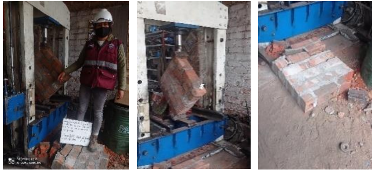
Figura 20: Se observa la rotura de 09 especímenes de muretes de 0.60m*0.60m con la incorporación del 0%,75% y 100% de fibra sintética que se rompieron el 20/03/2021
