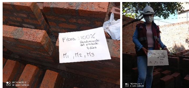
Figura 12: Se observa 09 especímenes de pilas de tres hiladas de ladrillo con la incorporación del 100% de fibra sintética
