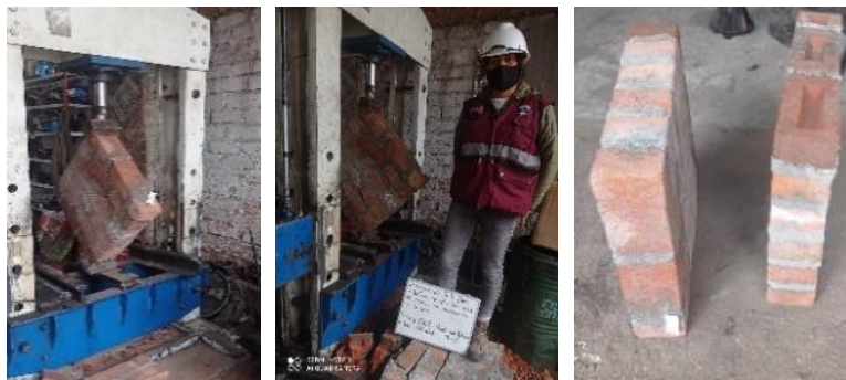
Figura 21: Se observa la rotura de 09 especímenes de muretes de 0.60m*0.60m con la incorporación del 0%,75% y 100% de fibra sintética que se rompieron el 03/04/2021
