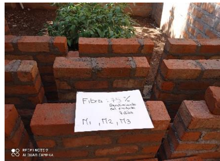
Figura 17: Se observa 09 especímenes de muretes de 0.60m*0.60m con la incorporación del 75% de fibra sintética
