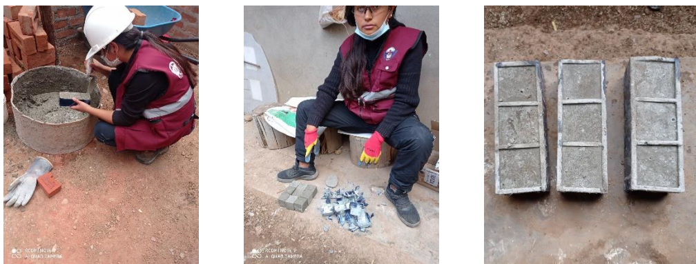
Figura 35: Construcción de cubos de mortero
