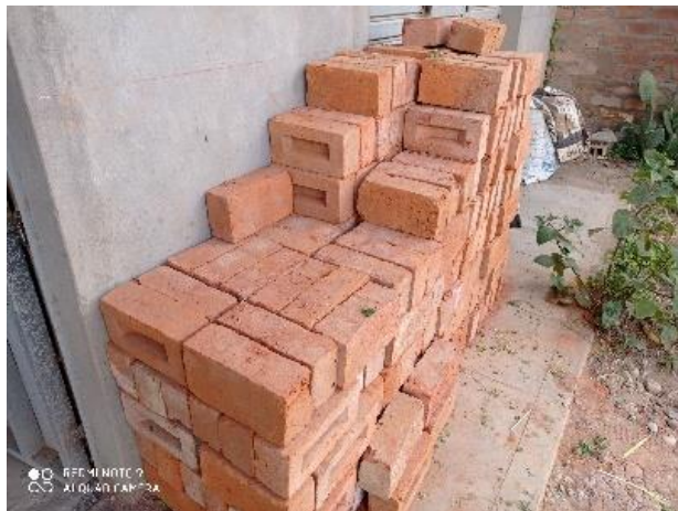
Figura 7: Unidades de Albañilería del tipo artesanal
