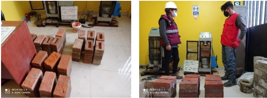
Figura 36: Rotura de pilas
