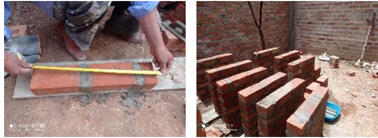
Figura 16: Se observa 09 especímenes de muretes de 0.60m*0.60m con la incorporación del 0% de fibra sintética
