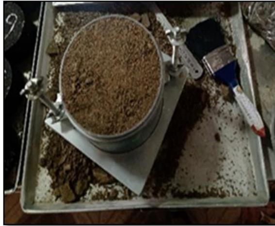
**Fotografía 14:** Enrasamos el molde con una regla metálica quitando previamente el collarín luego retiramos la base y registramos el peso del suelo más el molde.
