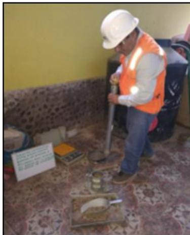
**Fotografía 13:** Se coloca las siguientes capas en el molde y aplicamos 25 golpes como se especifica en la Norma Técnica NTP 339.141.
