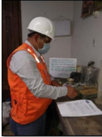
**Fotografía 1:** *Pesado de taras y muestras según la norma NTP:339.127.*
