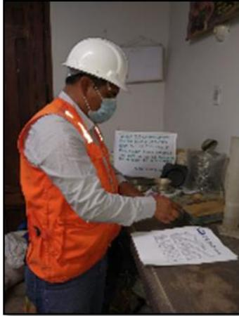
**Fotografía 4:** Pesado tras el secado en la hornilla.
