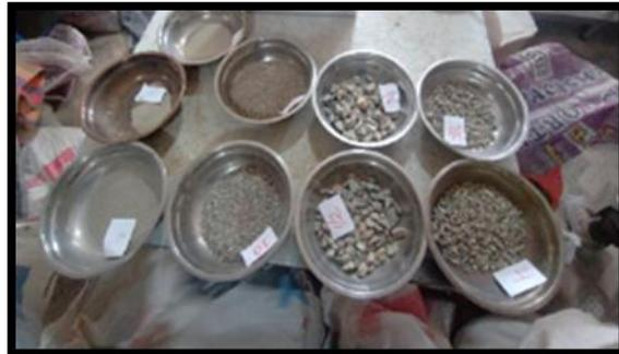
**Fotografía 5:** Ensayo de granulometría del agregado fino y grueso de acuerdo a la NTP 400.012.
