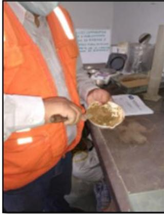
**Fotografía 7:** Una vez que el material no contenga granos que sean retenidos por el tamiz N°40. Se empezó a añadir el agua y con ayuda de una espátula se preparó el material variando su humedad como se especifica en la Norma Técnica NTP 339.129.
