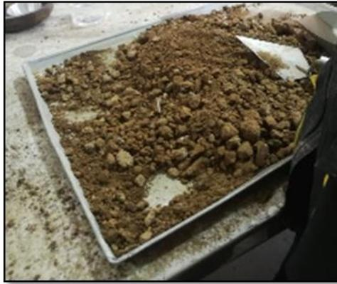
**Fotografía 11:** Se empezó a disgregar los terrones de material y tamizamos a través de las mallas  $\frac{3}{4}$ " para luego agregarle agua.
