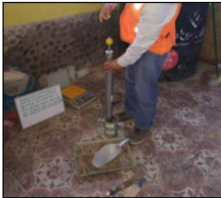
**Fotografía 12:** Se coloca la primera capa en el molde y aplicamos 25 golpes como se especifica en la Norma Técnica NTP 339.141.
