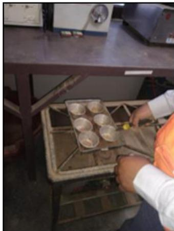
**Fotografía 3:** *Encendido de la hornilla y posterior calentamiento de la muestra para poder eliminar la humedad existente según la norma NTP:339.127.*
