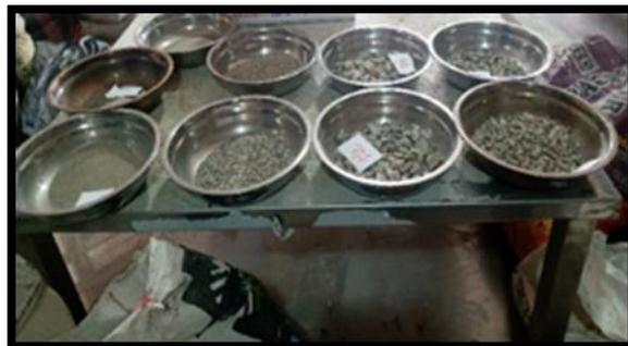
**Fotografía 6:** Ponemos en orden los tamices para tamizar y pesar en porcentaje que queda retenido en los diferentes tamaños de tamices de la cual se obtiene los datos.
