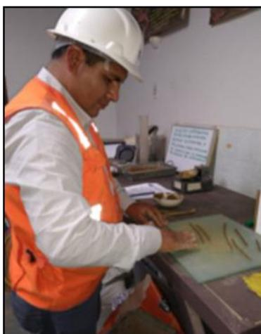
**Fotografía 10:** Hacemos rodar la porción de muestra entre la palma de la mano y vidrio esmerilado, para formar rollos como se especifica en la Norma Técnica NTP 339.129.
