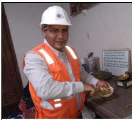
**Fotografía 9:** Se tomó una porción de 15g del ensayo del límite líquido.
