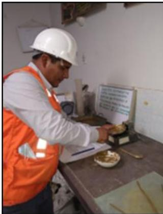
**Fotografía 8:** Ya preparado el material se empezó a colocar una parte de este en la cazuela comprimiendo y extendiendo de arriba hacia abajo para no dejar burbujas de aire y se realizó la ranura lo más uniforme posible como se especifica en la Norma Técnica NTP 339.129
