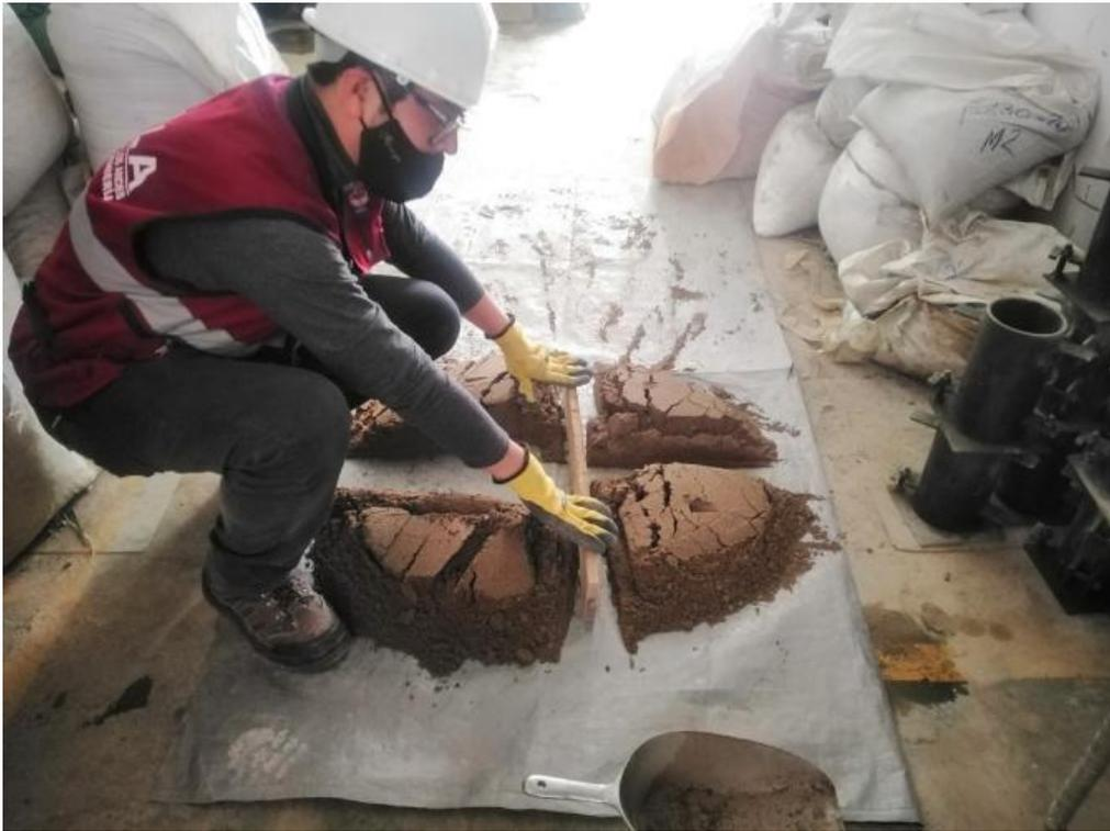
Fotografía 3. Cuarteado de muestras de agregado, por elaboración propia (2021)
