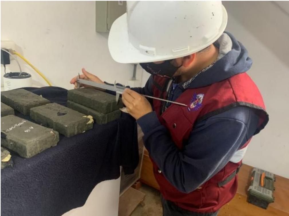
Fotografía 8. Medición de adoquines, por elaboración propia (2021)
