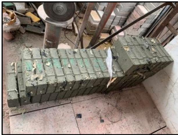
Figura 8 Adoquines con tejido textil, por elaboración propia (2021)
