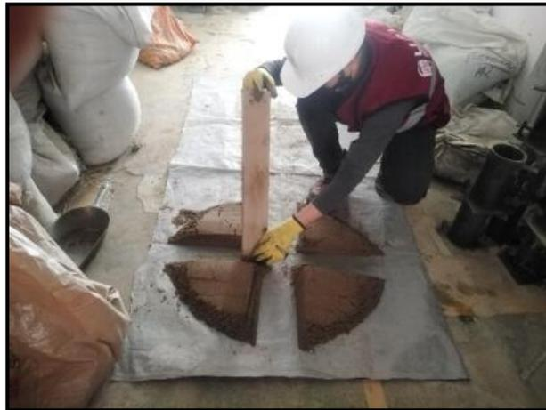
Figura 4 Cuarteo de agregado de cantera de Sicaya por elaboración propia (2021).
