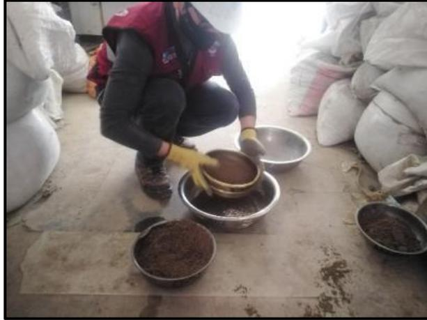
Figura 5. Tamizado de agregado fino por elaboración propia (2021)
