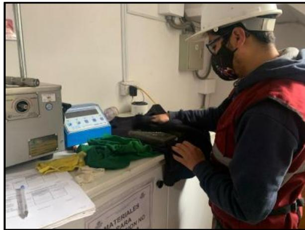
Figura 10 Secado de adoquines, por elaboración propia (2021)
