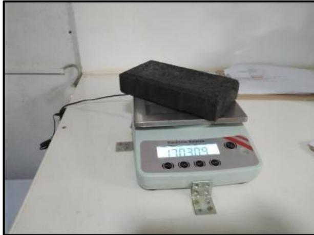
Figura 11 Peso de adoquín saturado, por elaboración propia (2021)
