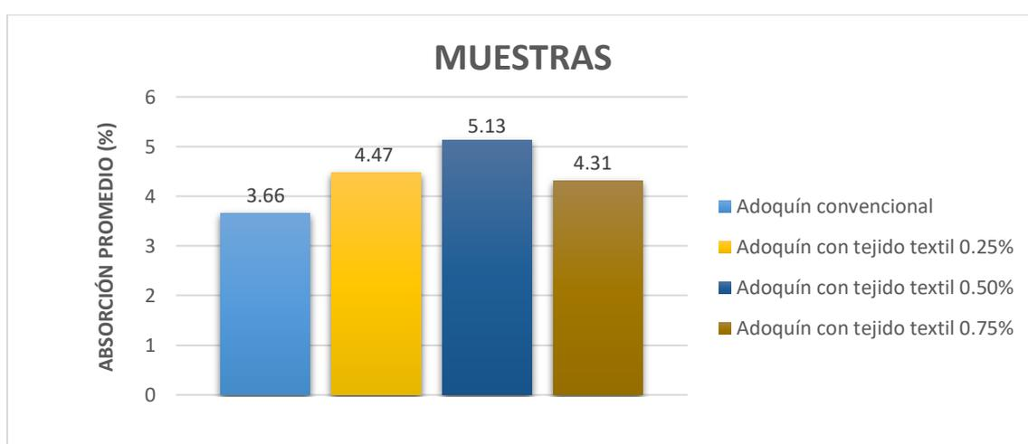
Figura 23. Promedio de absorciones de adoquines con de tejido textil por elaboración propia (2021).
