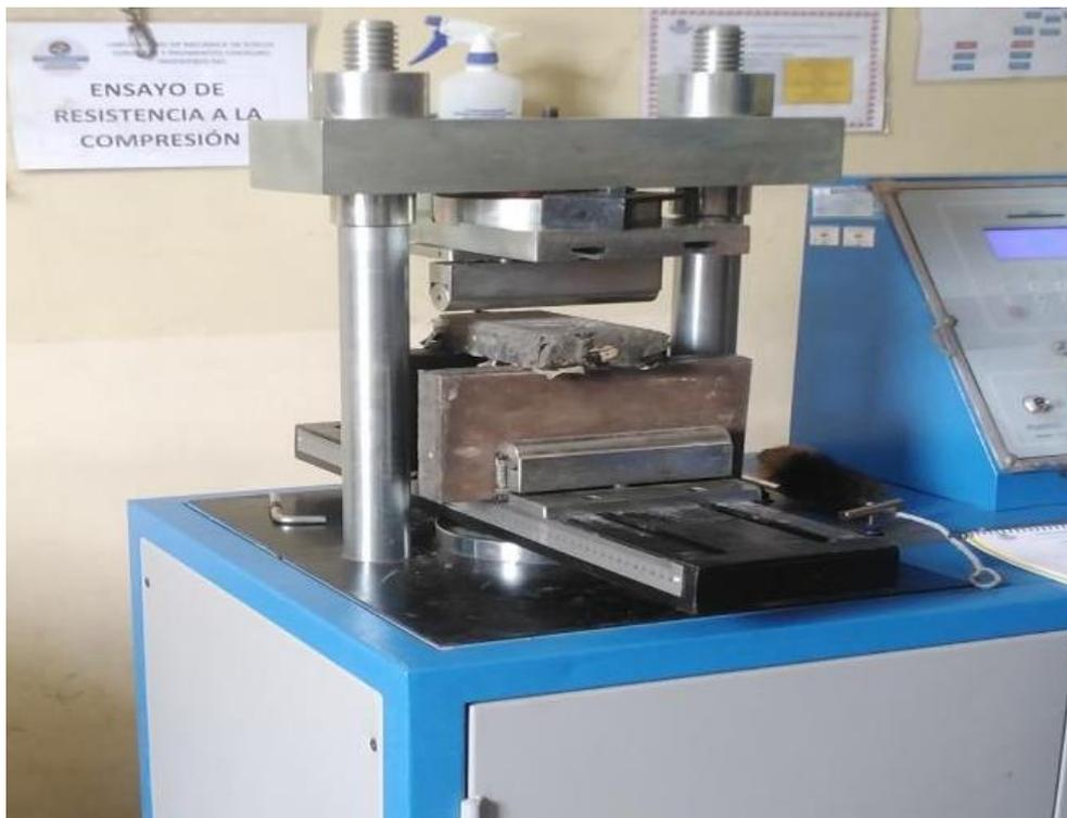
Fotografía 14. Ensayo de esfuerzo a flexión, por elaboración propia (2021)
