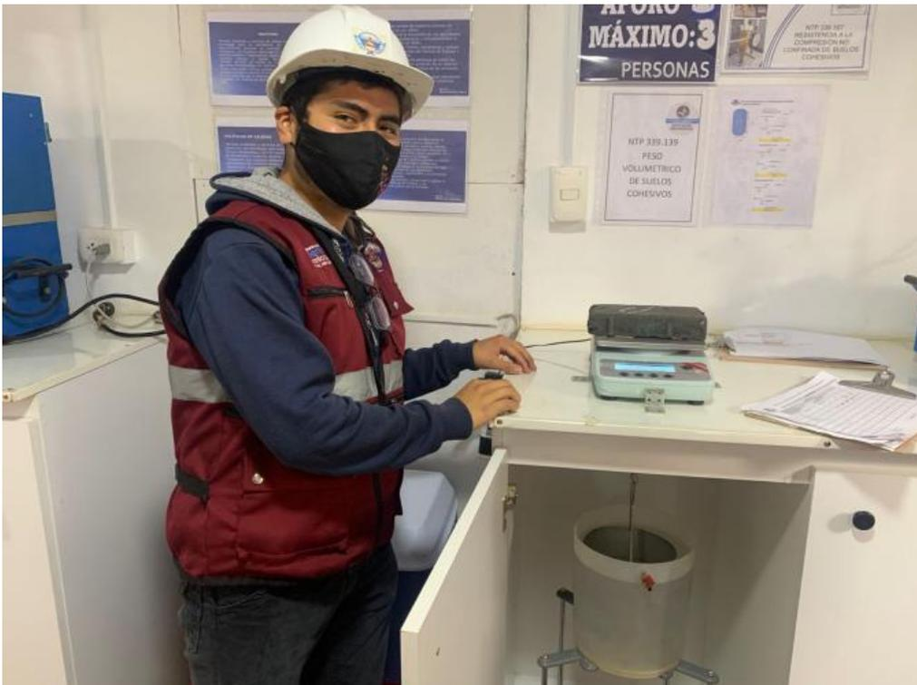
Fotografía 6. Toma de datos de peso de adoquín, por elaboración propia (2021)
