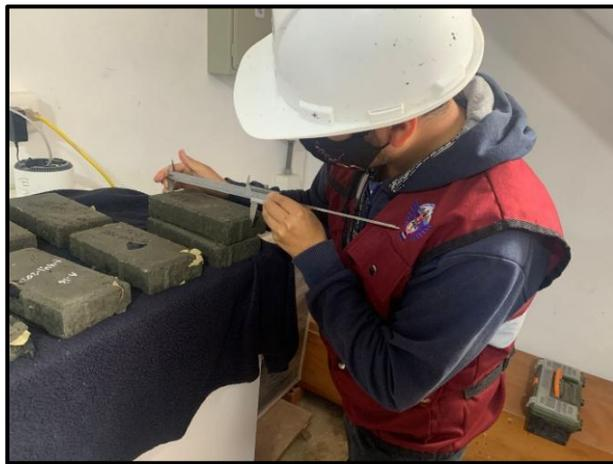
Figura 12 Medición de dimensiones de adoquines, por elaboración propia (2021)
