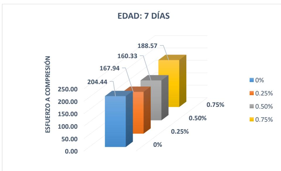
Figura 24: Resultados promedio de esfuerzo a compresión a los 7 días por elaboración propia (2021)
