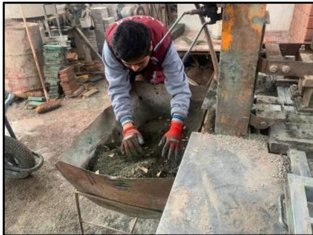
Figura 6 elaboración de adoquines, por elaboración propia (2021)
