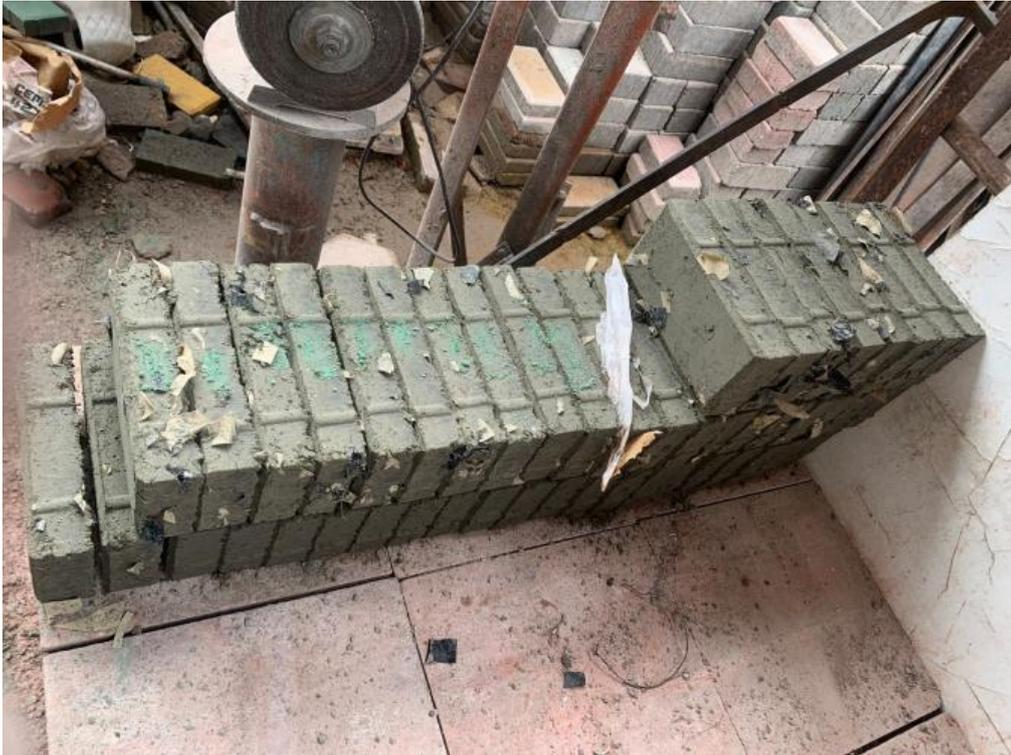
Fotografía 5. Adoquines con reciclado de tejido textil, por elaboración propia (2021)
