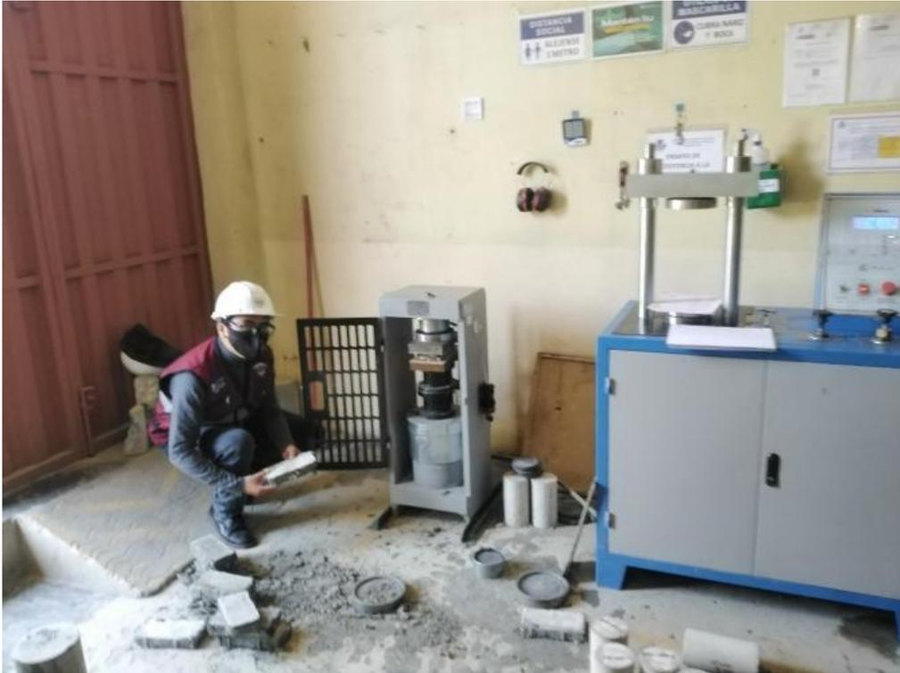
Fotografía 11. Ensayo de esfuerzo a compresión, por elaboración propia (2021)
