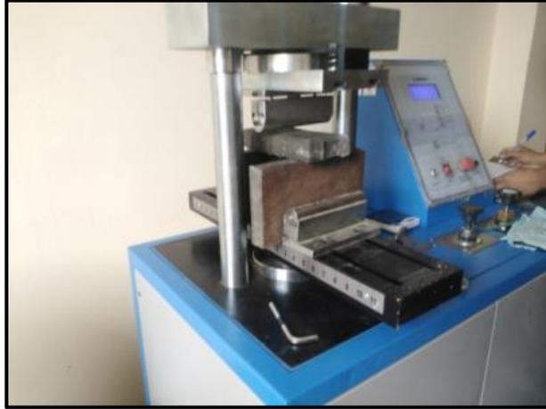
Figura 17 Máquina de ensayo a flexión, por elaboración propia (2021)
