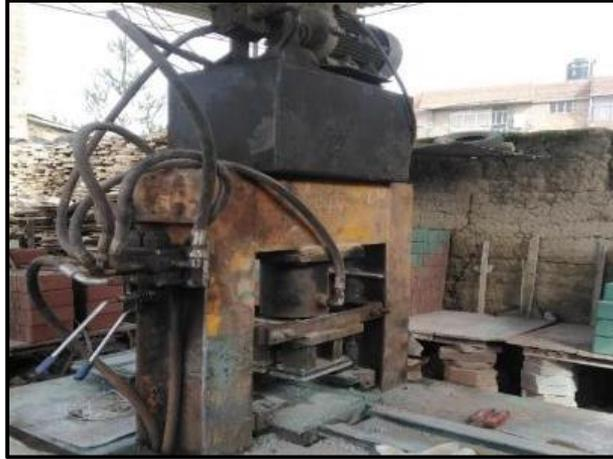
Figura 7 Prensa de adoquines, por elaboración propia (2021)
