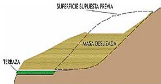
Figura 10: Proceso de un deslizamiento
