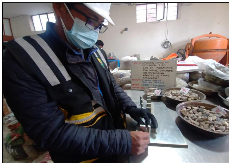
Fotografía N° 8: Desarrollo de Partículas Alargadas: ASTM 4791, NTP 400.4
