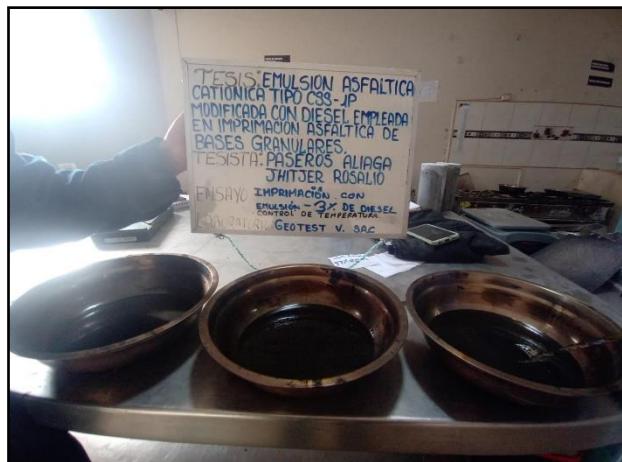
Fotografía N° 12: Imprimación con dosificación de la emulsión y Diesel
