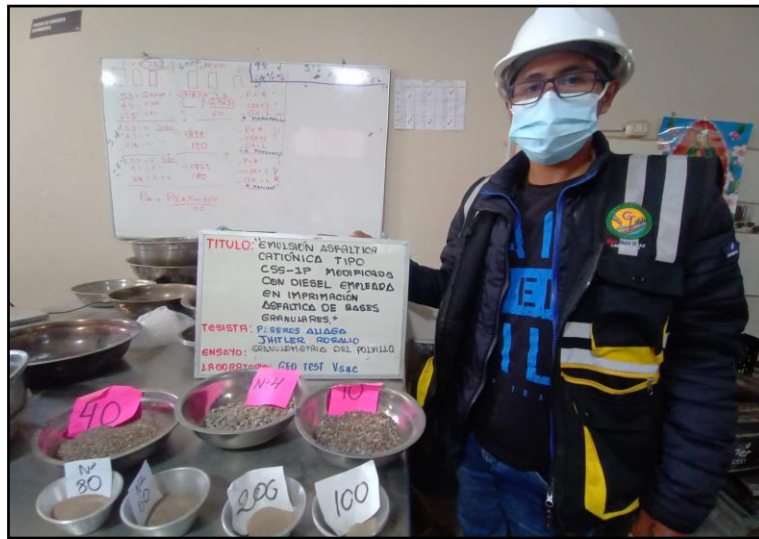
Fotografía N° 2: Ensayo de granulometría de arena natural, para la mezcla asfáltica en caliente (MAC) en la EG-2013, según MTC E-204, ASTM D-422
