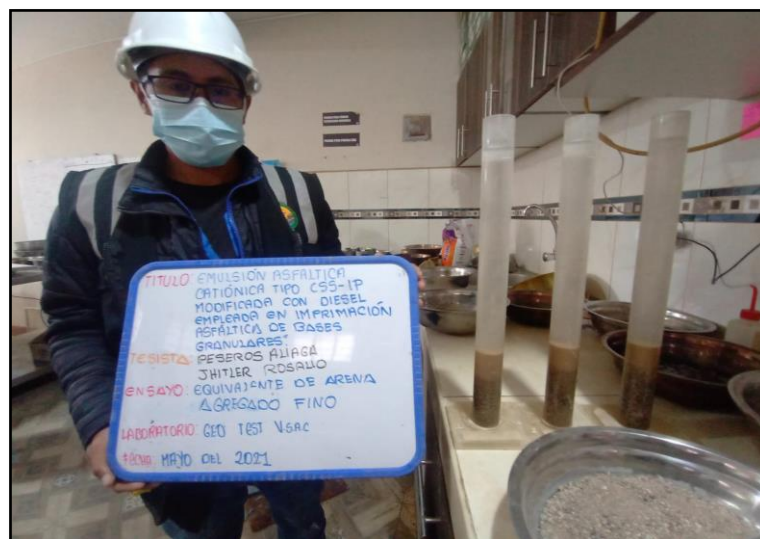
Fotografía N° 6: Del desarrollo de Ensayo Equivalente de Arena Triturada MTC E-114, NTP 339.146
