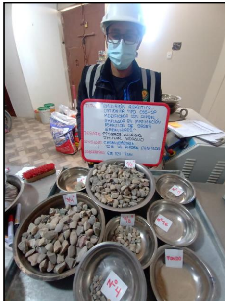
Fotografía N° 4: Desarrollo del ensayo de Abrasión Los Ángeles (Método B- 11 esferas) MTC E-207, NTP 400.019
