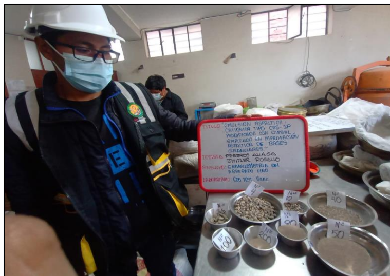
Fotografía N° 2: Ensayo de granulometría de arena natural, para la mezcla asfáltica en caliente (MAC) en la EG-2013, según MTC E-204, ASTM D-422
