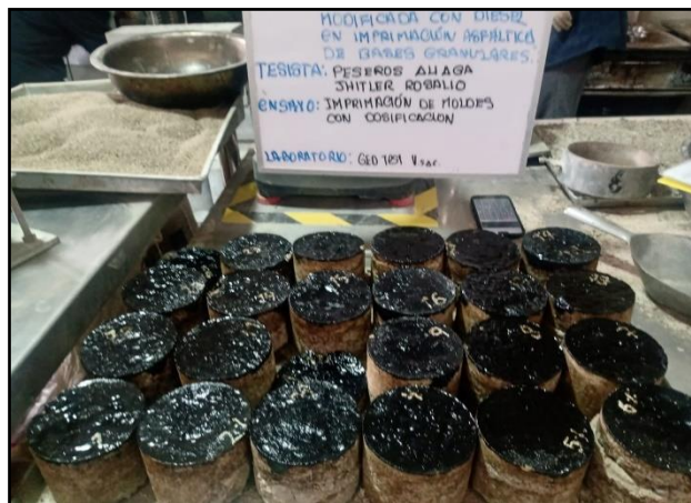
Fotografía N° 14: Imprimación de 24 moldes a distintas temperaturas y distintas dosificaciones
