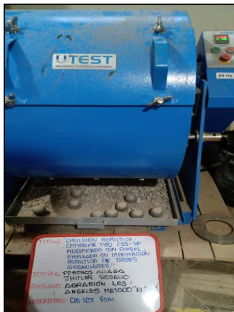
Fotografía N° 4: Desarrollo del ensayo de Abrasión Los Ángeles (Método B- 11 esferas) MTC E-207, NTP 400.019
