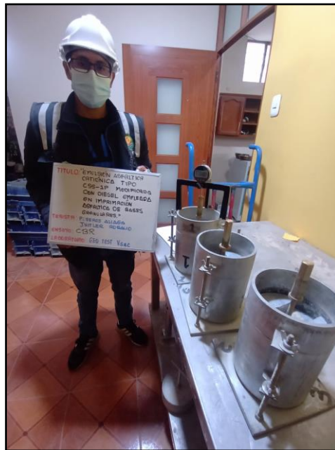
Fotografía N° 14: Imprimación de 24 moldes a distintas temperaturas y distintas dosificaciones
