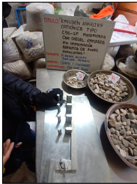
Fotografía N° 8: Desarrollo de Partículas Alargadas: ASTM 4791, NTP 400.4
