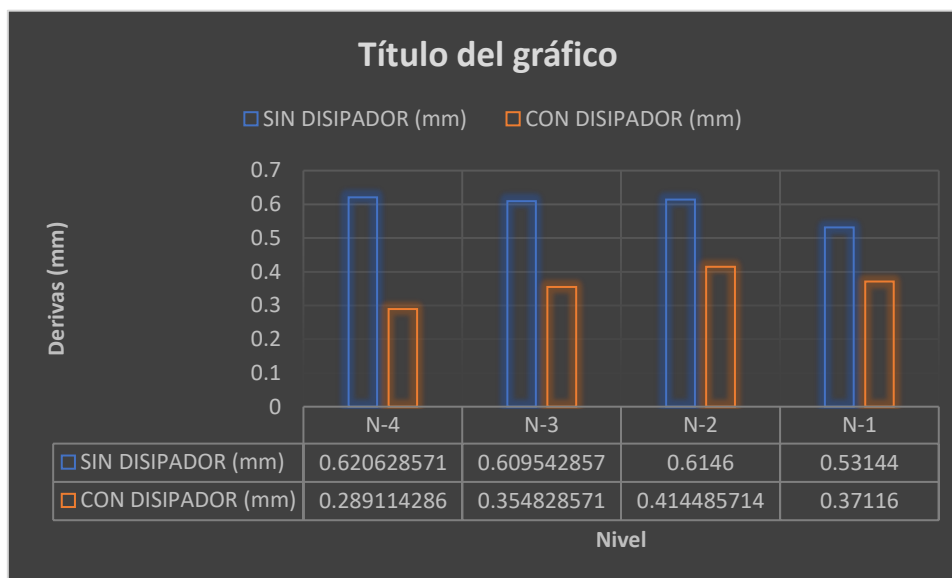
Figura 40. Comparativo con y sin disipadores sísmicos
