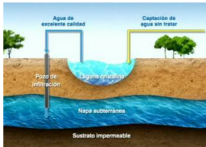
Figura 8 Tipos de captación de agua “Hidrología General” curso virtual (2015) [digital]. Recuperado de http://.eduvirtual/RecursosHidricos/.org/? /pág./22.
