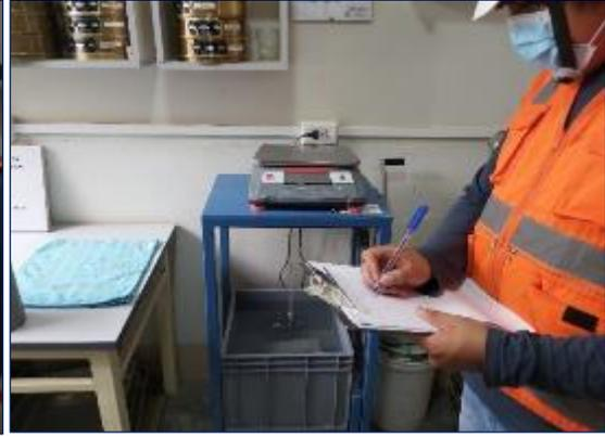
Fotografía 52. Densidad del concreto endurecido mezclado durante 30 segundos, según la ASTM C39.
