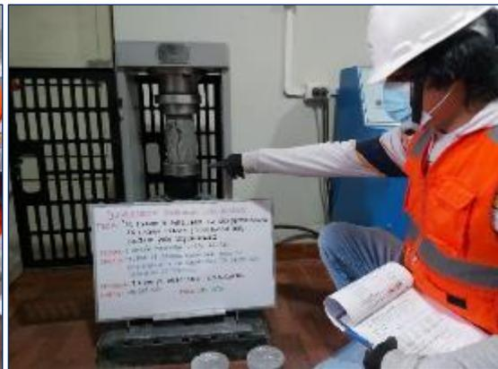
Fotografía 51. Ensayo de resistencia a compresión a los 28 días de probetas mezcladas durante 150 segundos.
