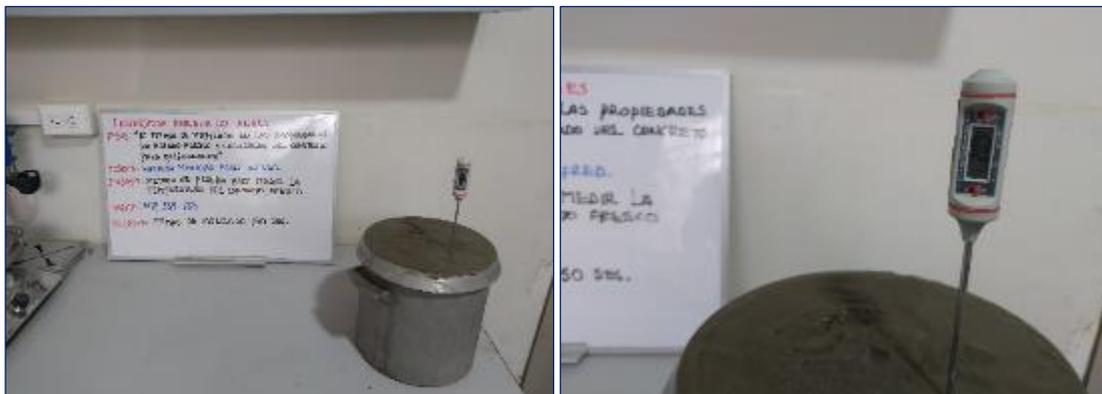
Fotografía 32. Medición de la temperatura del concreto mezclado durante 120 segundos según la ASTM C1064.
