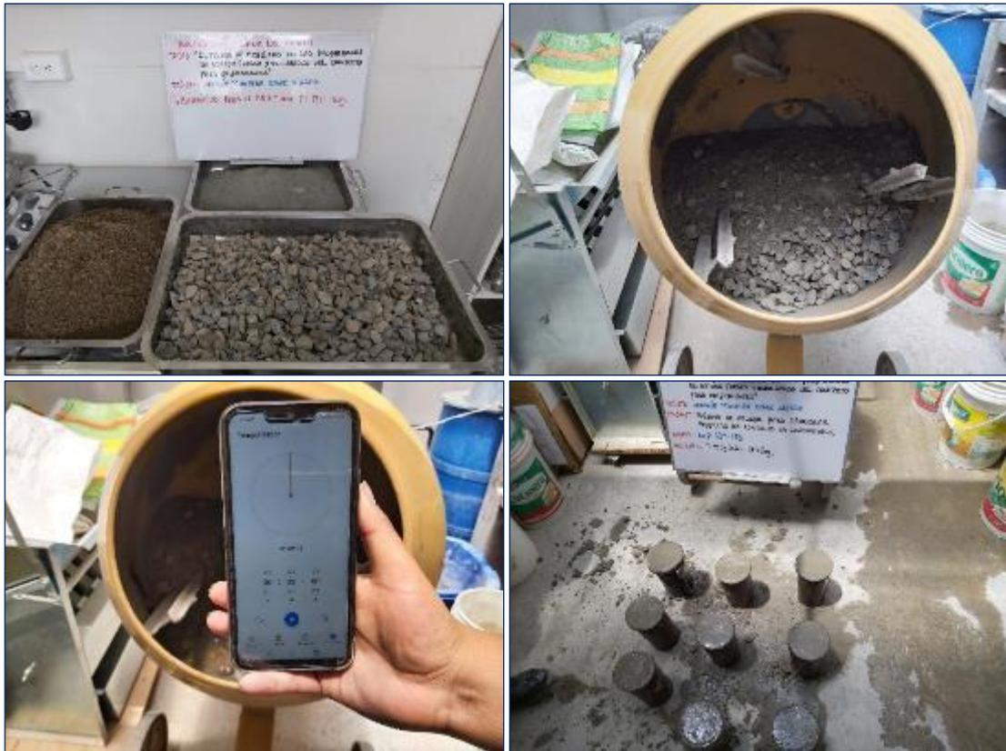
Fotografía 26. Elaboración del concreto con tiempo de mezclado de 120 segundos.
