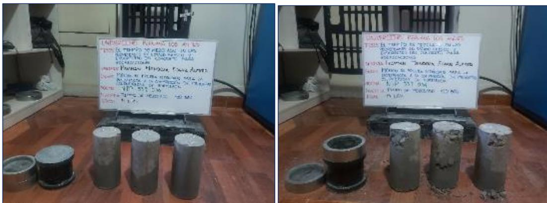
Fotografía 45. Ensayo de resistencia a compresión a los 14 días de probetas mezcladas durante 120 segundos.
