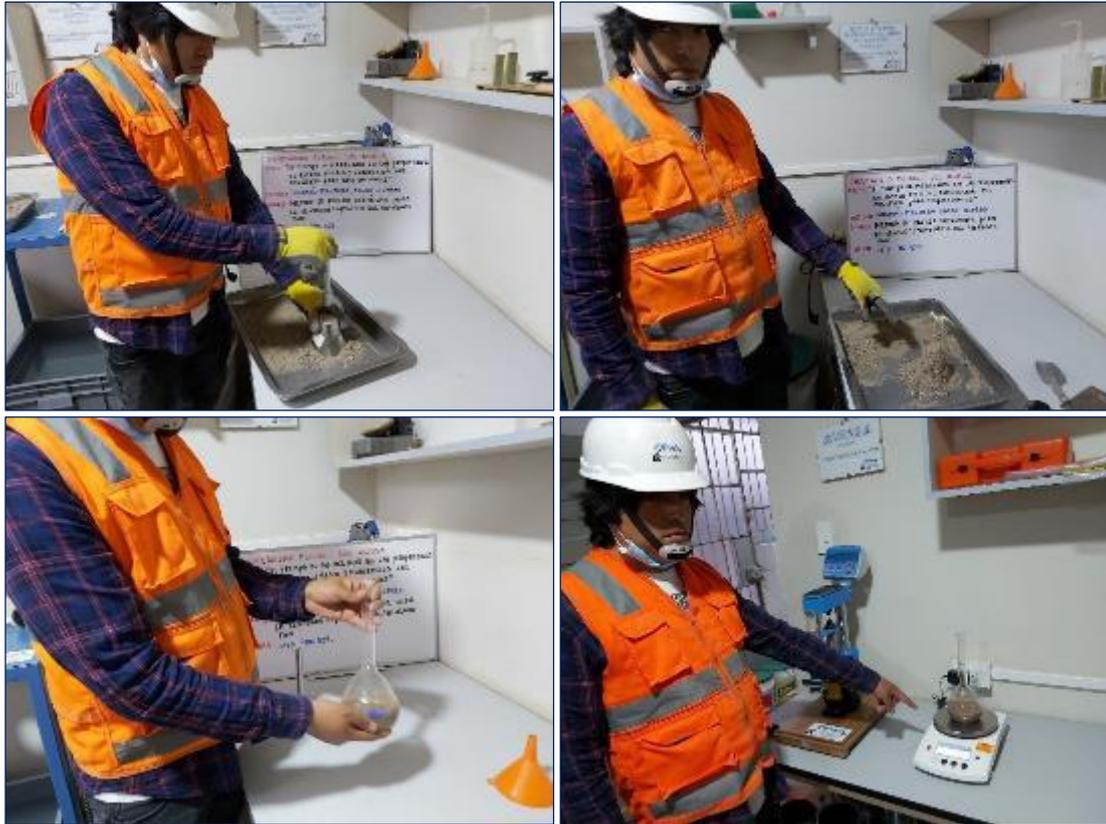
Fotografía 9. Ejecución del ensayo para determinar densidad, densidad relativa y absorción de los agregados finos según la ASTM C128-15.
