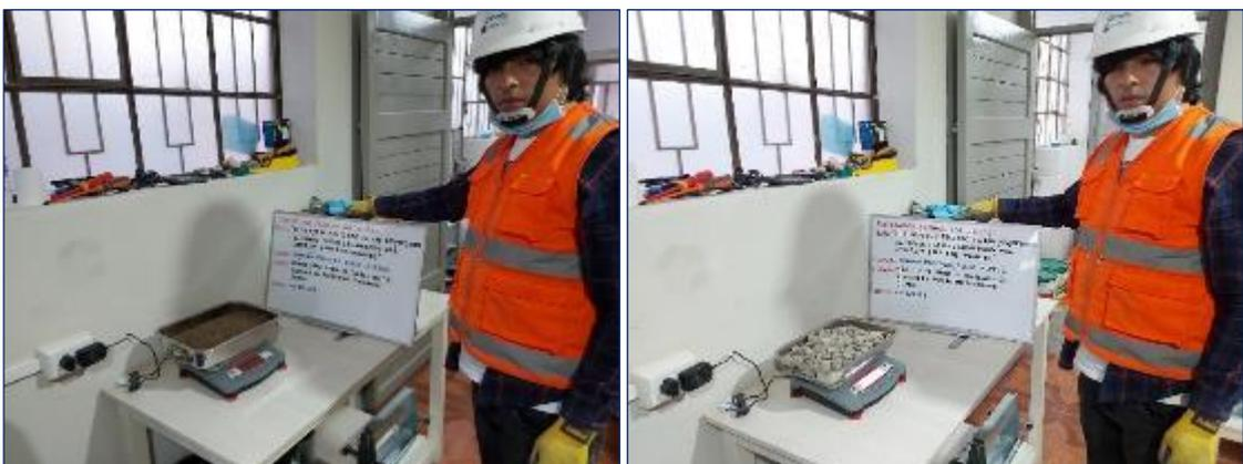
Fotografía 3. Vista de la ejecución del ensayo para determinar el contenido de humedad de los agregados según la ASTM C566-97(2004).
