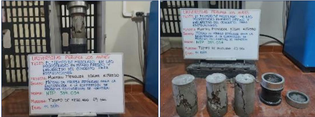
Fotografía 43. Ensayo de resistencia a compresión a los 14 días de probetas mezcladas durante 45 segundos.
