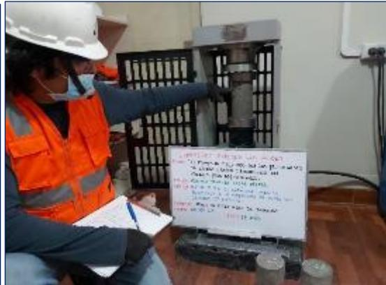
Fotografía 47. Ensayo de resistencia a compresión a los 28 días de probetas mezcladas durante 30 segundos.
