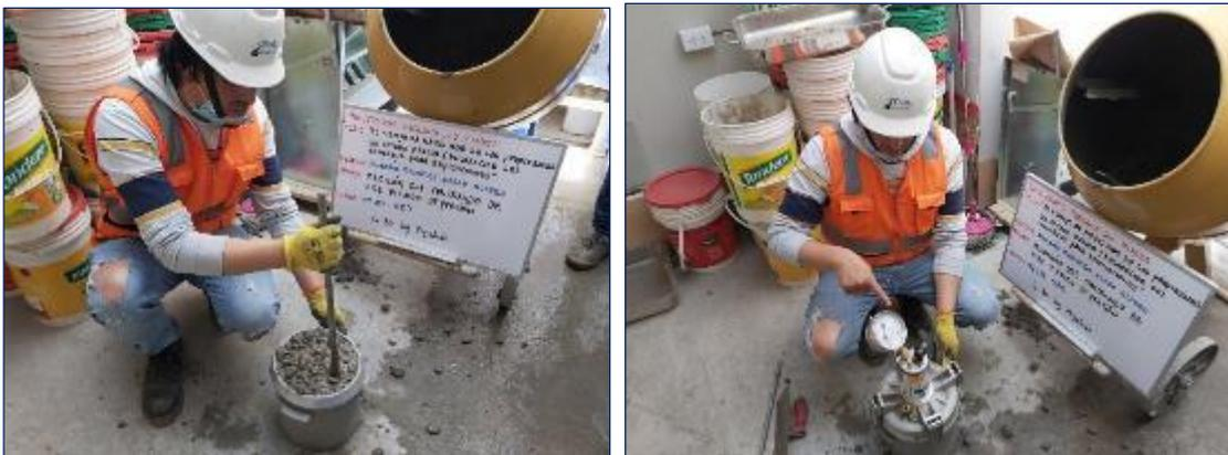
Fotografía 15. Medición del contenido de aire del concreto mezclado durante 30 segundos según la ASTM C231.
