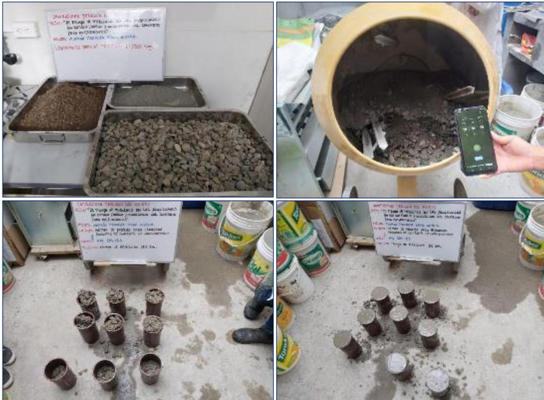
Fotografía 31. Elaboración del concreto con un tiempo de mezclado de 150 segundos.
