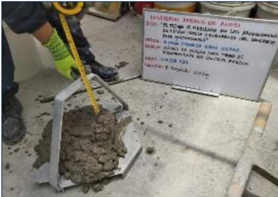
Fotografía 29. Medición del asentamiento del concreto mezclado durante 120 segundos según la ASTM C143.
