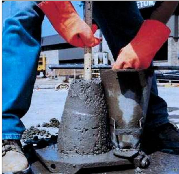
Figura 2. Medición de la consistencia del concreto.
