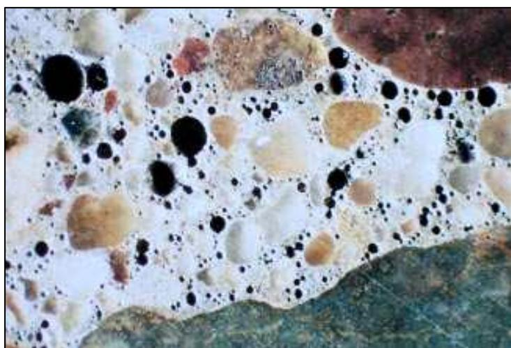
Figura 5. Aire incluido en el concreto.
