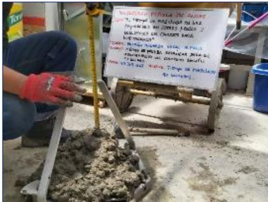
Fotografía 24. Medición del asentamiento del concreto mezclado durante 90 segundos según la ASTM C143.
