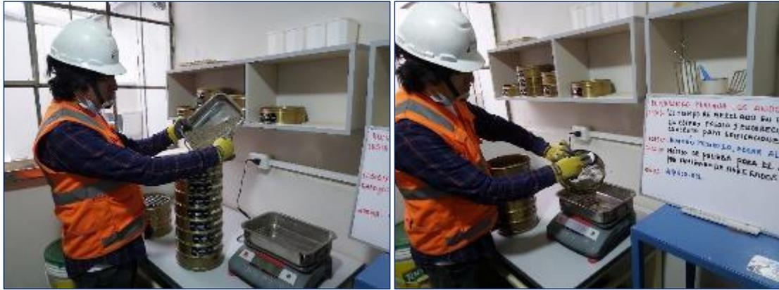
Fotografía 4. Ejecución del tamizado de los agregados finos según la norma ASTM C136.
