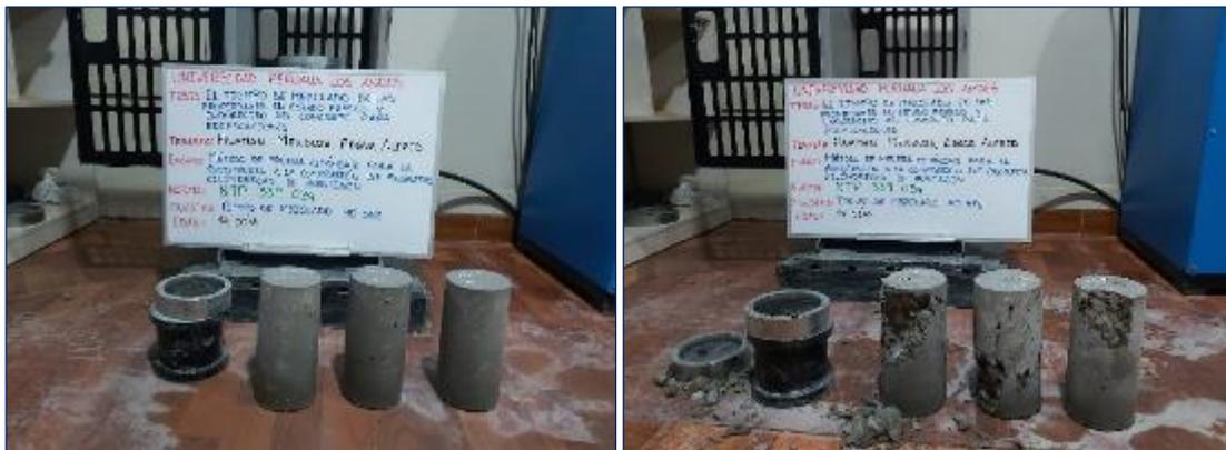
Fotografía 44. Ensayo de resistencia a compresión a los 14 días de probetas mezcladas durante 90 segundos.
