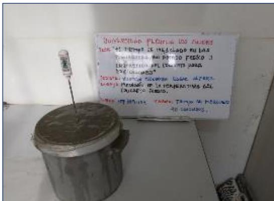
Fotografía 22. Medición de la temperatura del concreto mezclado durante 90 segundos según la ASTM C1064.
