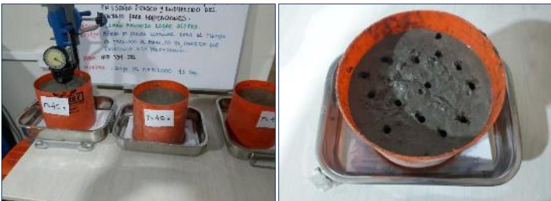
Fotografía 18. Medición del tiempo de fraguado del concreto mezclado durante 45 segundos según la ASTM C403.
