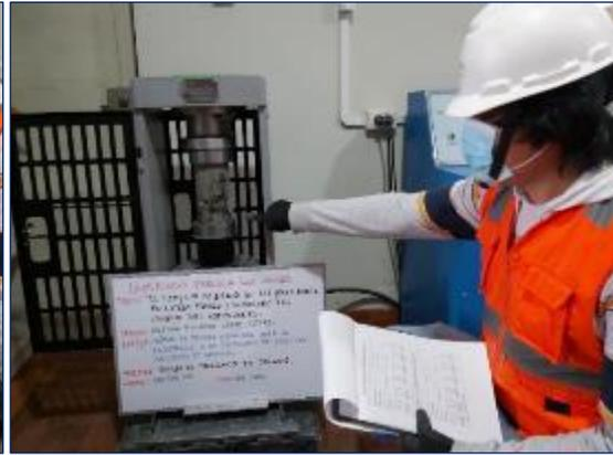
Fotografía 49. Ensayo de resistencia a compresión a los 28 días de probetas mezcladas durante 90 segundos.
