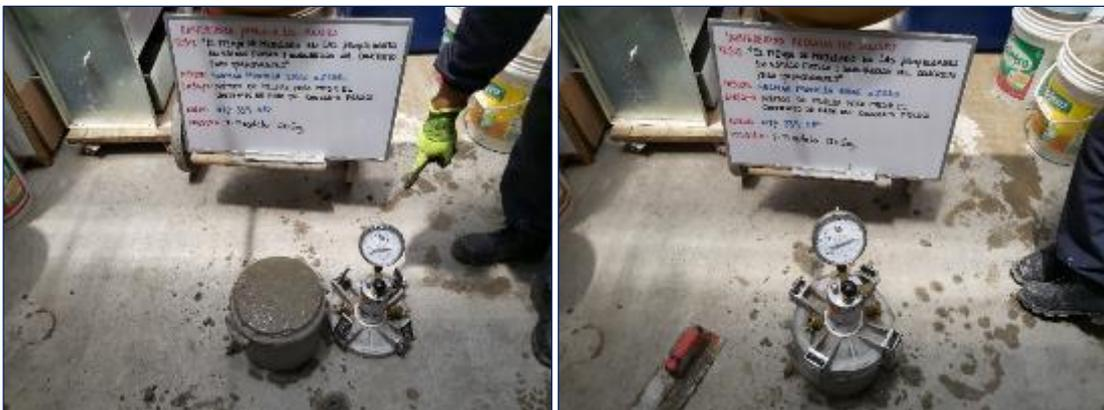
Fotografía 30. Medición del contenido de aire del concreto mezclado durante 120 segundos según la ASTM C231.
