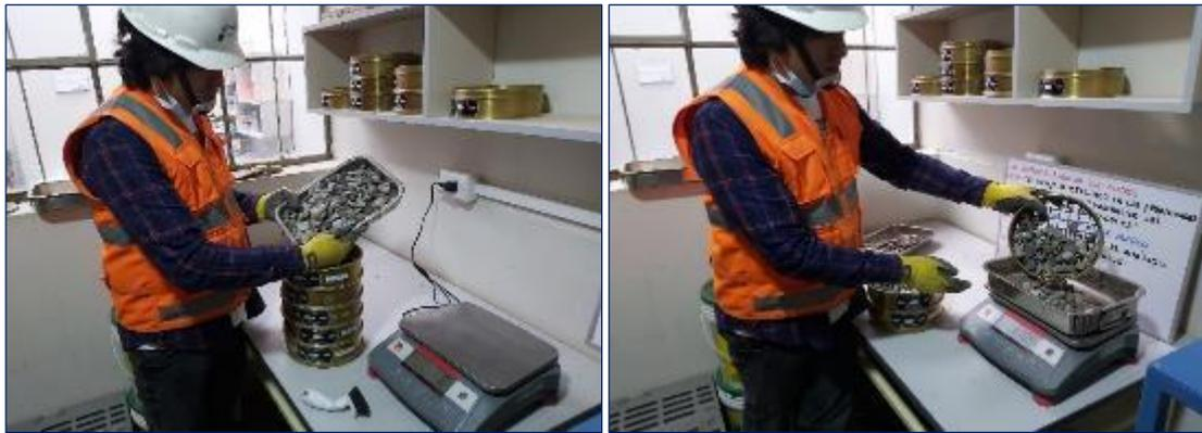
Fotografía 5. Ejecución del tamizado de los agregados gruesos según la norma ASTM C136.
