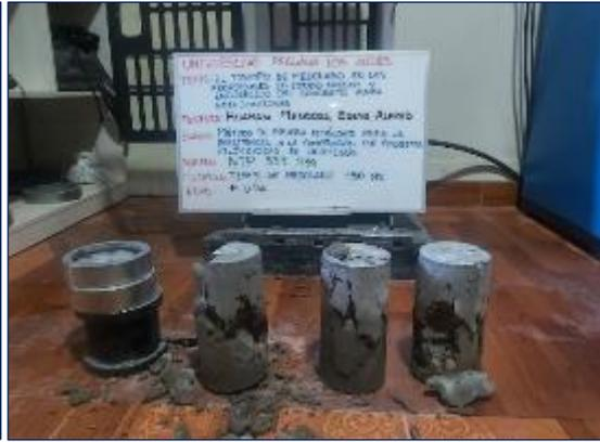
Fotografía 46. Ensayo de resistencia a compresión a los 14 días de probetas mezcladas durante 150 segundos.
