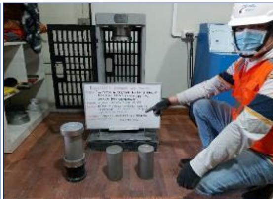
Fotografía 48. Ensayo de resistencia a compresión a los 28 días de probetas mezcladas durante 45 segundos.
