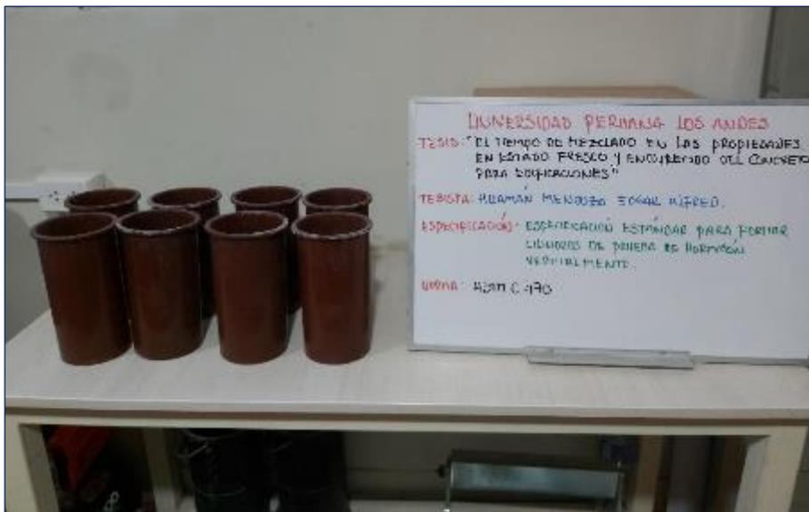
Fotografía 10. Vista de los moldes para la elaboración de cilindros de concreto según la norma ASTM C470.
