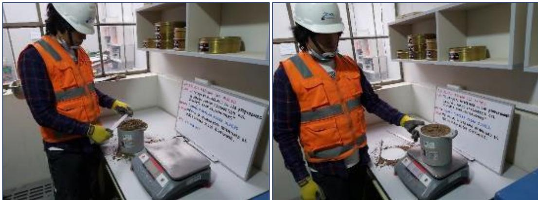
Fotografía 6. Ejecución del ensayo para determinar el peso unitario e índice de vacíos en los agregados finos según la ASTM C29.
