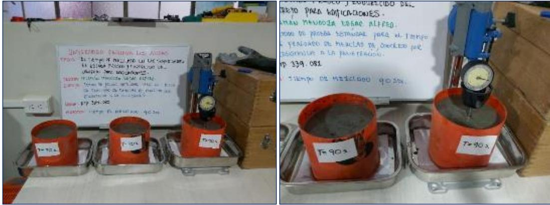
Fotografía 23. Medición del tiempo de fraguado del concreto mezclado durante 90 segundos según la ASTM C403.
