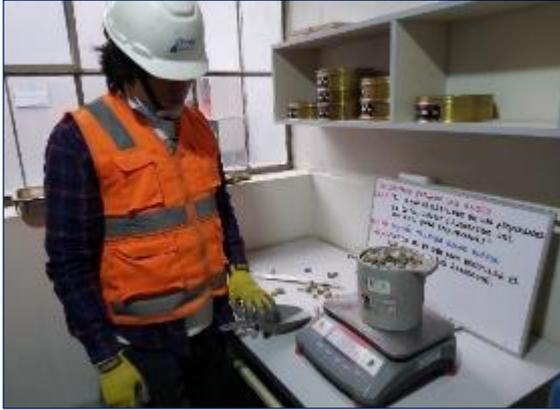
Fotografía 7. Ejecución del ensayo para determinar el peso unitario e índice de vacíos en los agregados gruesos según la ASTM C29.
