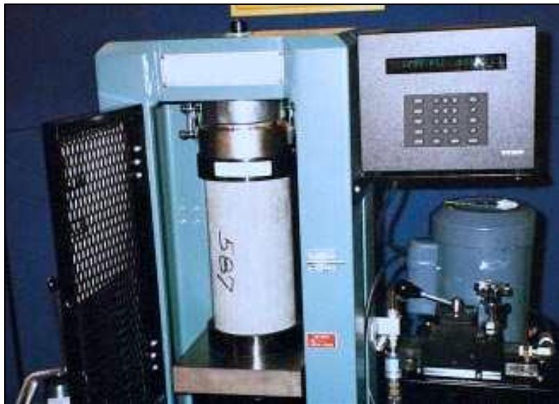
Figura 6. Ensayo de resistencia a compresión del concreto.
