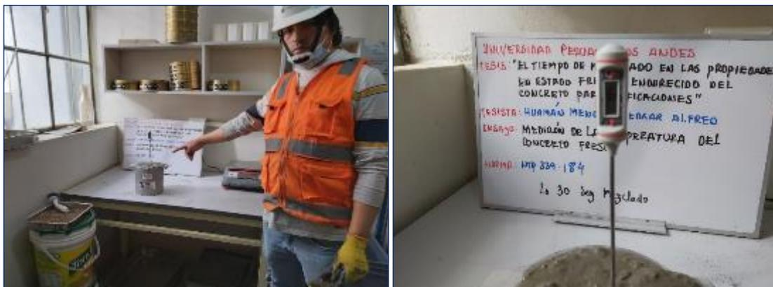
Fotografía 12. Medición de la temperatura del concreto mezclado durante 30 segundos de acuerdo a la ASTM C1064.
