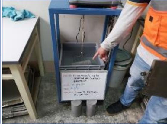
Fotografía 55. Densidad del concreto endurecido mezclado durante 120 segundos, según la ASTM C39.
