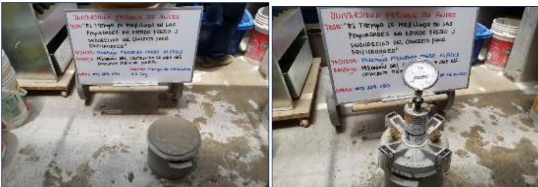
Fotografía 20. Medición del contenido de aire del concreto mezclado durante 45 segundos según la ASTM C231.
