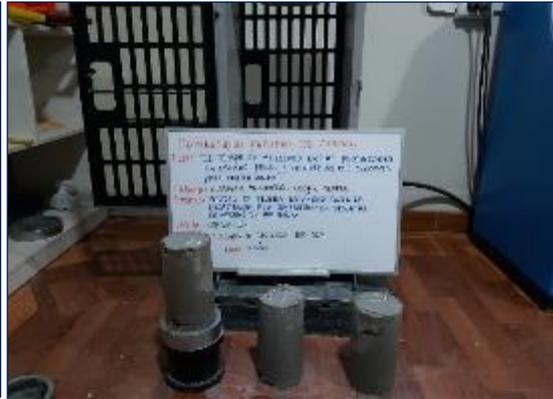
Fotografía 40. Ensayo de resistencia a compresión a los 7 días de probetas mezcladas durante 120 segundos.
