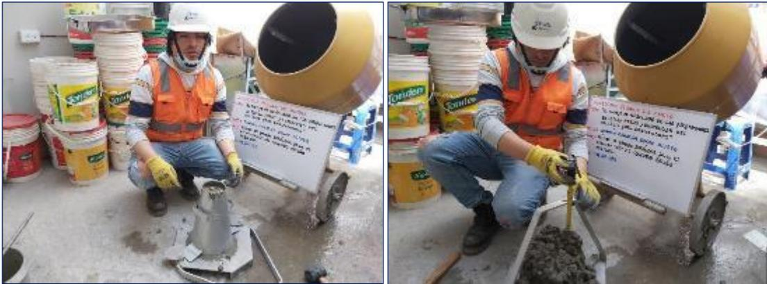
Fotografía 14. Medición del asentamiento de concreto mezclado durante 30 segundos según la ASTM C143.
