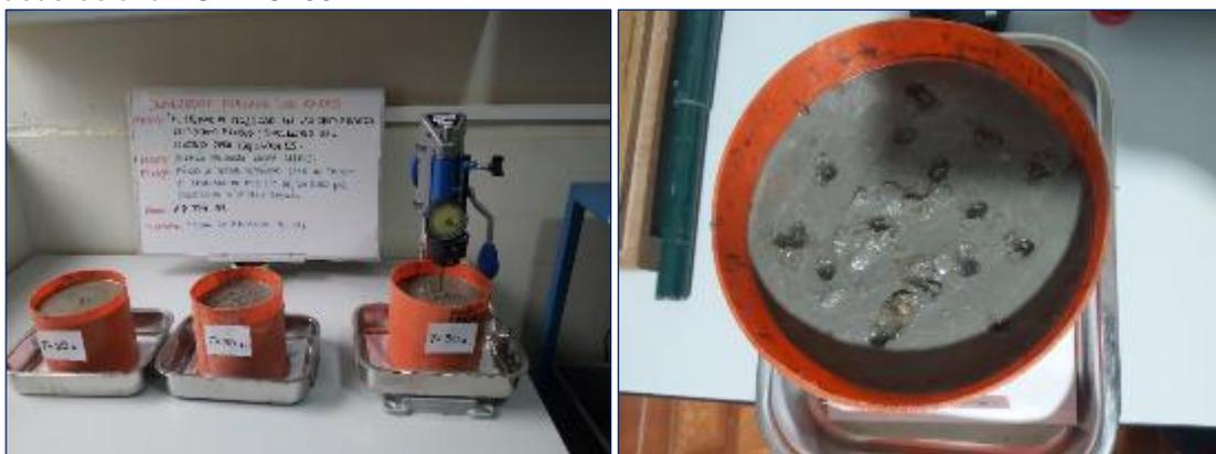
Fotografía 13. Medición del tiempo de fraguado del concreto mezclado durante 30 segundos según la ASTM C403.
