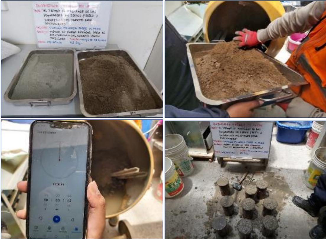
Fotografía 16. Elaboración del concreto con 45 segundos de tiempo de mezclado.
