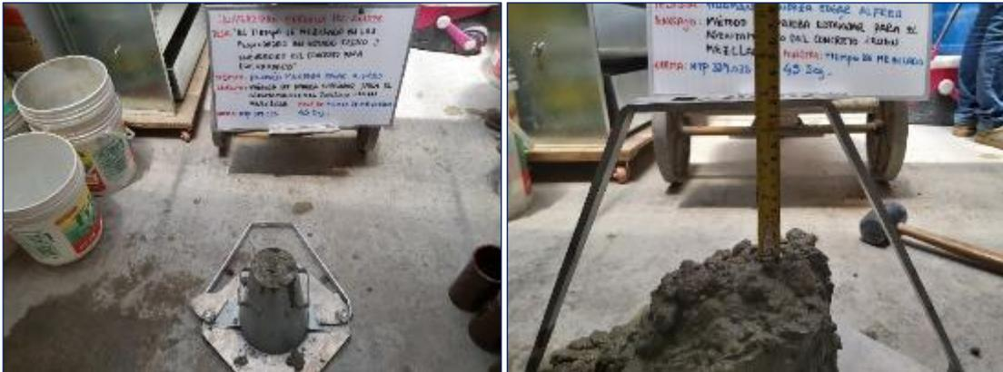
Fotografía 19. Medición del asentamiento del concreto mezclado durante 45 segundos según la ASTM C143.
