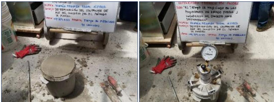
Fotografía 25. Medición del contenido de aire del concreto mezclado durante 90 segundos según la ASTM C231.
