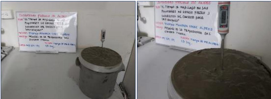
Fotografía 17. Medición de la temperatura del concreto mezclado durante 45 segundos según la ASTM C1064.
