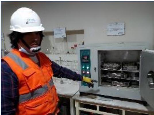
Fotografía 8. Ejecución del ensayo para determinar densidad, densidad relativa y absorción de los agregados finos según la ASTM C128-15.
