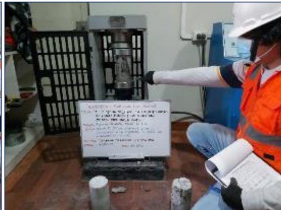
Fotografía 50. Ensayo de resistencia a compresión a los 28 días de probetas mezcladas durante 120 segundos.
