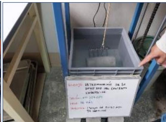
Fotografía 54. Densidad del concreto endurecido mezclado durante 90 segundos, según la ASTM C39.
