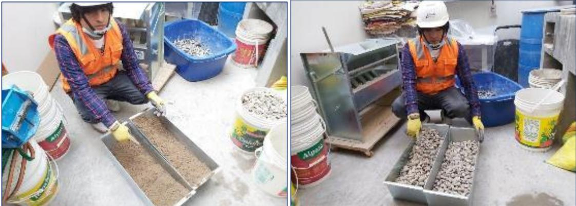
Fotografía 2. Vista del cuarteo de los agregados para la obtención de muestras representativas según la ASTM C702.
