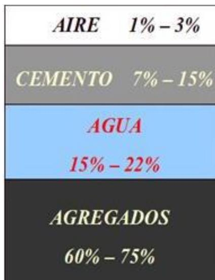
Figura 1. Proporciones típicas que se encuentran en el concreto.
