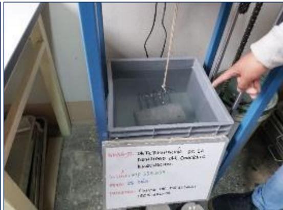
Fotografía 56. Densidad del concreto endurecido mezclado durante 150 segundos, según la ASTM C39.
