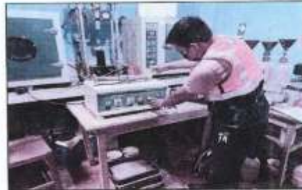
FOTO Nº 02: SE OBSERVA AL PERSONAL TECNICO CONTINUANDO CON EL ENSAYO DE EQUIVALENTE DE ARENA
