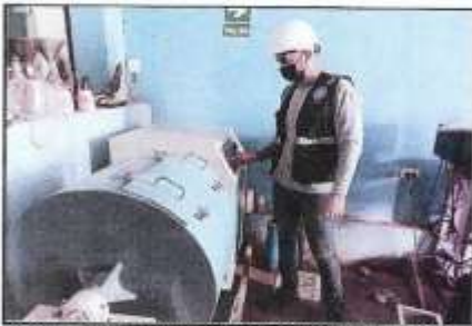
FOTO Nº 03: SE OBSERVA AL PERSONAL TECNICO CONTINUANDO CON EL ENSAYO DE ABRASION LOS ANGELES.
