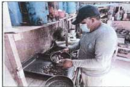
FOTO Nº 03: SE OBSERVA AL PERSONAL TECNICO CONTINUANDO CON EL ENSAYO DE GRANULOMETRIA
