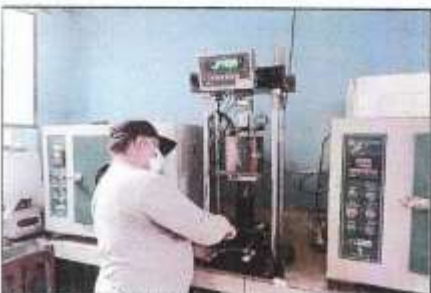
FOTO N° 05: SE OBSERVA LA VISTA PANORAMICA DEL ENSAYO DE CBR.
