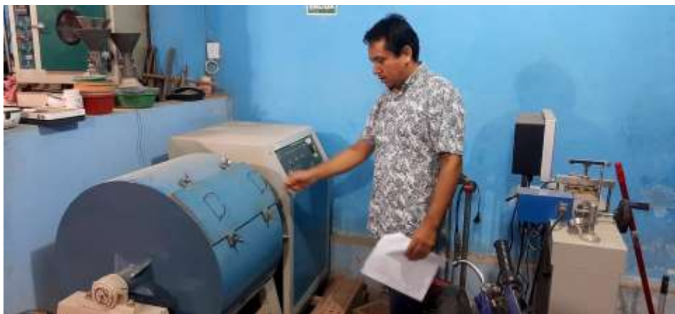
Figura N° 10: Abrasión Los Ángeles en laboratorio
