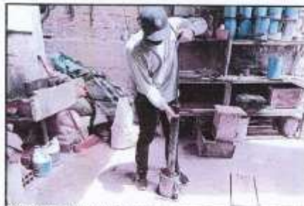
FOTO N° 02: SE OBSERVA AL PERSONAL TECNICO COMPACTANDO LA MUESTRA PARA EL ENSAYO DE CBR.
