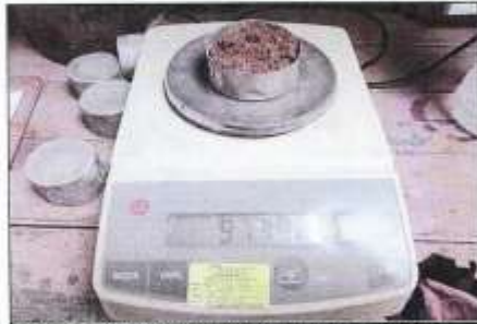
FOTO Nº 03: SE OBSERVA AL PERSONAL TECNICO PENSANDO LA MUESTRA PARA EL ENSAYO DE PROCTOR MODIFICADO
