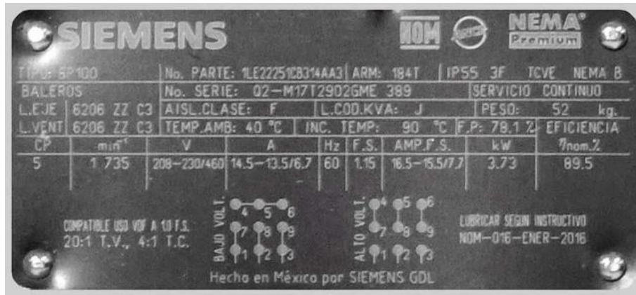
Figura 44. Placa informativa del motor de 5 hp Fuente: SIEMENS, motor trifásico 5HP Web
