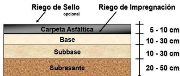
Figura 1 Capas del pavimento flexible asfáltico.
