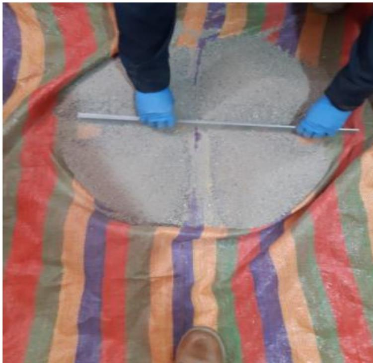
Se observa en la fotografía el agregado (arena gruesa) siendo partido en cuatro proporciones iguales para ser pesado, tamizado y realiza la caracterización.
