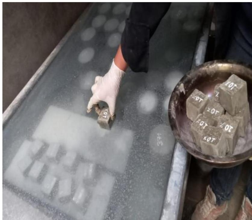
Se observa en la fotografía las probetas del diseño de mortero de 10% con adición de vidrio molido en el pozo de agua para curado.
