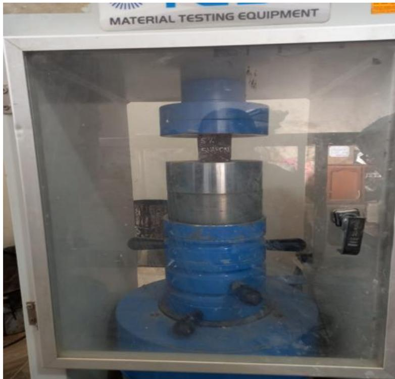
Se observa en la fotografía el proceso del ensayo a COMPRESION SIMPLE del 5% de la probeta del mortero con adición del 5% de vidrio molido.
