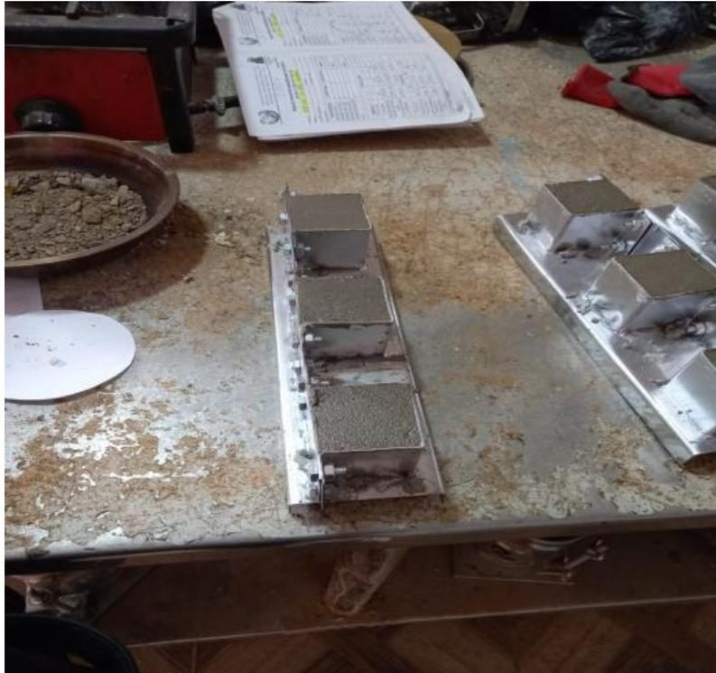
Se observa en la fotografia la probetas del diseño de mortero de 5% con adición de vidrio molido al día siguiente de haber sido realizado.
