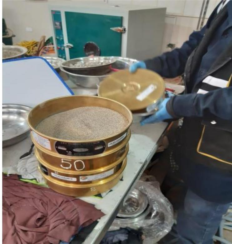
Se observa en la fotografía el agregado (arena gruesa) en el proceso de tamizado desde el tamiz 14 al 200 para realizar la caracterización.
