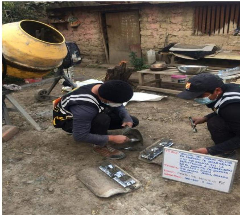
Se observa en la fotografía el proceso de mezcla de diseño de mortero de 5% con adición de vidrio molido.
