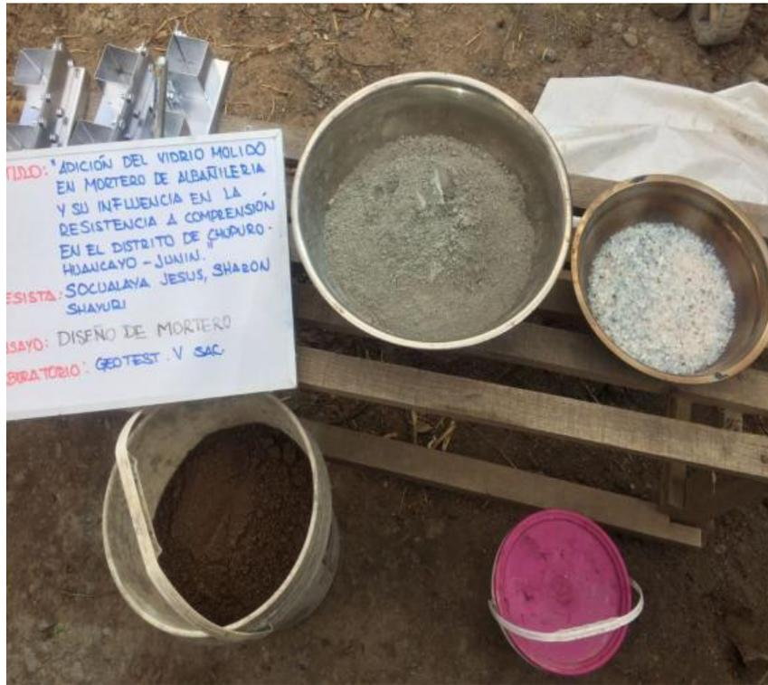
Se observa en la fotografía la arena gruesa, cemento, vidrio molido, agua para realizar la mezcla de diseño de mortero de 5% con adición de vidrio molido.
