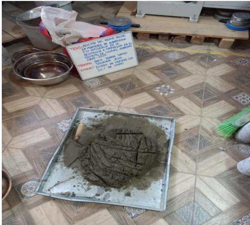
Se observa en la fotografía el proceso de mezcla de diseño de mortero de 10% con adición de vidrio molido.
