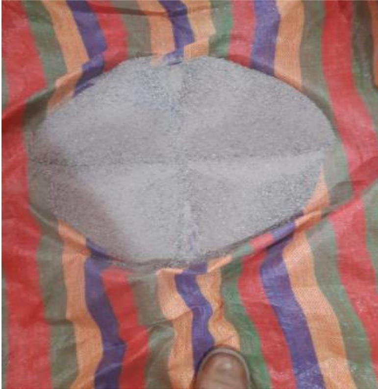
Se observa en la fotografía el agregado (arena gruesa) siendo partido en cuatro proporciones iguales para ser pesado, tamizado y realiza la caracterización.
