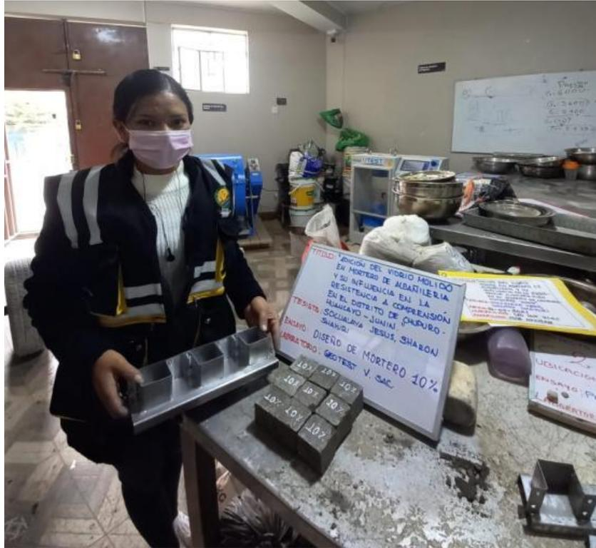
Se observa en la fotografía las probetas del diseño de mortero de 10% con adición de vidrio molido desencofrado.
