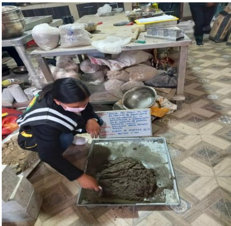
Se observa en la fotografía el proceso de mezcla de diseño de mortero de 15% con adición de vidrio molido.
