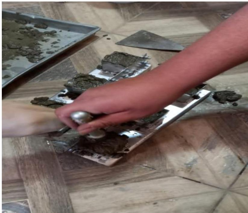
Se observa en la fotografía el proceso de mezcla de diseño de mortero de 10% con adición de vidrio molido.
