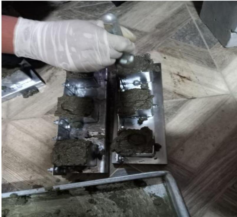
Se observa en la fotografía el proceso de mezcla de diseño de mortero de 15% con adición de vidrio molido.
