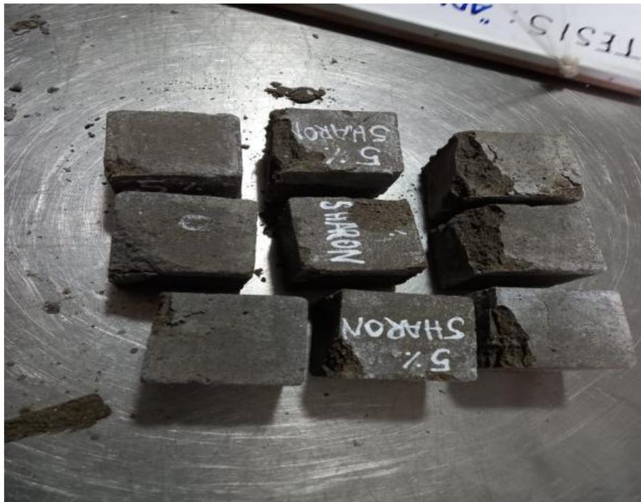
Se observa en la fotografía las probetas después del proceso del ensayo a COMPRESION SIMPLE del 5% fracturadas.
