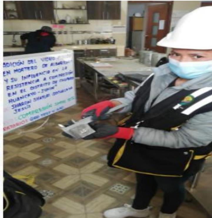
Se observa en la fotografía las dimensiones de los cubos de mortero con adición del vidrio molido al mortero al 10%.
