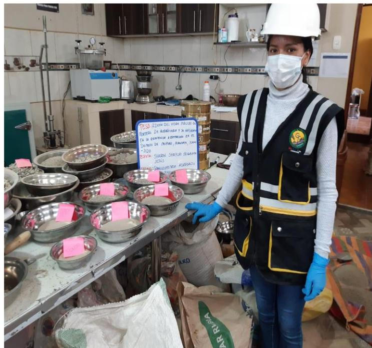
Se observa en la fotografía el agregado (arena gruesa) en el proceso de tamizado desde el tamiz 14 al 200 para realizar la caracterización.
