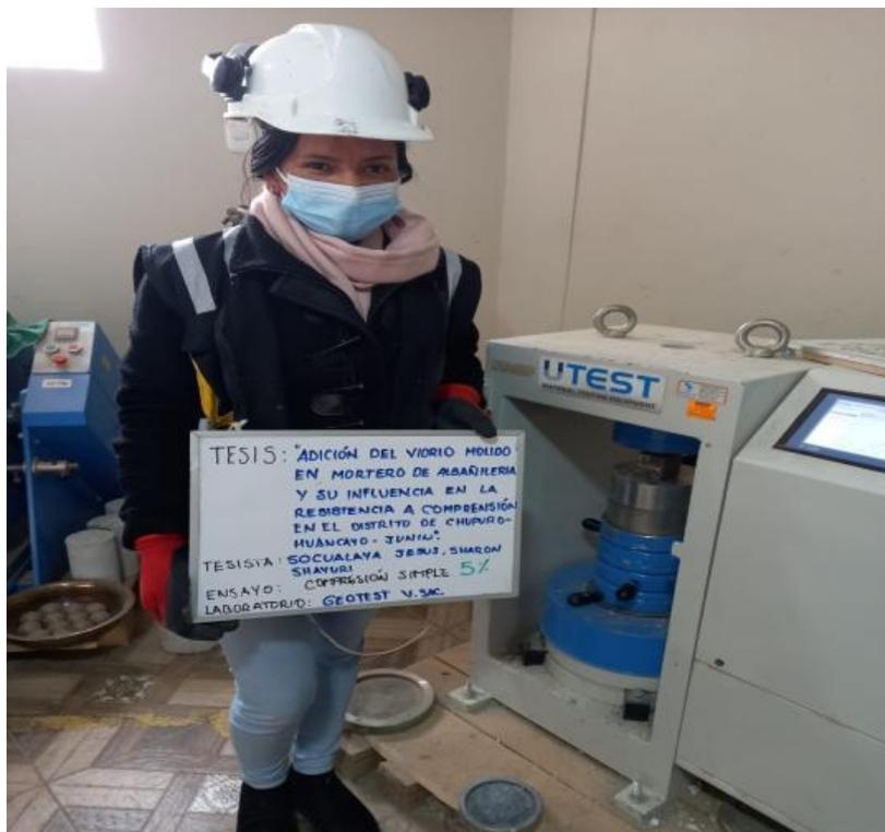
Se observa en la fotografía el inicio del ensayo a COMPRESION SIMPLE del 5% de la probeta del mortero con adición del 5% de vidrio molido.
