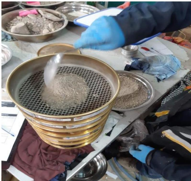
Se observa en la fotografía el agregado (arena gruesa) en el proceso de tamizado desde el tamiz 14 al 200 para realizar la caracterizacion.
