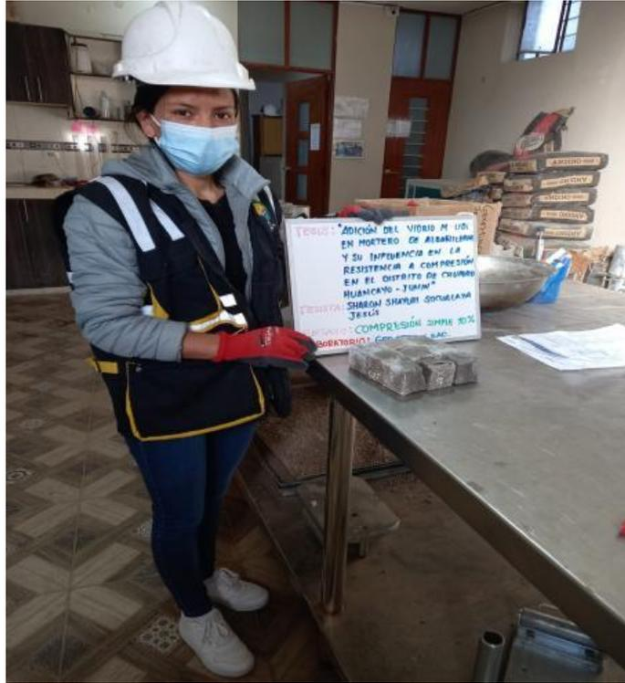
Se observa en la fotografia los 09 cubos de mortero antes de realizar el ensayo de laboratorio de compresion simple del 10%.
