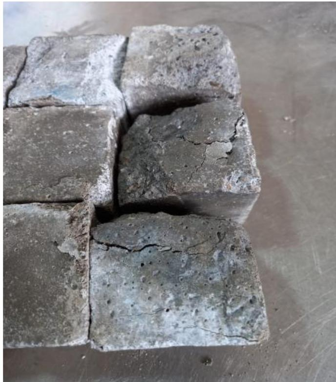
Se observa en la fotografia los cubos de mortero con fracturas despues de haber sido sometido al ensayo de COMPRESION SIMPLE del 10%.
