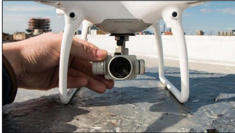
**Figura 13** Cámara digital instalada en RPA Phantom
