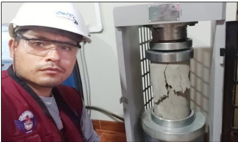
Fotografía 9. Vista de probeta fracturada.
