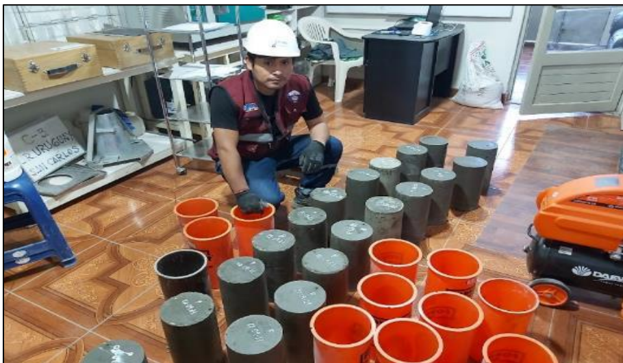
Fotografía 7. Vista de probetas de concreto autocompactante.
