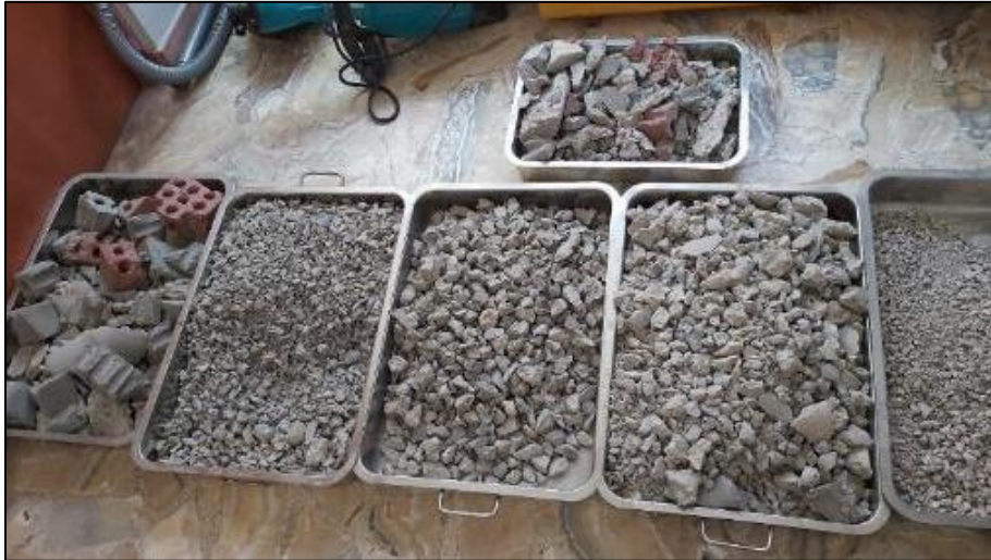
Fotografía 1. Vista de distintas granulometrías del concreto reciclado triturado.
