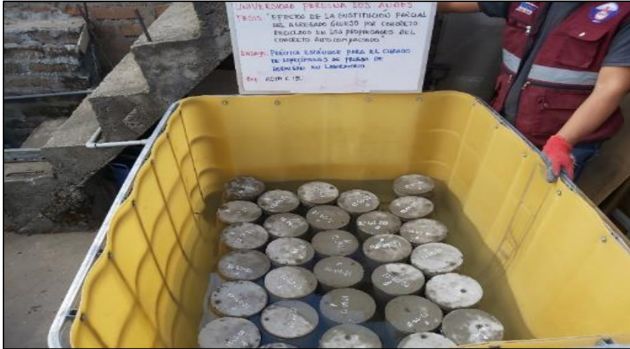
Fotografía 8. Vista de probetas de concreto autocompactante.
