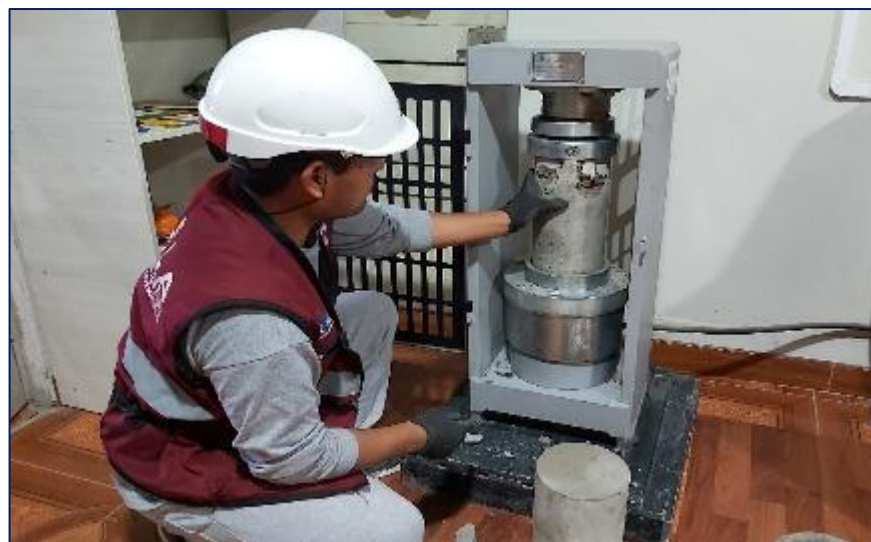
Figura 33. Método de Ensayo Normalizado para Resistencia a la Compresión de Especímenes Cilíndricos de Concreto, de acuerdo a la norma NTP 339.034.
