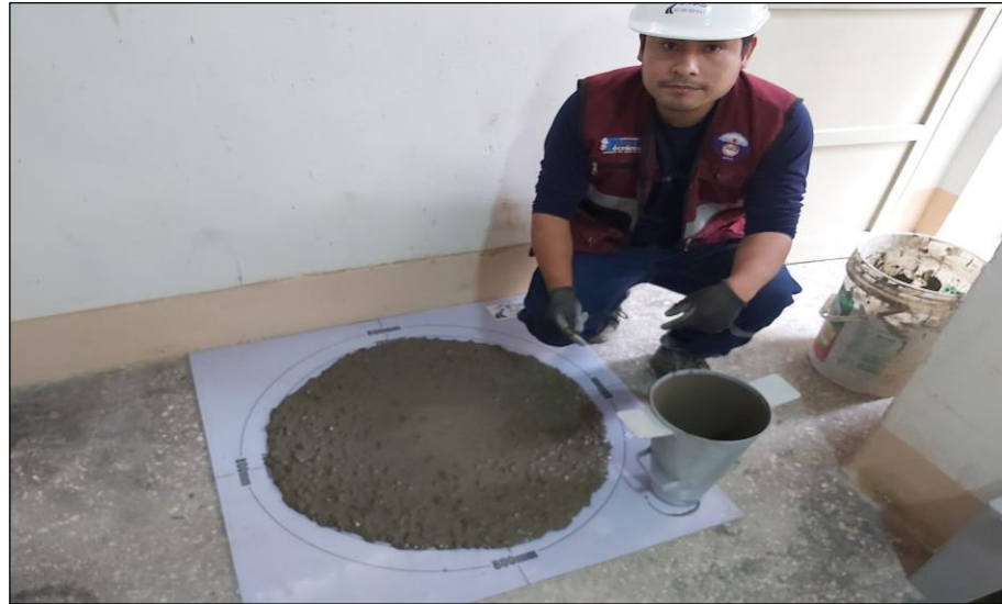
Figura 30. Método de prueba estándar para el flujo de asentamiento de concreto autocompactante con la norma NTP 339.219
