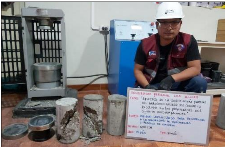
Fotografía 10. Vista de probetas sometidas a compresión.
