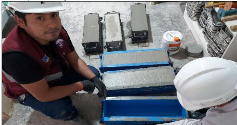
Figura 28. Práctica estándar para la fabricación de probetas con concreto autocompactante según la norma ASTM C1758.
