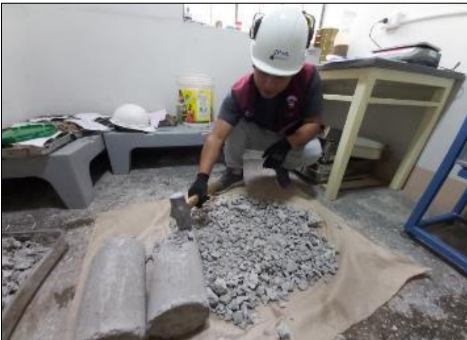
Fotografía 3. Triturado del concreto reciclado.
