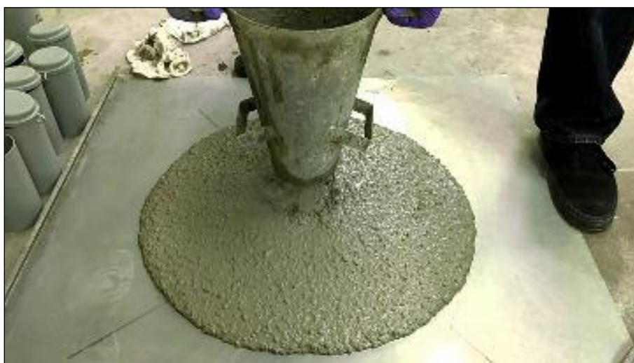
Figura 11. Trabajabilidad del concreto autocompactante. Fuente: (Arkotwal, 2013)
