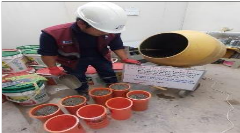
Figura 27. Práctica estándar para la fabricación de probetas con concreto autocompactante según la norma ASTM C1758.
