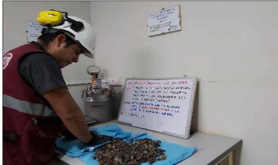
Figura 26. Método de ensayo normalizado para determinar la densidad, la densidad relativa (gravedad específica), y la absorción de agregados gruesos según la norma NTP 400.021.
