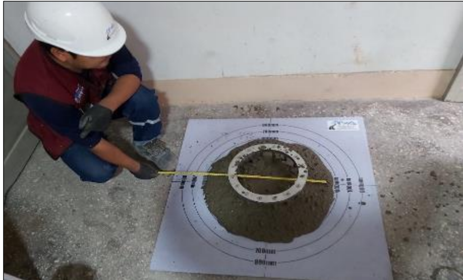
Figura 31. Método de prueba estándar para aprobar la capacidad de paso de concreto autocompactante mediante anillo en J de acuerdo a la norma NTP 339.220
