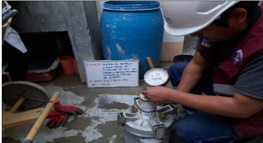
Figura 29. Método de Ensayo Normalizado de Contenido de Aire del Concreto Recién Mezclado Mediante el Método por Presión según la norma NTP 339.083.
