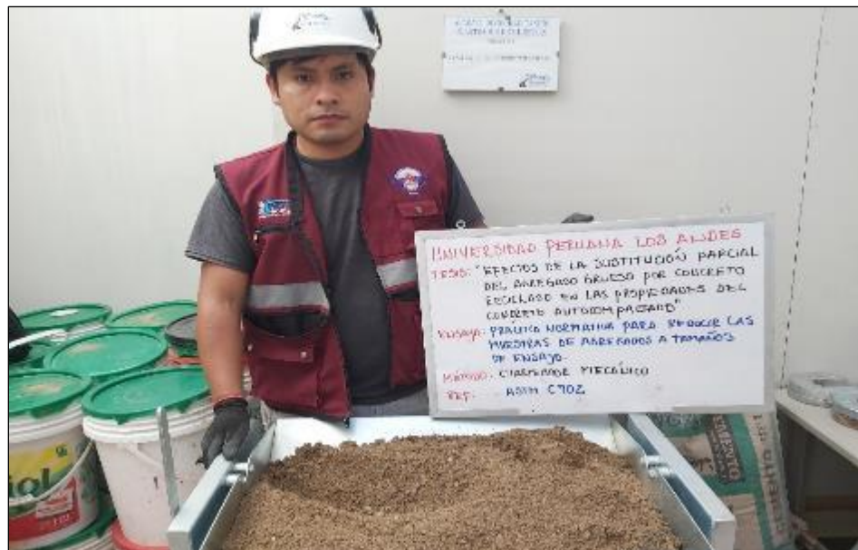
Figura 22. Práctica de estándar para el tamizado de los agregados según la norma ASTM C702.
