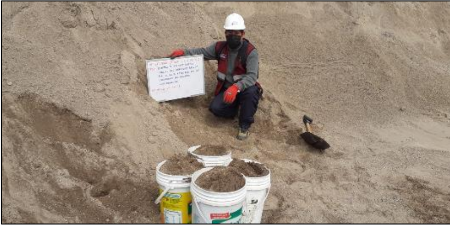
Fotografía 1. Muestreo del agregado fino para la elaboración del concreto.
