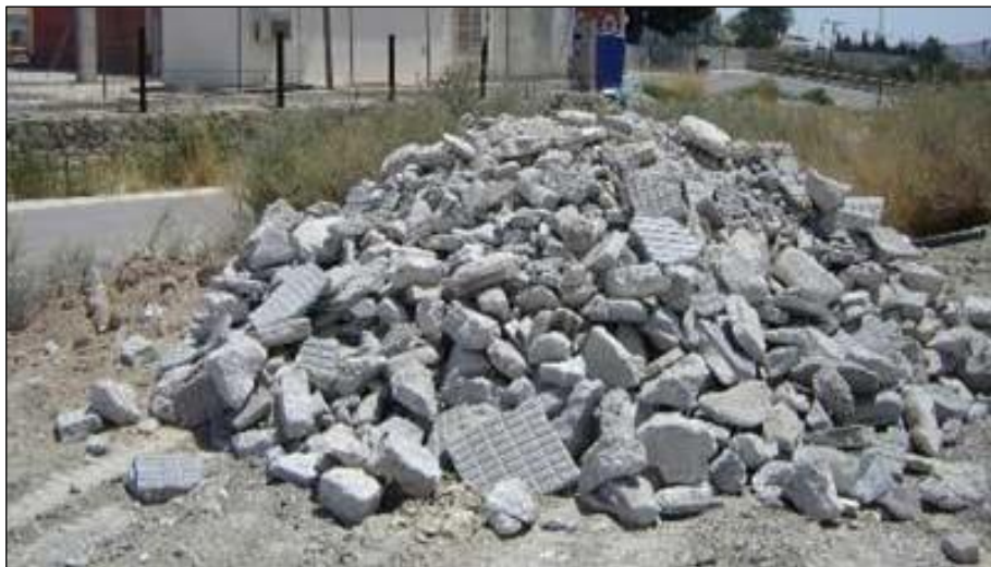
Figura 2. Concreto Reciclado, producto de demoliciones de viviendas.
