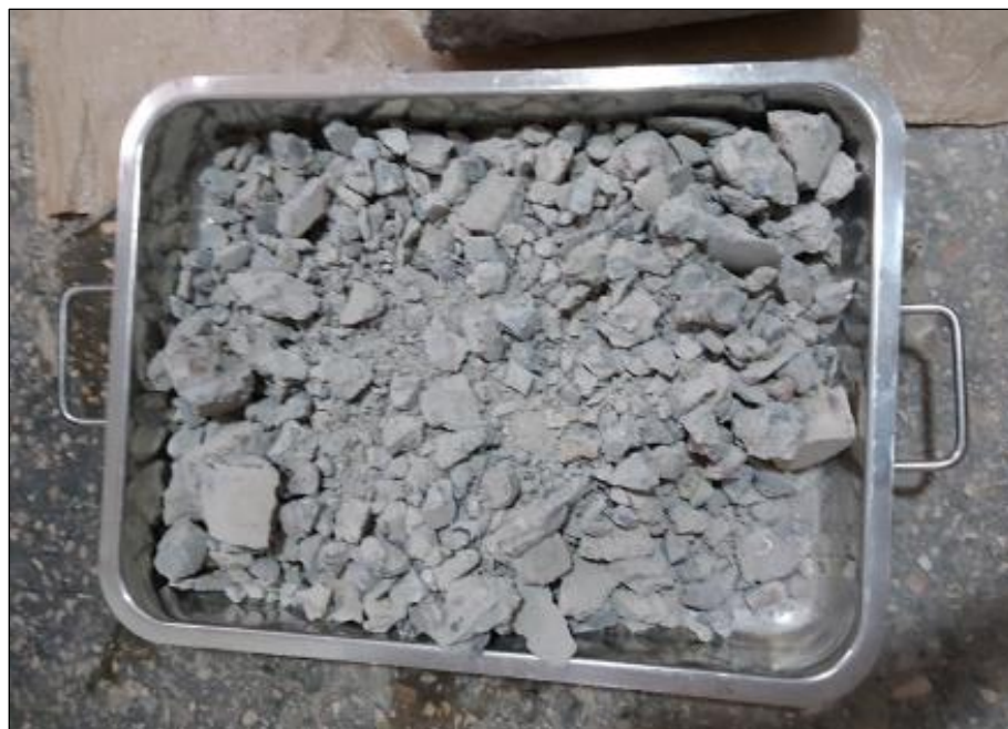
Figura 20. Tratamiento del concreto reciclado.
