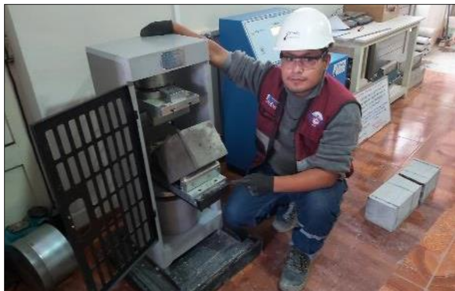
Figura 32. Método de ensayo normalizado para la determinación de la resistencia a la flexión del concreto (Utilizando viga simple con carga en los tercios del claro), en función a la norma NTP 339.078.
