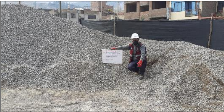
Fotografía 2. Muestreo de la piedra chancada para la elaboración del concreto.
