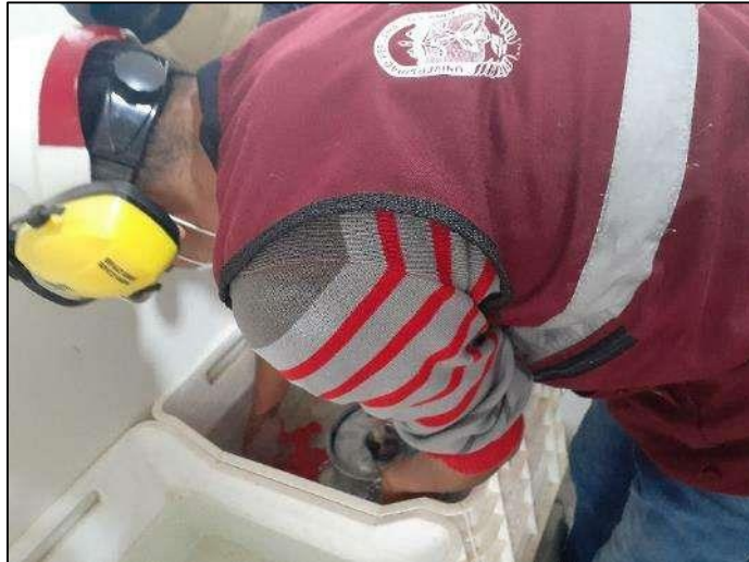
Fotografía 31. Sumergimiento de las muestras de suelo – cemento, para el ensayo CBR.
