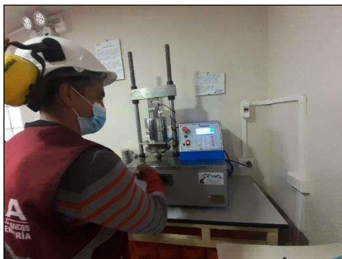
Fotografía 33. Ejecución del ensayo de CBR de las muestras de suelo – cemento.
