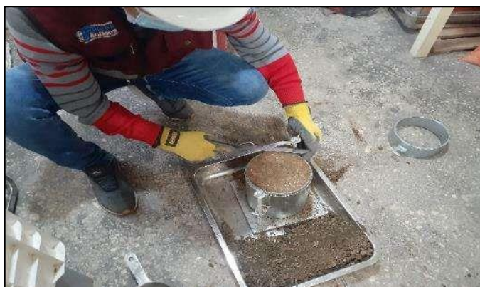
Fotografía 30. Preparación de las muestras para el ensayo de CBR.
