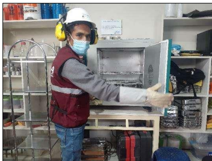
Fotografía 27. Preparación del horno para el secado de las muestras de suelo – cemento.
