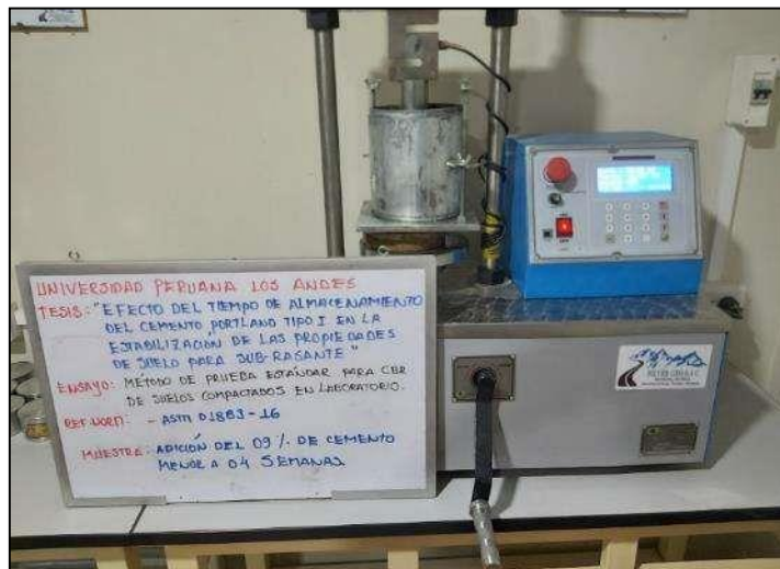
Fotografía 32. Vista del ensayo de CBR con la mezcla suelo - cemento.
