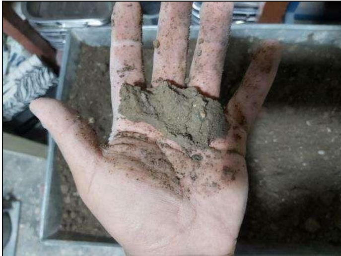
Fotografía 22. Vista del suelo mezclado con cemento.
