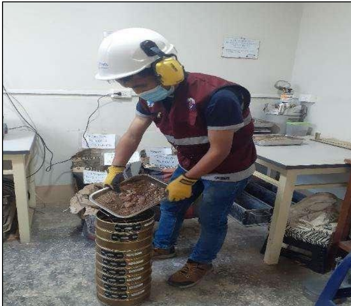
Fotografía 23. Vista del ensayo de granulometría con la mezcla de suelo-cemento.
