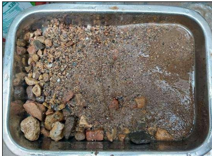
Fotografía 11. Realización del ensayo de granulometría del suelo.
