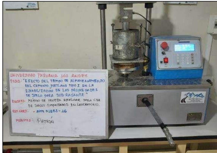
Fotografía 19. Ejecución del ensayo de CBR.
