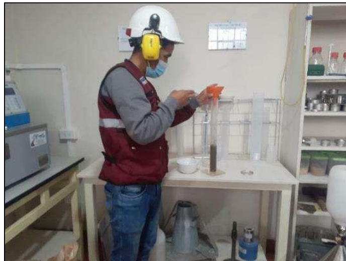
Fotografía 26. Realizando el ensayo de equivalente de arena de la mezcla de suelo – cemento.
