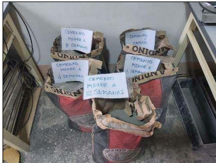
Fotografía 20. Vista del cemento utilizado en la investigación, el cual tiene diferentes tiempos de almacenamiento.
