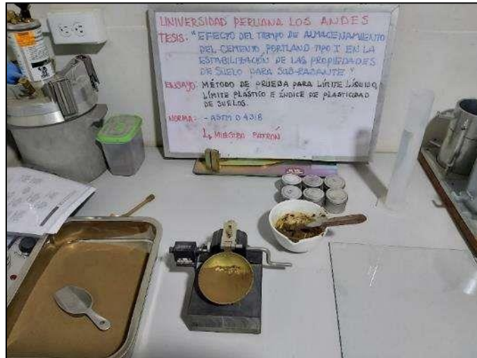
Fotografía 13. Realización del ensayo de Casagrande para el límite líquido.
