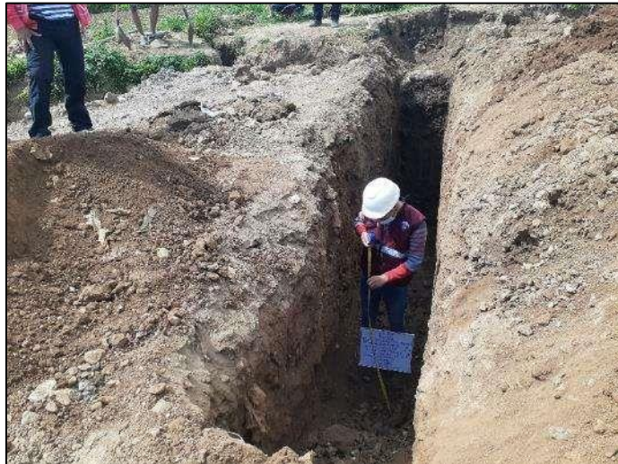
Fotografía 2. Verificación de las profundidades para la extracción de las muestras de suelo.
