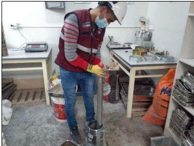
Fotografía 29. Ensayo de compactación de muestras de suelo – cemento.
