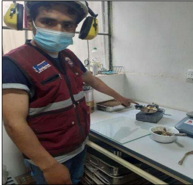
Fotografía 28. Ensayo del límite líquido con la mezcla de suelo – cemento.
