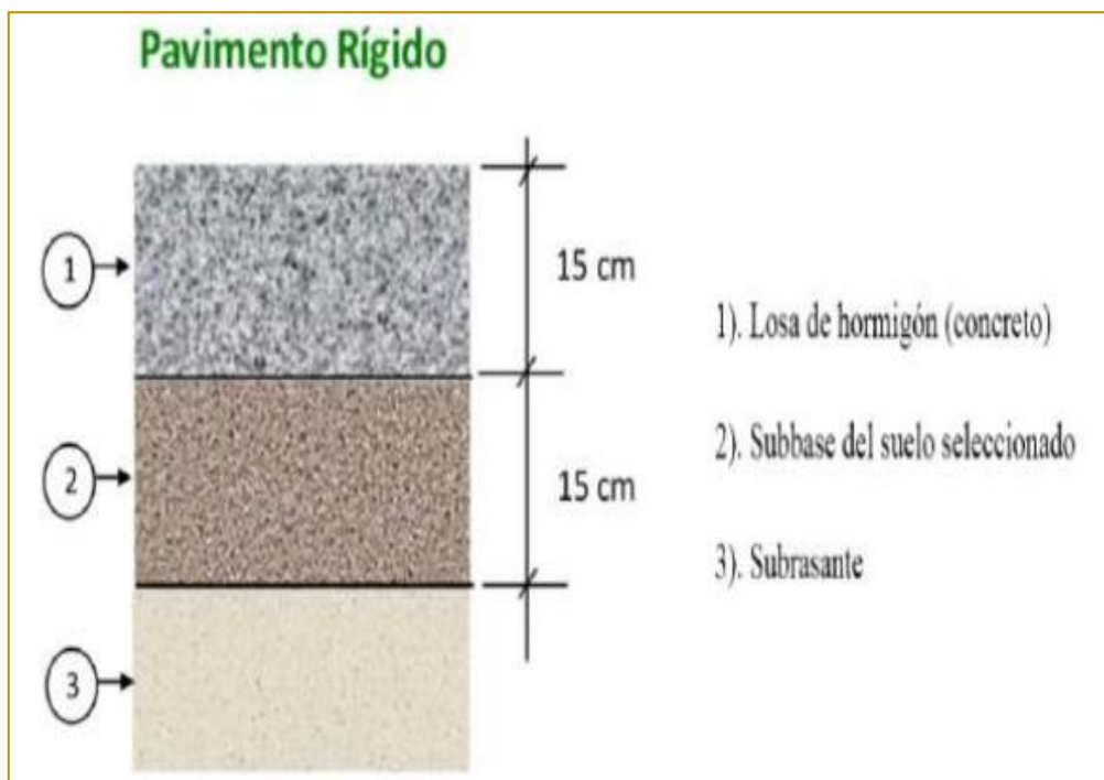
Figura 2.- Sección transversal pavimento rígido
