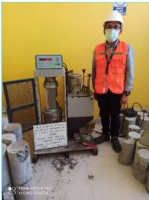
Se aprecia el ensayo de compresión del concreto con la adición de los residuos de ladrillosa artesanales al 5%, a una edad de 14 días.
