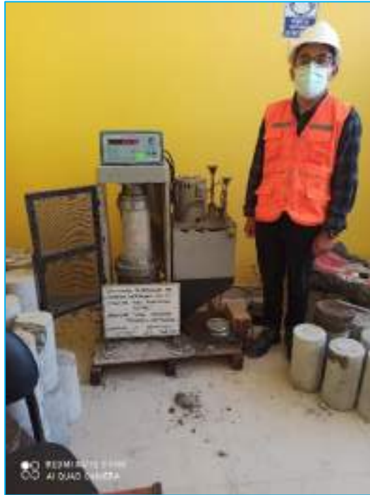
Se aprecia el ensayo de compresión del concreto con la adición de los residuos de ladrillosa artesanales al 15%, a una edad de 14 días.
