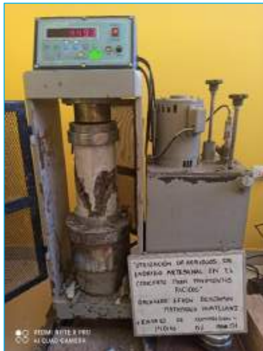
Se aprecia el ensayo de compresión del concreto sin adicionar los residuos de ladrillos artesanales, a una edad de 14 días.
