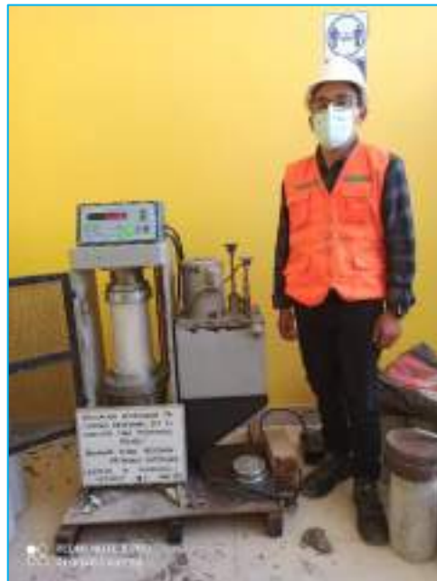
Se aprecia el ensayo de compresión del concreto con la adición de los residuos de ladrillosa artesanales al 10%, a una edad de 14 días.
