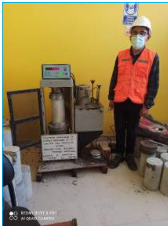
Se aprecia el ensayo de compresión del concreto con la adición de los residuos de ladrillosa artesanales al 10%, a una edad de 14 días.
