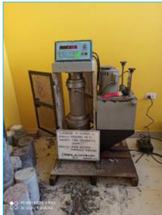
Se aprecia el ensayo de compresión del concreto con la adición de los residuos de ladrillosa artesanales al 10%, a una edad de 7 días.
