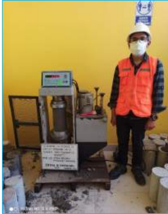
Se aprecia el ensayo de compresión del concreto con la adición de los residuos de ladrillosa artesanales al 10%, a una edad de 7 días.
