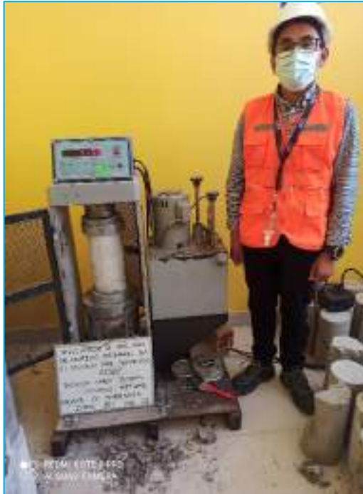
Se aprecia el ensayo de compresión del concreto con la adición de los residuos de ladrillosa artesanales al 10%, a una edad de 14 días.
