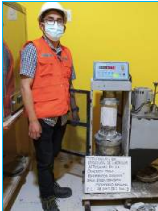
Se aprecia el ensayo de compresión del concreto con la adición de los residuos de ladrillosa artesanales al 15%, a una edad de 28 días.
