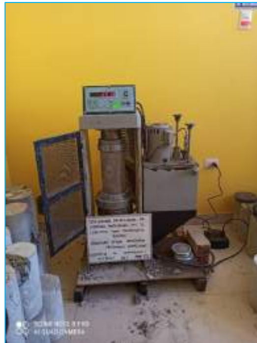
Se aprecia el ensayo de compresión del concreto con la adición de los residuos de ladrillosa artesanales al 20%, a una edad de 14 días.
