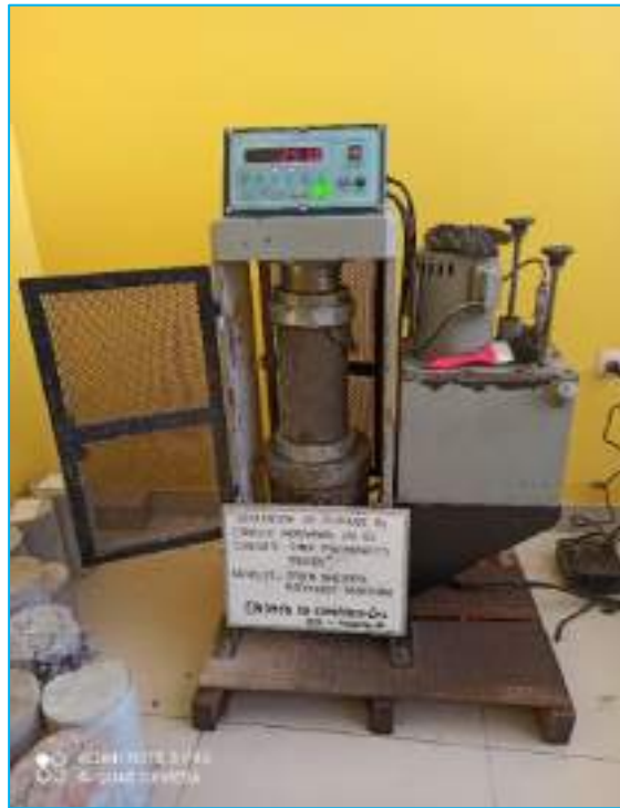
Se aprecia el ensayo de compresión del concreto sin adicionar los residuos de ladrillosa artesanales, a una edad de 7 días.
