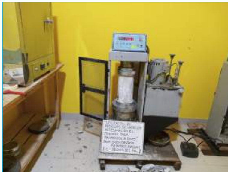
Se aprecia el ensayo de compresión del concreto con la adición de los residuos de ladrillosa artesanales al 20%, a una edad de 28 días.
