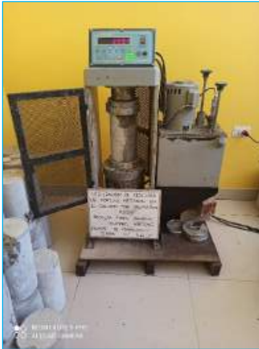
Se aprecia el ensayo de compresión del concreto sin adicionar los residuos de ladrillosa artesanales, a una edad de 21 días.
