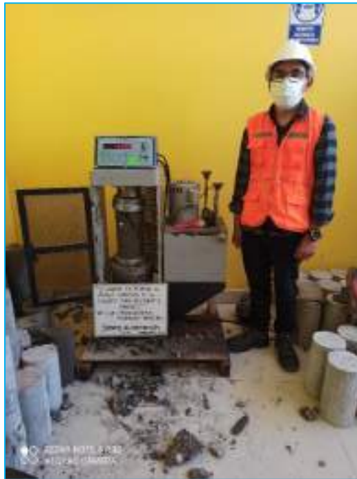
Se aprecia el ensayo de compresión del concreto con la adición de los residuos de ladrillos artesanales al 20%, a una edad de 7 días.
