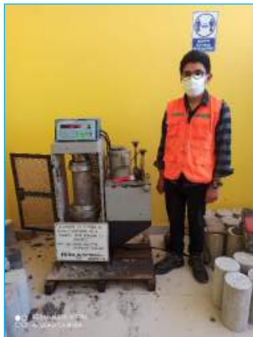
Se aprecia el ensayo de compresión del concreto con la adición de los residuos de ladrillosa artesanales al 5%, a una edad de 7 días.
