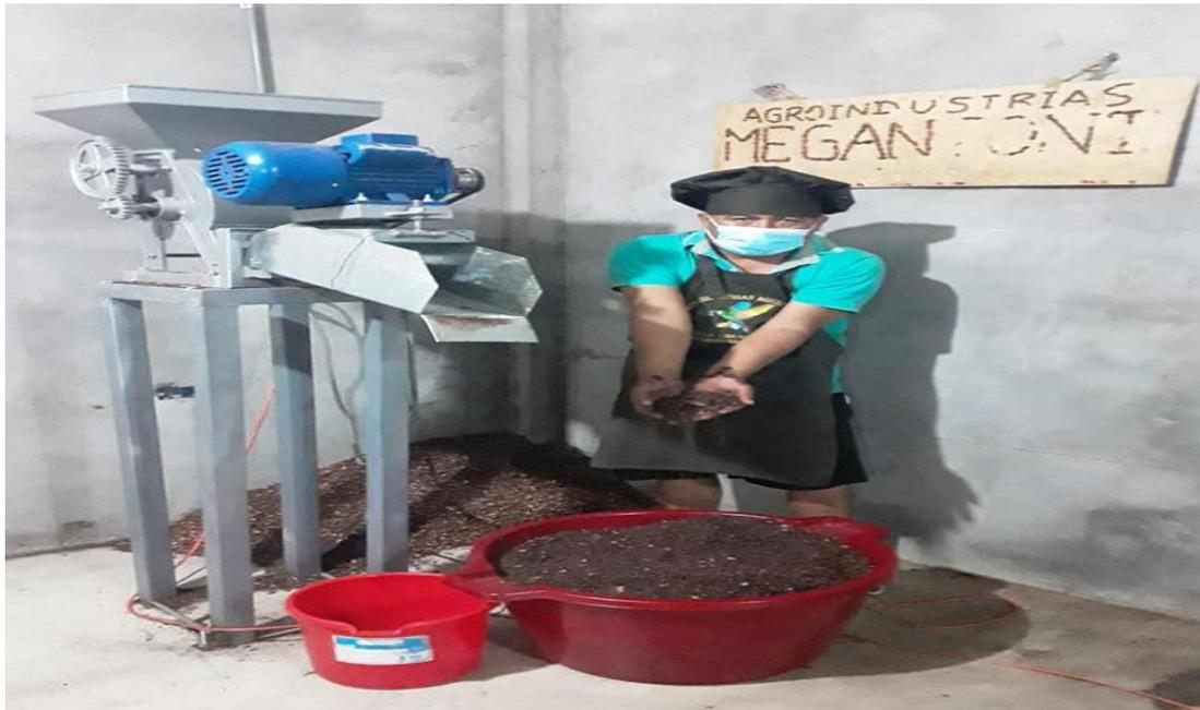
**Ilustración 5** Descascarillado para la obtención de nibs (Después)
