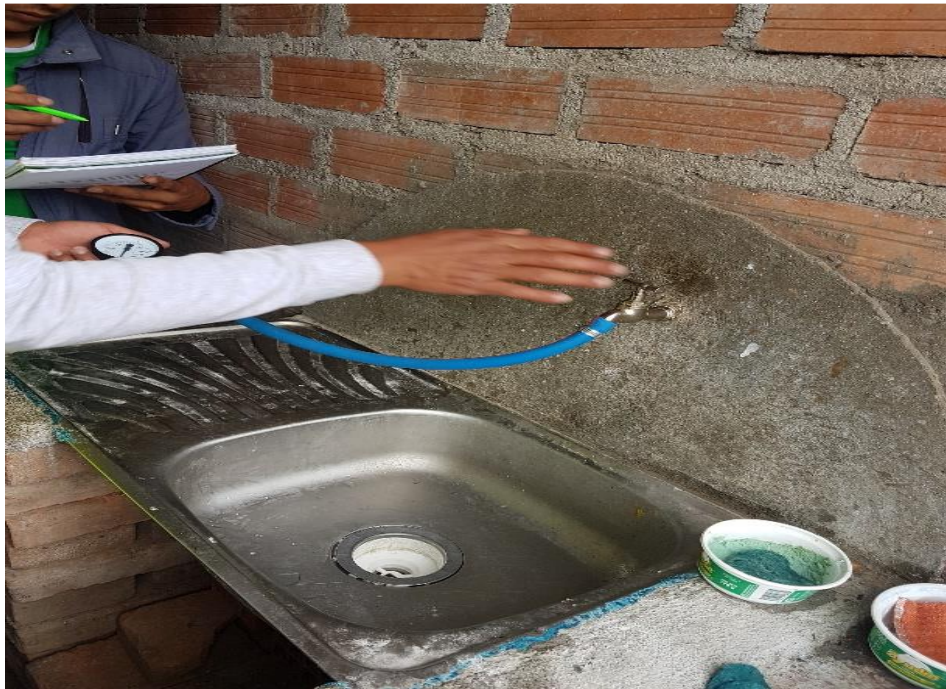
Imagen 22: Medición de presión en el pJe.Los Quinuales.
