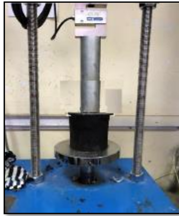
Figura 12: Prensa de compactación.
