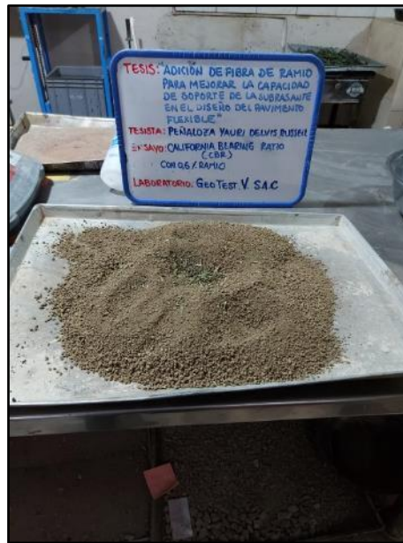
Fotografía N° 5: Combinación para los ensayos con adición 0.6% de Fibra de Ramio.
