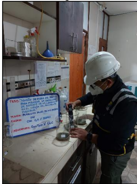
Fotografía N° 9: Ensayo de análisis de PH del suelo con adición 0.6% Fibra de Ramio. Según la NTP 339.176.
