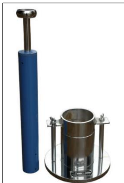
Figura 18: Materiales usados en el ensayo de Proctor Estándar (base, molde, collar y pisón)
