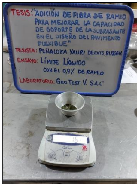
Fotografía N° 14: Ensayo de Limite Líquido con adición de Ensayo de Limite Líquido con adición 0.9% Fibra de Ramio. Según la NTP 339.129.
