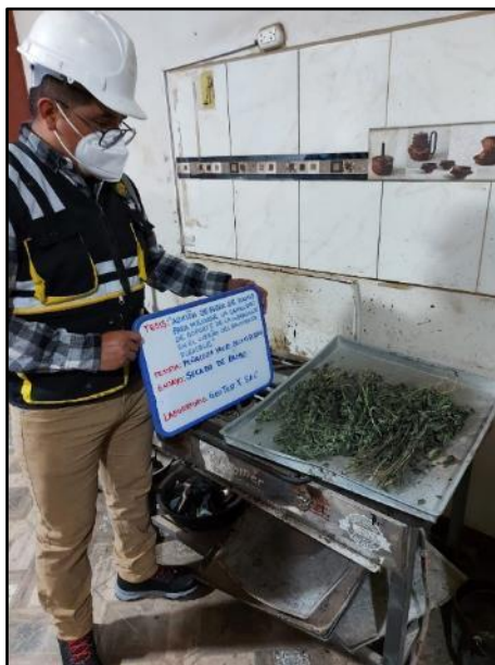
Fotografía N° 4: Combinación para los ensayos con adición 0.3% de Fibra de Ramio.
