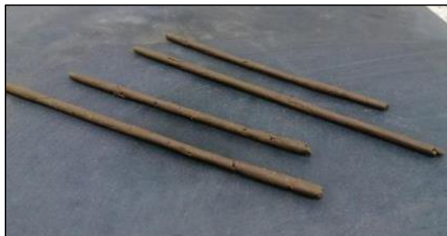
Figura 16: Moldeado de cilindros con alambre de referencia de 1/8"
