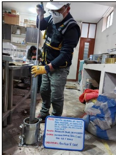
Fotografía N° 21: Apisonamiento del material dentro del molde en 5 capas, en un molde con 56 golpes, en el segundo molde por 25 golpes y en el tercer molde 12 golpes con adición 0.6% de Fibra de Ramio. Según la NTP 339.175:2002Según la NTP 339.175:2002.
