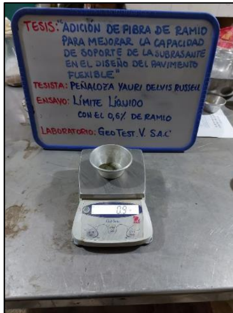
Fotografía N° 13: Ensayo de Límite Líquido con adición 0.6% Fibra de Ramio. Según la NTP 339.129.
