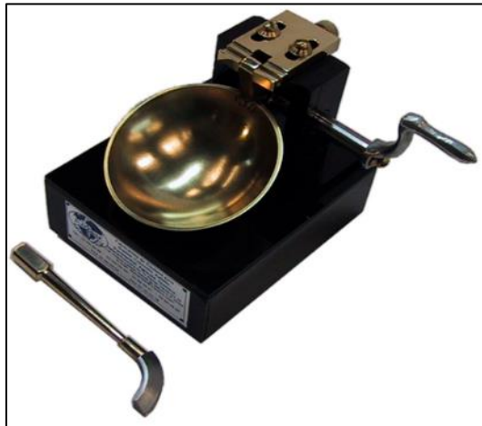
Figura 15: Aparato para límite de líquidos o copa Casagrande con ranurador ASTM-D4318 /AASHTO –T89
