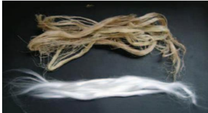
Figura 6: Fibra de ramio cruda y desgomada
