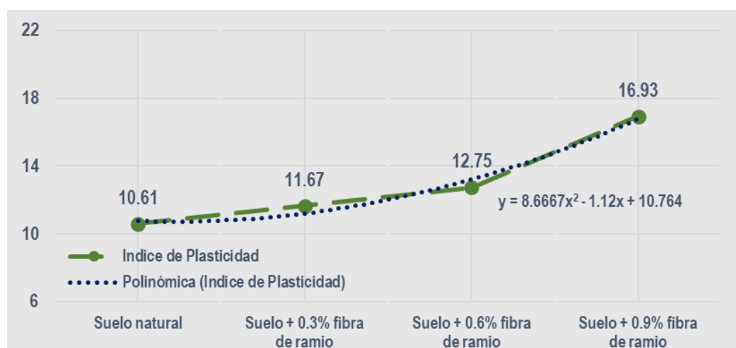
Figura 24: Plasticidad, suelo con y sin fibra de ramio.
