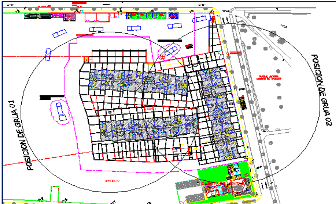
Figura 19. Posición de Torre Grúa
