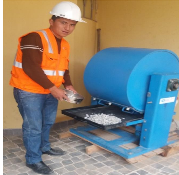
Ensayo de Abrasión los Ángeles de Material Pétreo del Agregado de 1/2" y 3/8" Cantera
