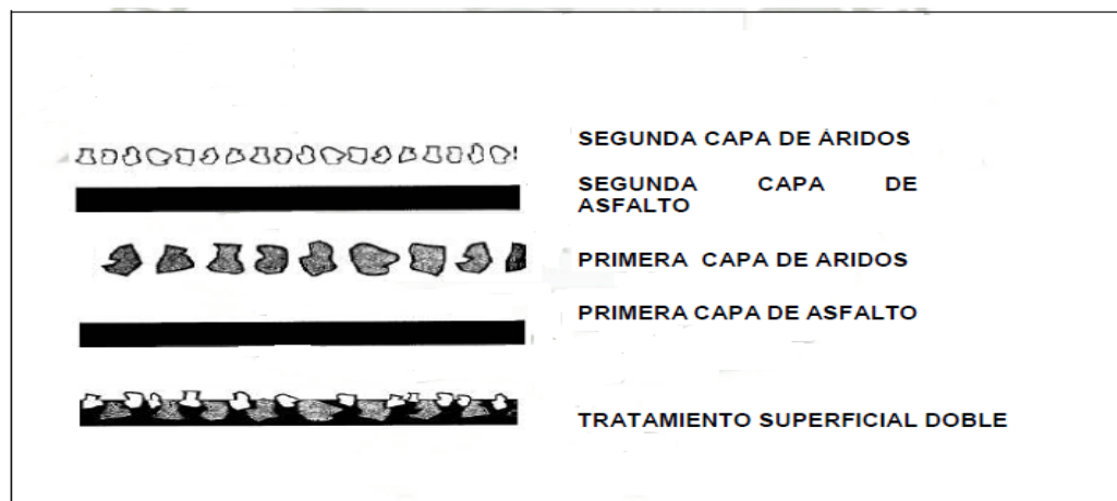
Figura N° 03, Esquema de un tratamiento superficial doble
