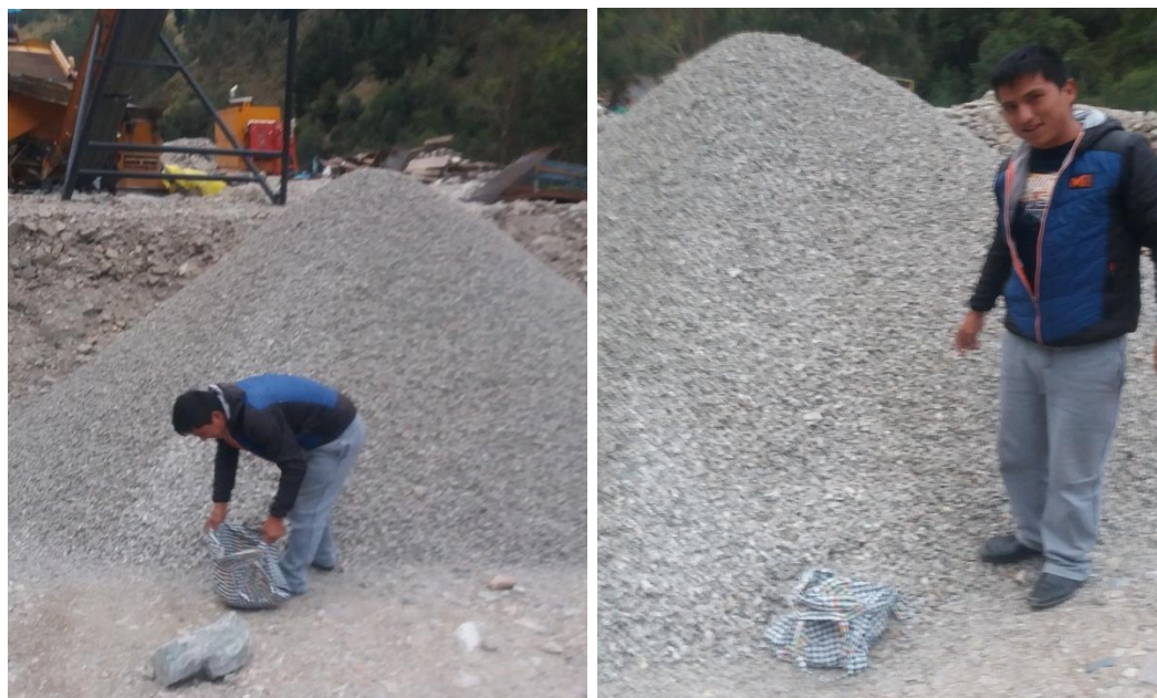
Figura N°17: Toma de muestra planta chancadora de agregados en Chamiseria
