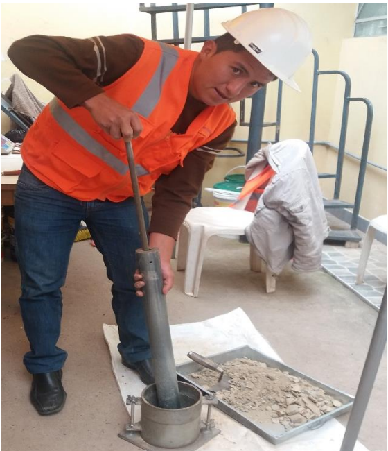
Ensayo de Proctor modificado para calcular la Máxima Densidad del Suelo de Cantera
