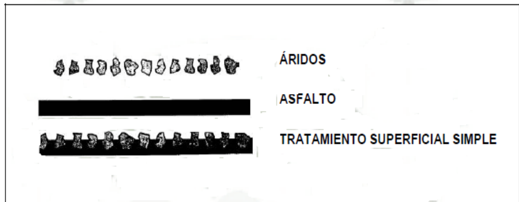
Figura N° 02, Esquema de un tratamiento superficial simple
