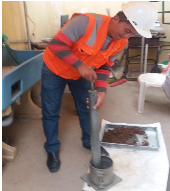
Ensayo de Proctor modificado para calcular la Máxima Densidad del Suelo de la Calicata
