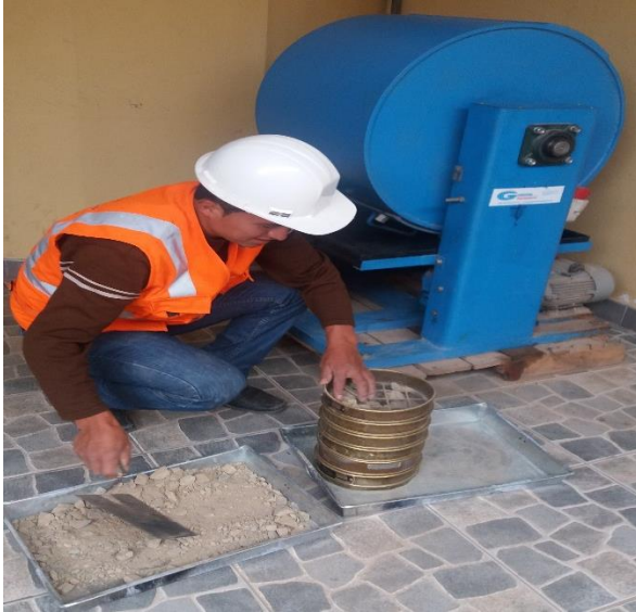
Ensayo de Abrasión los Ángeles de Material granular de Cantera
