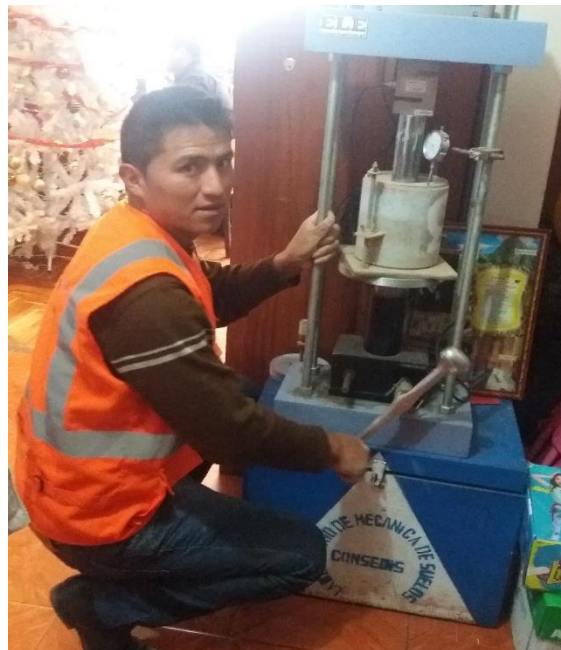
Ensayo de Penetración del Material Granular C.B.R. de la Cantera
