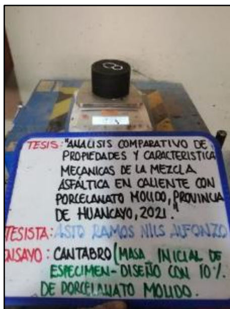
Fotografía N° 134: Mezcla bituminosa caliente de granulometría abierta, donde la resistencia de disgregación de mezcla ante efectos abrasivos, según referencia de la norma MTC D – 352.
