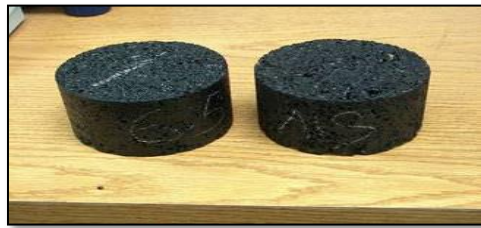
Figura 18. Especímenes elaborados con mezcla asfáltica en caliente convencional.
