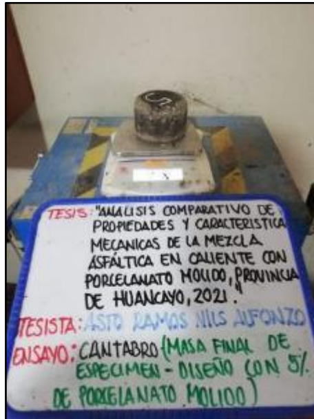
Fotografía N° 133: Determinación del valor de la pérdida por desgaste de la mezcla bituminosa, según referencia de la norma MTC D-352.
