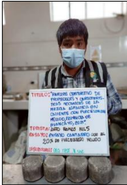
Fotografía N° 139: Determinación del valor de la pérdida por desgaste de la mezcla bituminosa, según referencia de la norma MTC D-352.
