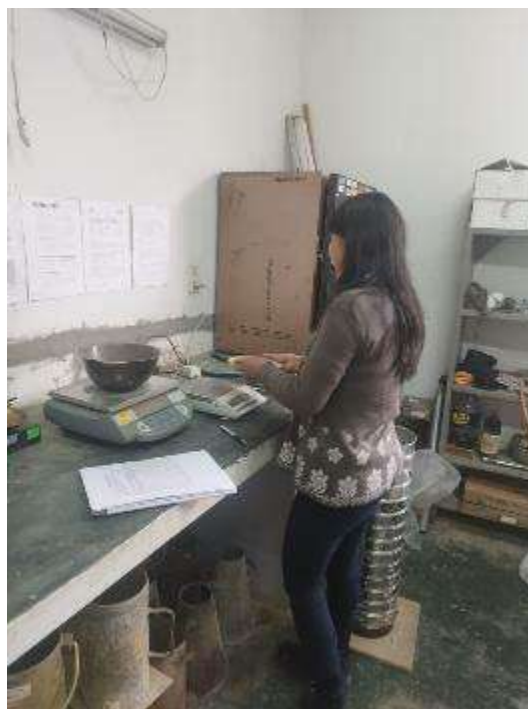
Fotografía 8: Tamizado del terreno natural en tres repeticiones según ASTM D 422
