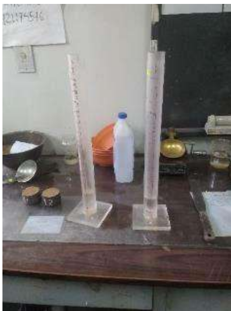
Fotografía 34: Ensayo de equivalente de arena del suelo agregando 10%, 20% y 30% de residuos de ladrillo en tres repeticiones según NTP 339.146:2000
