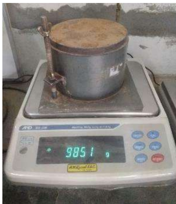
Fotografía 26: Ensayo de Próctor modificado método C según NTP 339.141 con material que pasa la malla \frac{3}{4} " de suelo agregando 10%, 20% y 30% de residuos de concreto.
