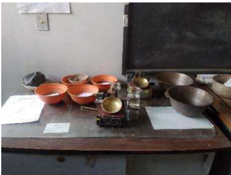
Fotografía 20: Ensayo de límite líquido con la copa de Casagrande agregando 10%, 20% y 30% en tres repeticiones cada uno según NTP 339.129
