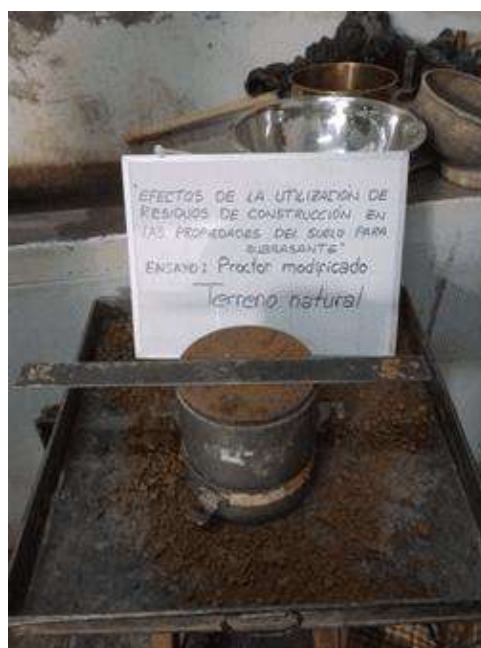
Fotografía 14: Compactado de la muestra en 5 capas, enrasado y pesado del espécimen y molde en tres repeticiones según NTP 339.141
