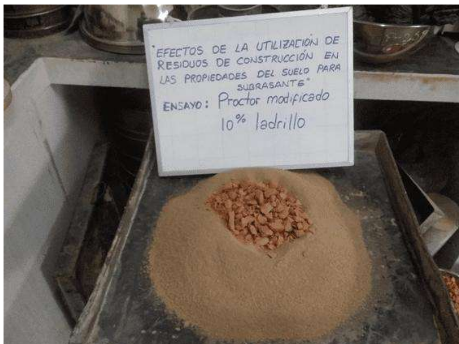
Fotografía 35: Ensayo de Próctor modificado agregando 10% de residuos de ladrillo en tres repeticiones según NTP 339.141
