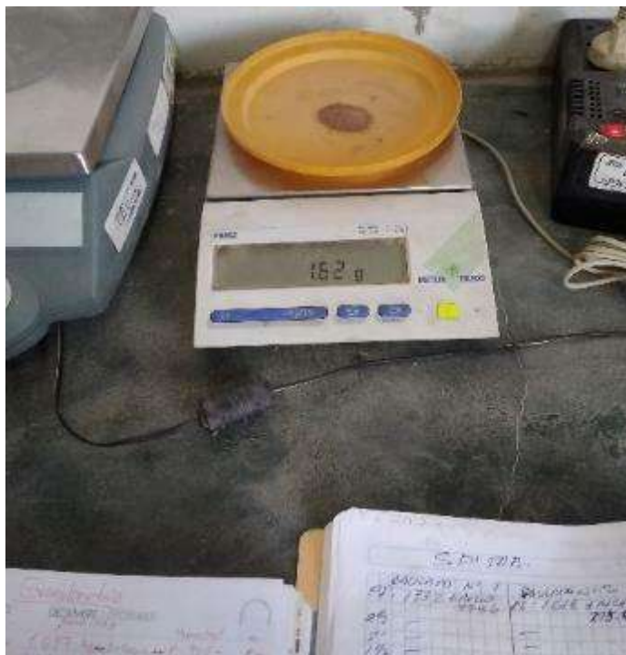
Fotografía 19: tamizado y pesado del material para determinar el tipo de suelo agregando 10%, 20% y 30% de concreto según ASTM D 422
