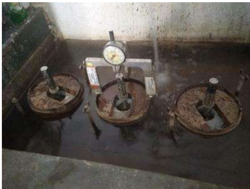
Fotografía 40: Ensayo de CBR agregando 30% de residuos de ladrillo en tres repeticiones según ASTM D 1883
