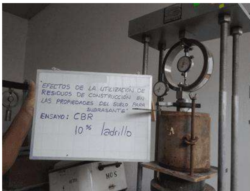
Fotografía 38: Ensayo de CBR agregando 10% de residuos de ladrillo en tres repeticiones según ASTM D 1883
