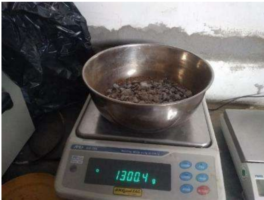
Fotografía 17: pesado del material para el ensayo de granulometría según ASTM D 422 agregando 10%, 20% y 30% de concreto en tres repeticiones cada uno.
