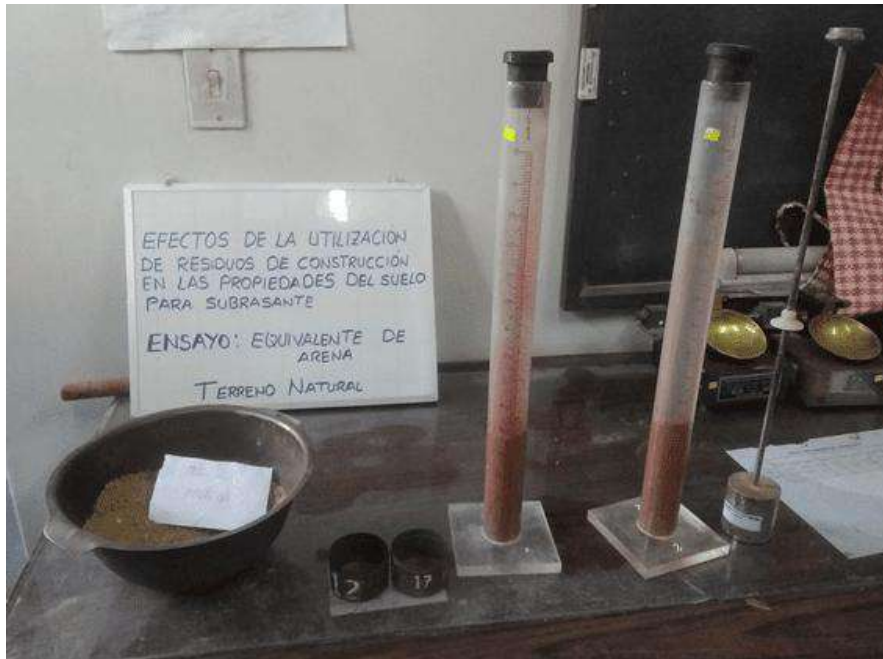
Fotografía 12: Ensayo de equivalente de arena del terreno natural con material que pasa por el Tamiz N°4, en tres repeticiones según NTP 339.146:2000
