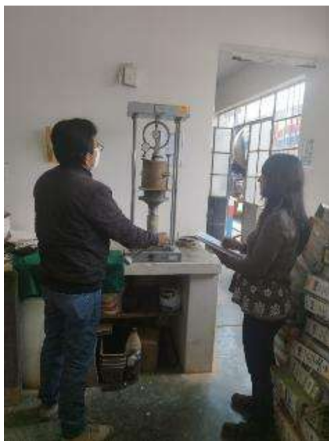
Fotografía 16: Ensayo de CBR de terreno natural según ASTM D 1883
