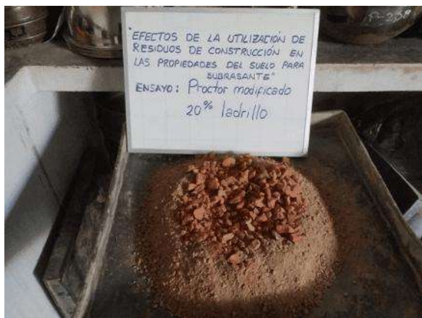
Fotografía 36: Ensayo de Próctor modificado agregando 20% de residuos de ladrillo en tres repeticiones según NTP 339.141
