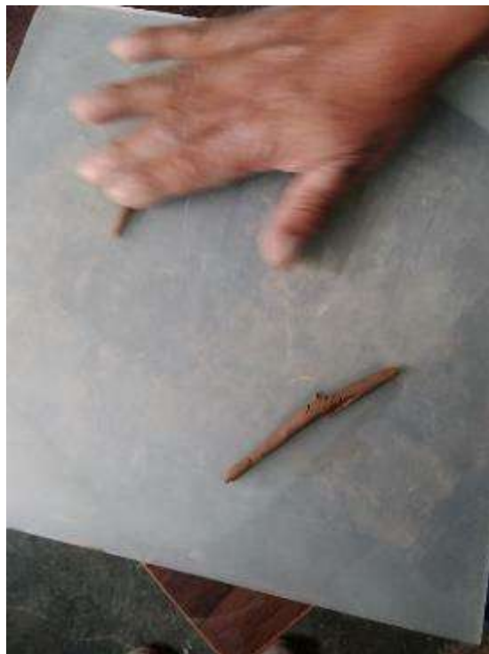
Fotografía 43: Ensayo de límite plástico del suelo según NTP 339.129 agregando 5% concreto + 5% ladrillo, 10% concreto + 10% ladrillo y 15% concreto + 15% ladrillo
