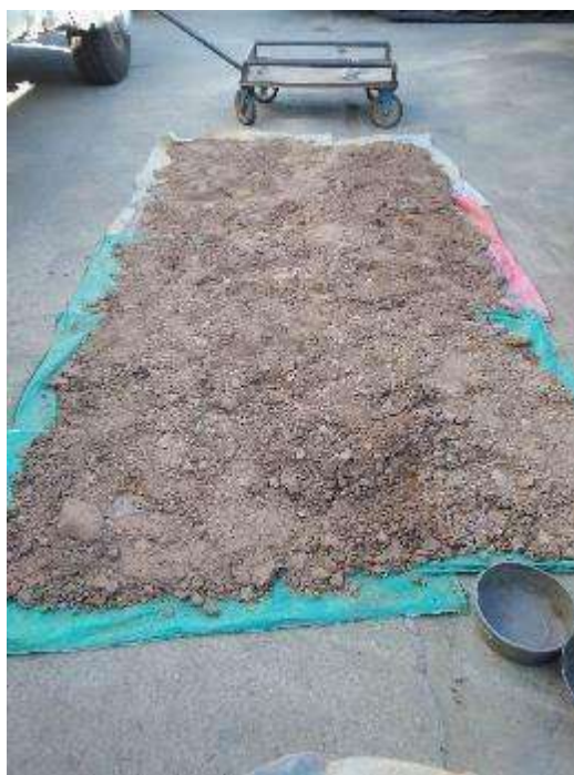
Fotografía 2: Material extraído de la calicata 1 Progresiva:1+850 siendo expuesto al aire hasta su secado según norma ASTM D 421
