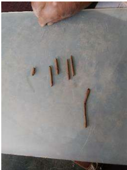
Fotografía 33: Ensayo límite plástico del suelo según NTP 339.129 agregando 10%, 20% y 30% de residuos de ladrillo en tres repeticiones cada uno
