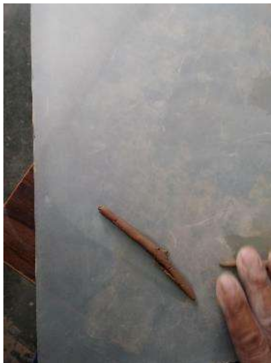
Fotografía 21: Ensayo de límite plástico del suelo agregando 10%, 20% y 30% de concreto en tres repeticiones cada uno según la NTP 339.129
