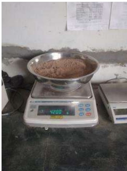
Fotografía 13: Pesado de material para realizar el Ensayo de Próctor modificado método C con material que pasa la malla \frac{3}{4} " según NTP 339.141
