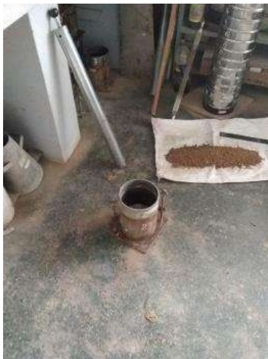
Fotografía 15: Preparación del molde, disco y collar para el Ensayo de CBR de terreno natural según ASTM D 1883
