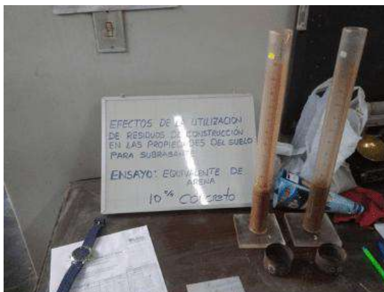
Fotografía 22: Ensayo de equivalente de arena del suelo agregando 10%, 20% y 30% de concreto en tres repeticiones según NTP 339.146:2000
