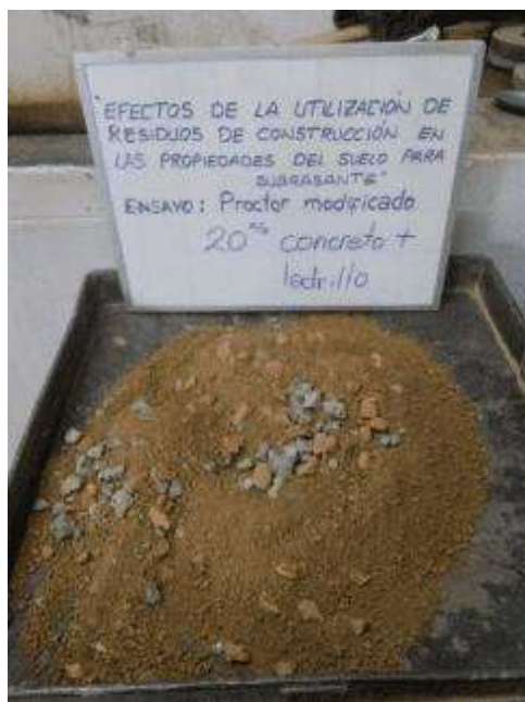
Fotografía 46: Ensayo de Próctor modificado según NTP 339.141 agregando 10% concreto + 10% ladrillo en tres repeticiones
