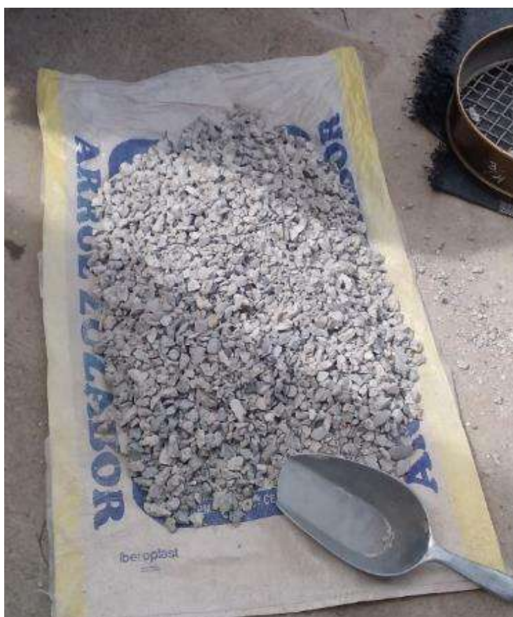
Fotografía 4: Chancados y tamizados de residuos de concreto con la malla \frac{3}{4} .
