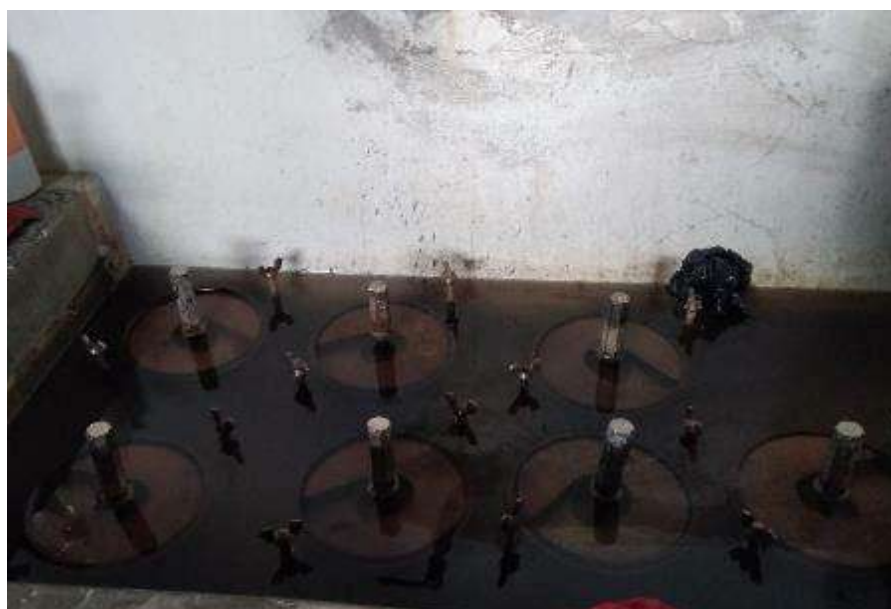
Fotografía 48: se realizó el ensayo de CBR según ASTM D 1883 agregando 5% concreto + 5% ladrillo, 10% concreto + 10% ladrillo y 15% concreto + 15% ladrillo en tres repeticiones cada uno
