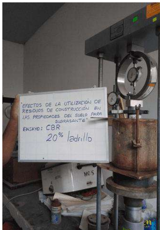
Fotografía 39: Ensayo de CBR agregando 20% de residuos de ladrillo en tres repeticiones según ASTM D 1883
