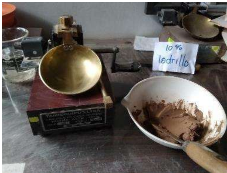
Fotografía 32: Ensayo de límite líquido con la copa de Casagrande según NTP 339.129 agregando 10%, 20% y 30% de residuos de ladrillo en tres repeticiones cada uno
