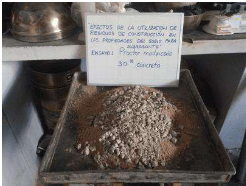
Fotografía 25: Ensayo de Próctor modificado agregando 30% de residuos de concreto en tres repeticiones según NTP 339.141
