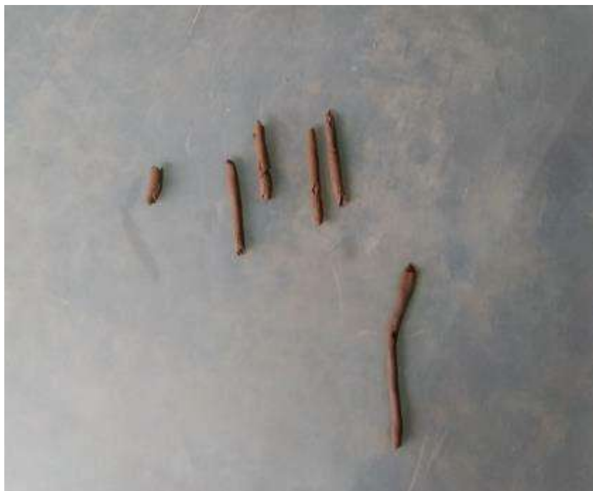
Fotografía 11: Ensayo de límite plástico del terreno natural en tres repeticiones según NTP 339.129
