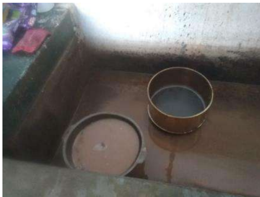
Fotografía 30: Lavado de material para el ensayo de granulometría según ASTM D 422 agregando 10%, 20% y 30% de residuos de ladrillo, en tres repeticiones
