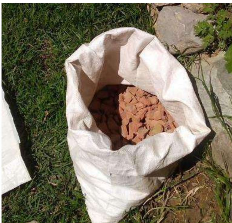
Fotografía 6: Chancado y tamizado de residuos de ladrillo con la malla \frac{3}{4} .
