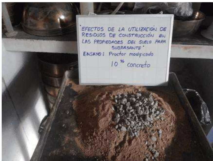
Fotografía 23: Ensayo de Próctor modificado agregando 10% de residuos de concreto en tres repeticiones según NTP 339.141
