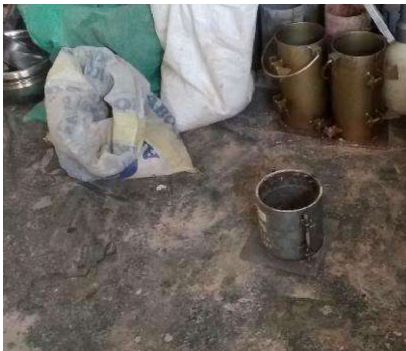
Fotografía 47: Ensayo de Próctor modificado según NTP 339.141 agregando 15% concreto + 15% ladrillo en tres repeticiones
