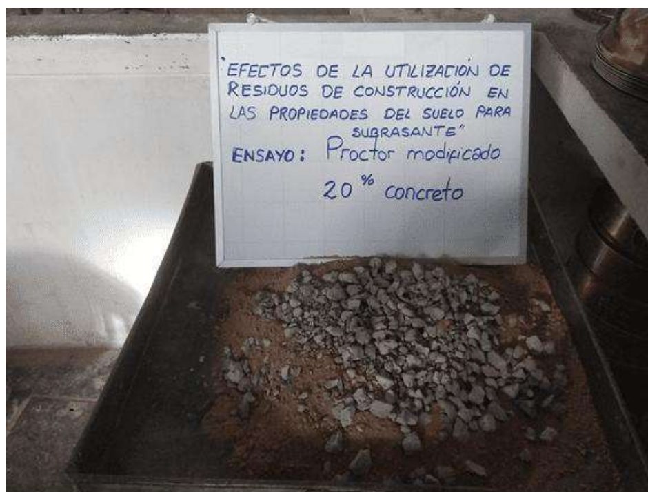
Fotografía 24: Ensayo de Próctor modificado agregando 20% de residuos de concreto en tres repeticiones según NTP 339.141
