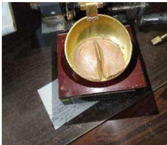
Fotografía 42: Ensayo de límite líquido con la copa de Casagrande según NTP 339.129 agregando 5% concreto + 5% ladrillo, 10% concreto + 10% ladrillo y 15% concreto + 15% ladrillo en tres repeticiones cada uno
