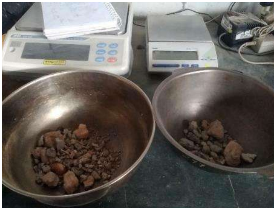
Fotografía 18: lavado del material para el ensayo de granulometría según ASTM D 422 agregando 10%, 20% y 30% de concreto en tres repeticiones cada uno.
