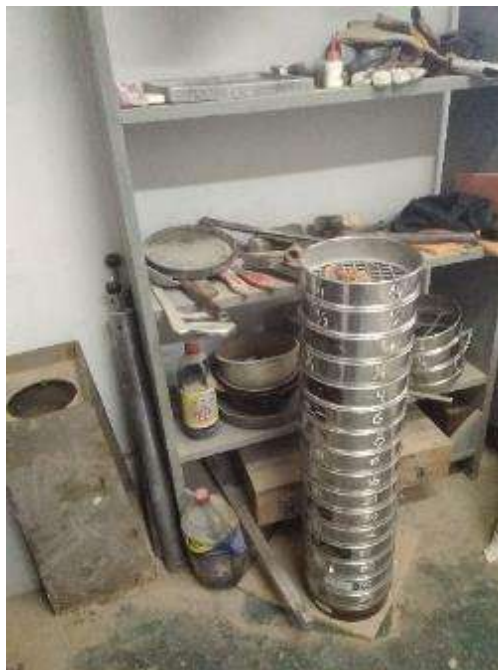
Fotografía 41: Pesado, lavado, secado y tamizado de material para el ensayo de granulometría según ASTM D 422 agregando 5% concreto + 5% ladrillo, 10% concreto + 10% ladrillo y 15% concreto + 15% ladrillo en tres repeticiones cada uno
