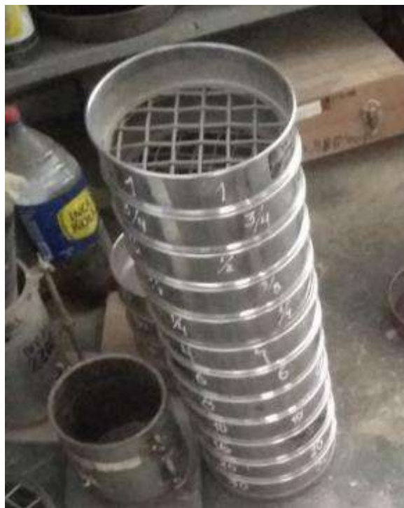
Fotografía 31: Tamizado del material según ASTM D 422 agregando 10%, 20% y 30% de residuos de ladrillo, en tres repeticiones cada uno.
