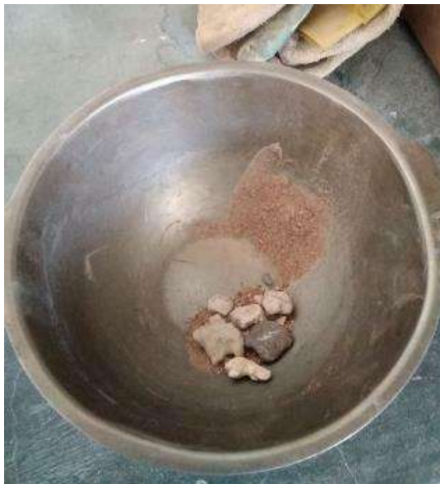
Fotografía 7: Lavado de material para el ensayo de granulometría del terreno natural, en tres repeticiones según ASTM D 422
