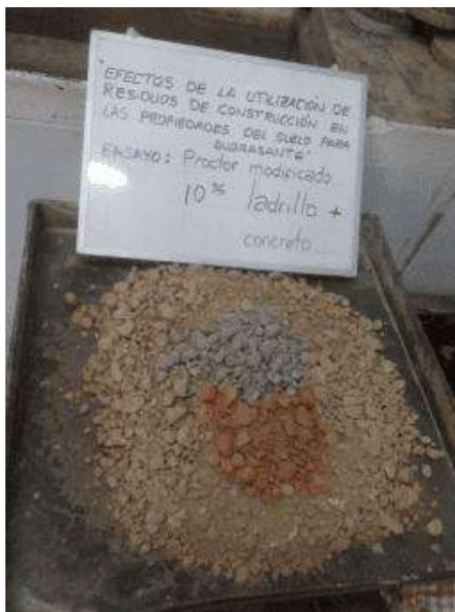
Fotografía 45: Ensayo de Próctor modificado según NTP 339.141 agregando 5% concreto + 5% ladrillo en tres repeticiones
