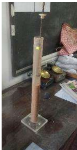
Fotografía 44: Ensayo de equivalente de arena del suelo según NTP 339.146:2000 agregando 5% concreto + 5% ladrillo, 10% concreto + 10% ladrillo y 15% concreto + 15% ladrillo en tres repeticiones cada uno
