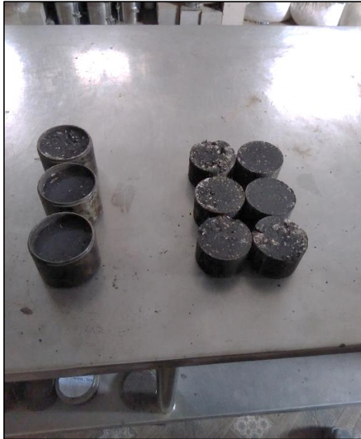
Fig. 44 Elaboración de briquetas. Fuente: Fotografía propia – Laboratorio Geo Test V. S.A.C.
