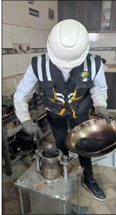
Fig. 42 Moldeo de la mezcla modificada. Fuente: Fotografía propia – Laboratorio Geo Test V. S.A.C.
