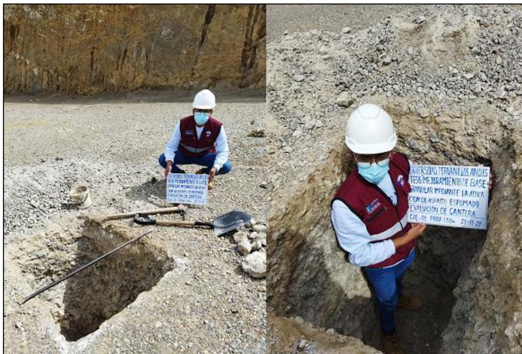
Fig. 16 Recolección del material granular de la Cantera Pumpunya Fuente: Fotografía propia
