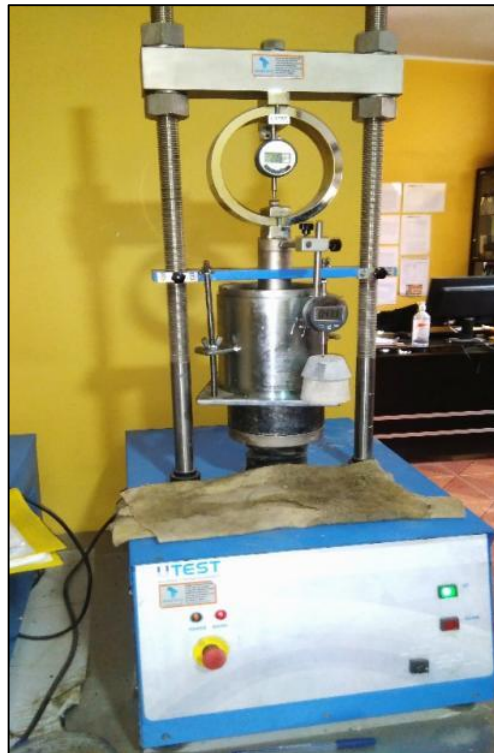
Fig. 41 Ensayo de CBR del material granular modificado con asfalto espumado. Fuente: Fotografía propia – Laboratorio Geo Test V. S.A.C.
