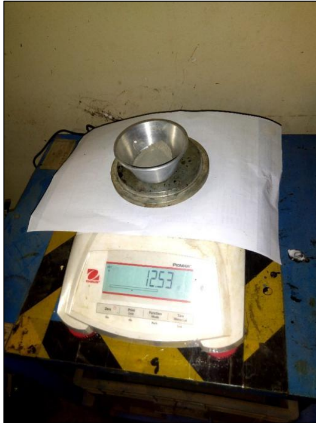
Fig. 34 Dosificación de Filler Activo (Cemento Portland). Fuente: Fotografía propia – Laboratorio Geo Test V S.A.C.
