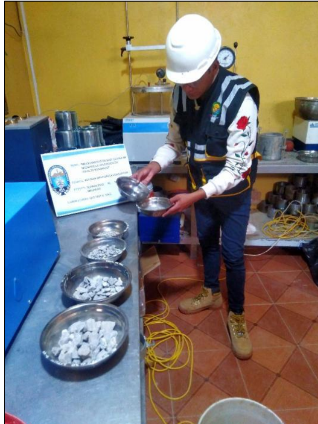
Fig. 26 Ensayo de durabilidad al sulfato de magnesio. Fuente: Fotografía propia – Laboratorio Geo Test V. S.A.C.
