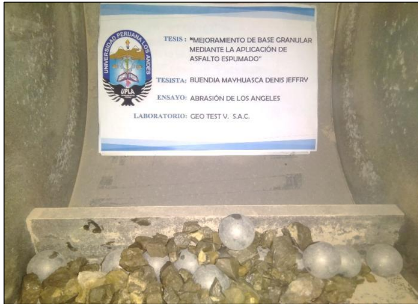
Fig. 21 Ensayo de Abrasión en la máquina de los Ángeles. Fuente: Fotografía propia – Laboratorio Geo Test V S.A.C.
