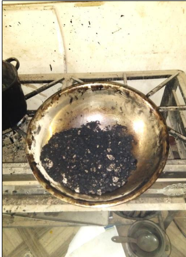
Fig. 40 Combinación de la mezcla y asfalto espumado. Fuente: Fotografía propia – Laboratorio Geo Test V. S.A.C.
