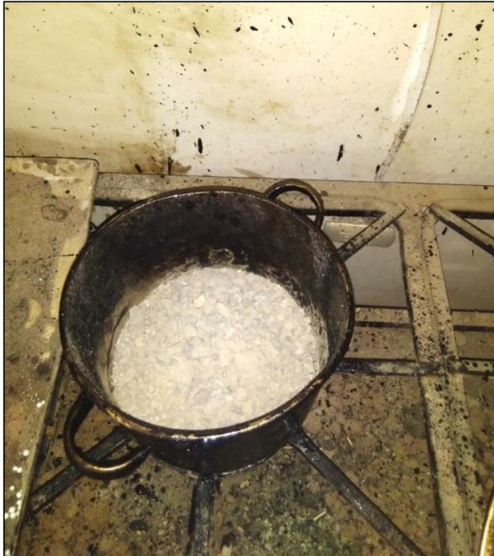
Fig. 36 Calentado de la mezcla del material granular con el filler activo. Fuente: Fotografía propia – Laboratorio Geo Test V. S.A.C.
