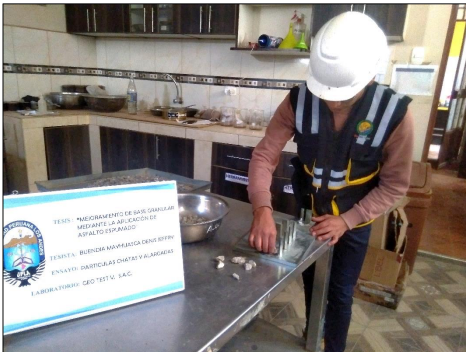
Fig. 22 Ensayo de partículas chatas y alargadas. Fuente: Fotografía Propia – Laboratorio Geo Test V. S.A.C.
