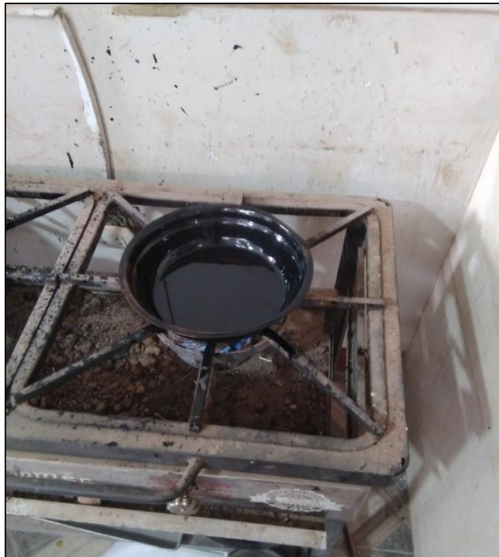
Fig. 37 Calentado del cemento asfáltico. Fuente: Fotografía propia – Laboratorio Geo Test V. S.A.C.
