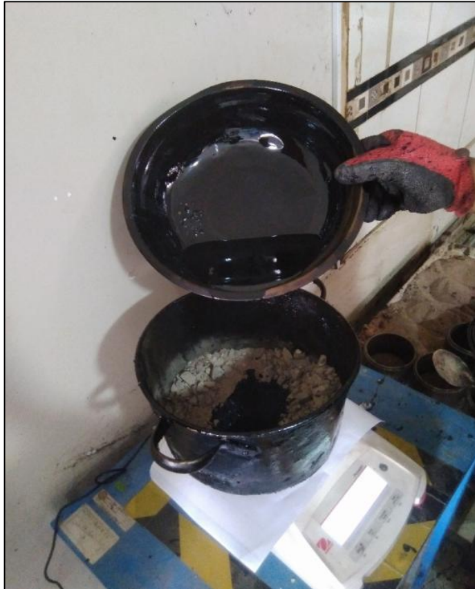
Fig. 38 Incorporación del cemento asfáltico.
