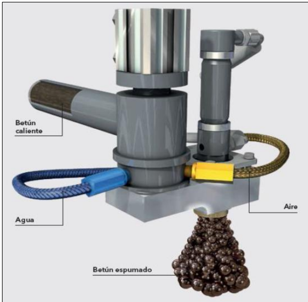
Fig. 9. Cámara de expansión de asfalto.
