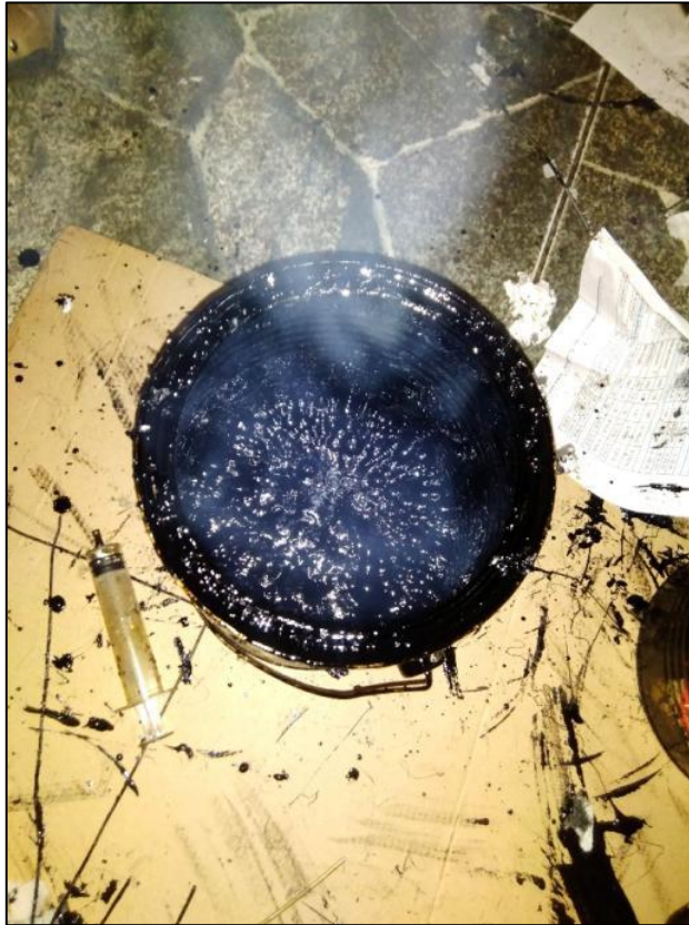
Fig. 31 Desarrollo del asfalto espumado. Fuente: Fotografía propia.
