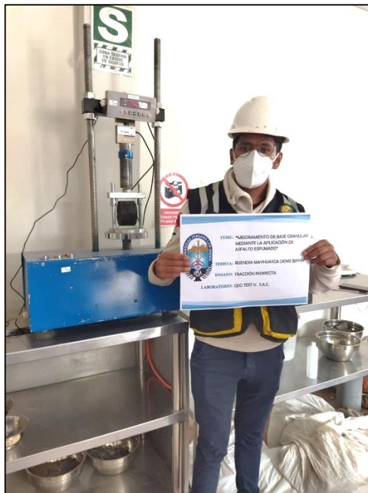
Fig. 45 Ensayo de tracción indirecta. Fuente: Fotografía propia – Laboratorio Geo Test V. S.A.C.
