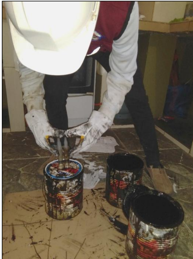
Fig. 30 Inyección de agua a 25°C al cemento asfáltico caliente. Fuente: Fotografía propia.
