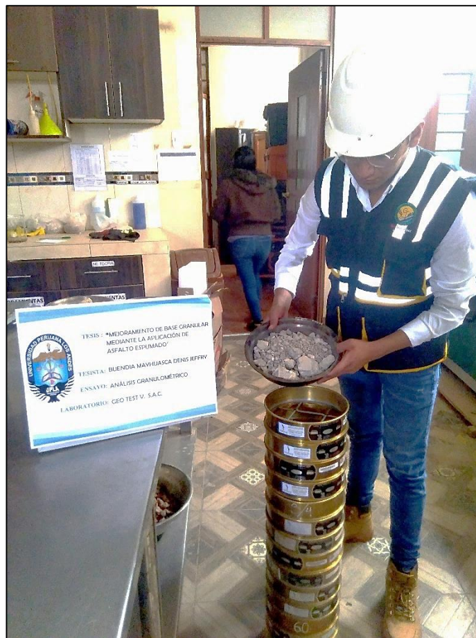
Fig. 17 Análisis granulométrico del material granular. Fuente: fotografía propia - Laboratorio Geo Test V S.A.C
