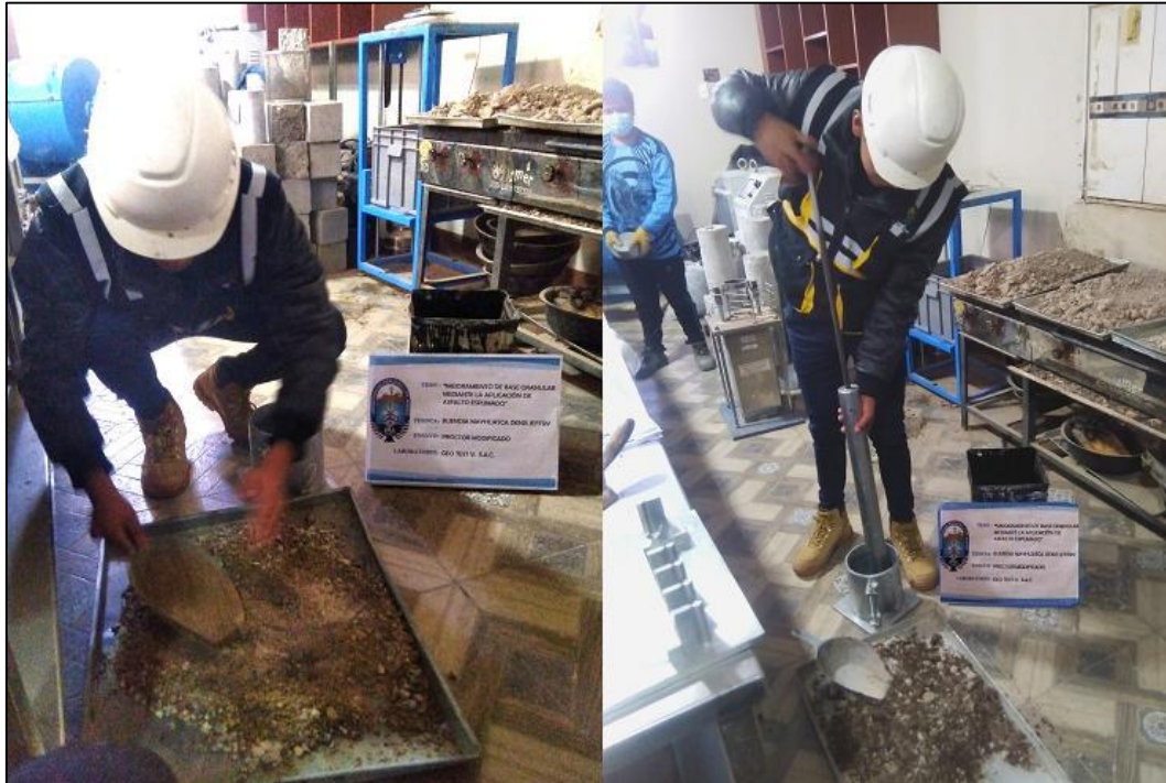
Fig. 27 Ensayo Proctor modificado. Fuente: Fotografía propia – Laboratorio Geo Test V S.A.C.
