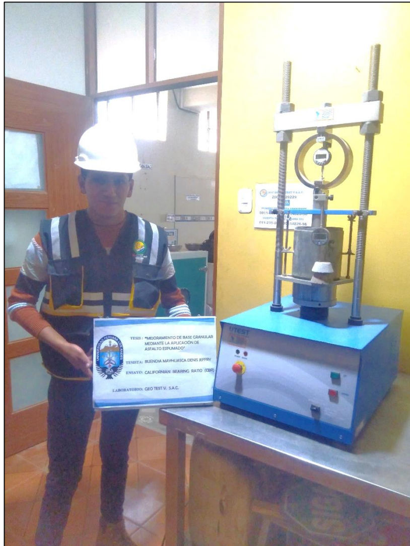
Fig. 28 Ensayo de CBR del material granular. Fuente: Fotografía propia – Laboratorio Geo Test V S.A.C.
