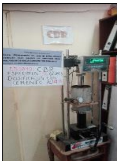
Fotografía 15. Compresión de muestras de suelo con 14 % de cemento mediante el ensayo de CBR, según la norma NTP 339.145.
