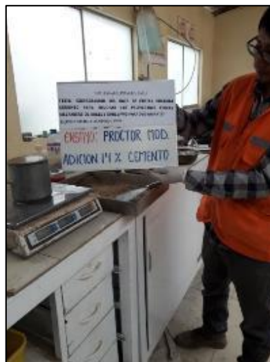
Fotografía 9. Preparación de la mezcla de suelo más 14 % de cemento para realizar el ensayo de Proctor modificado aplicando la metodología de la norma MTC E 115 y NTP 339.141.
