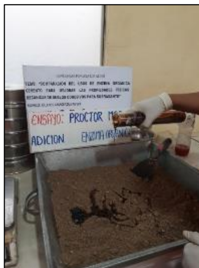
Fotografía 12. Preparación de la mezcla de suelo más enzima orgánica para realizar el ensayo de Proctor modificado aplicando la metodología de la norma MTC E 115 y NTP 339.141.
