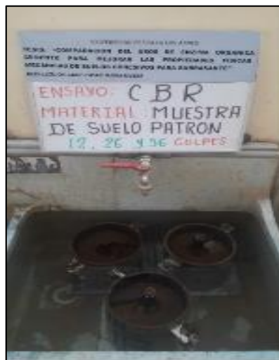
Fotografía 14. Vista de la realización del ensayo CBR de la muestra patrón, de acuerdo a la norma NTP 339.145.
