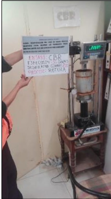
Fotografía 16. Compresión de muestras de suelo con 20 % de cemento mediante el ensayo de CBR, según la norma NTP 339.145.
