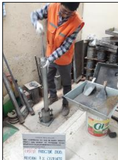
Fotografía 8. Compactación del suelo con 7 % de cemento aplicando la metodología de la norma MTC E 115 y NTP 339.141.
