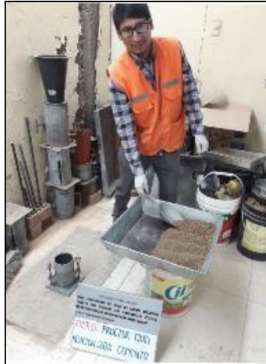
Fotografía 10. Compactación del suelo con 7 % de cemento aplicando la metodología de la norma MTC E 115 y NTP 339.141.
