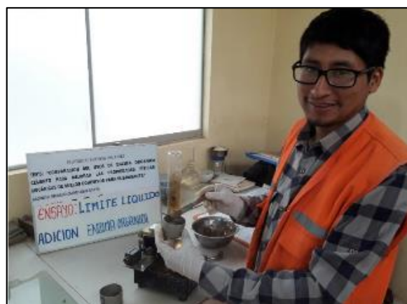
Fotografía 6. Desarrollo del ensayo del límite líquido del suelo con adición de enzima orgánica, en base a la norma NTP 339.129.
