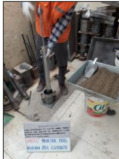
Fotografía 11. Compactación del suelo con 20 % de cemento aplicando la metodología de la norma MTC E 115 y NTP 339.141.
