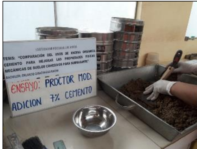
Fotografía 7. Preparación de la mezcla de suelo más 7 % de cemento para realizar el ensayo de Proctor modificado de acuerdo a la norma NTP 339.141 y MTC 115.
