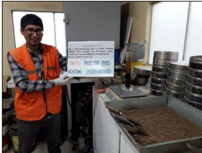
Fotografía 13. Vista del material utilizado para la ejecución del ensayo de Proctor modificado del suelo con enzima orgánica con la metodología de la norma MTC E 115 y NTP 339.141.
