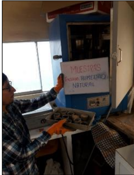
Fotografía 4. Determinación del contenido de humedad natural de acuerdo a la norma NTP 339.127.
