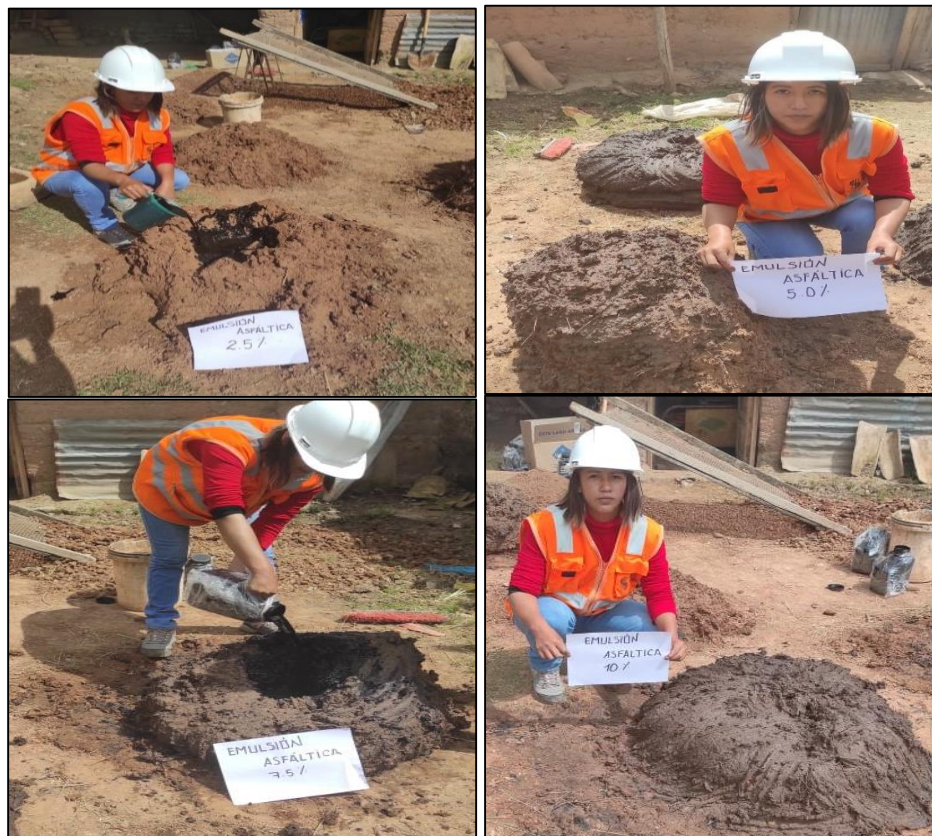
Figura 29: Preparación del barro con emulsión asfáltica (2.5%, 5%, 7.5%, 10%)
