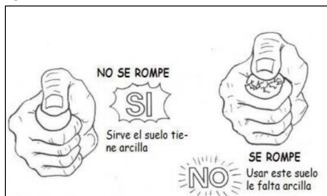
Figura 10: PRUEBA DE “RESISTENCIA SECA”
