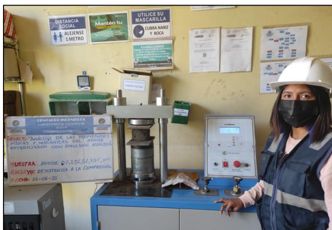
Figura 38: Desarrollo del ensayo de Resistencia a la compresión
