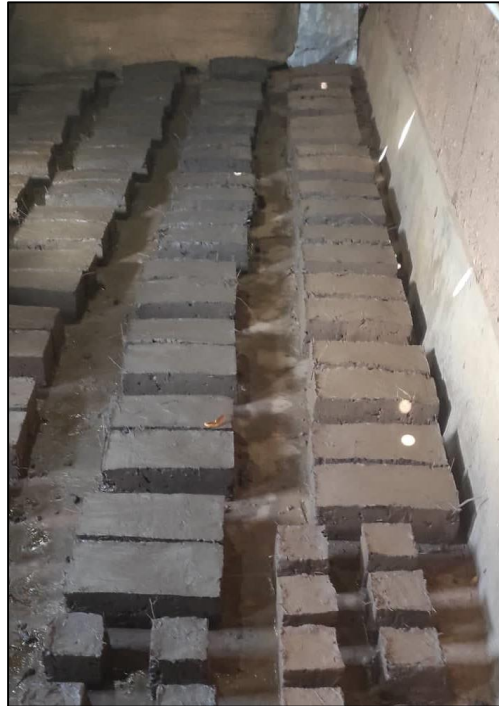
Figura 28: Moldeo de los especímenes
