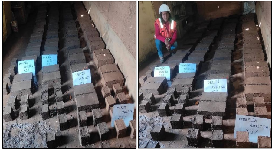
Figura 30: Moldeo y secado de los adobes con emulsión asfáltica (2.5%, 5%, 7.5%, 10%)
