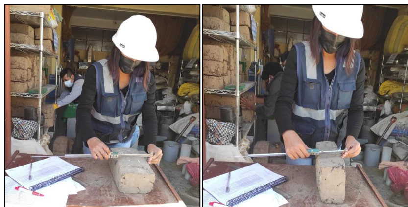
Figura 33: Ensayo de Variabilidad Dimensional
