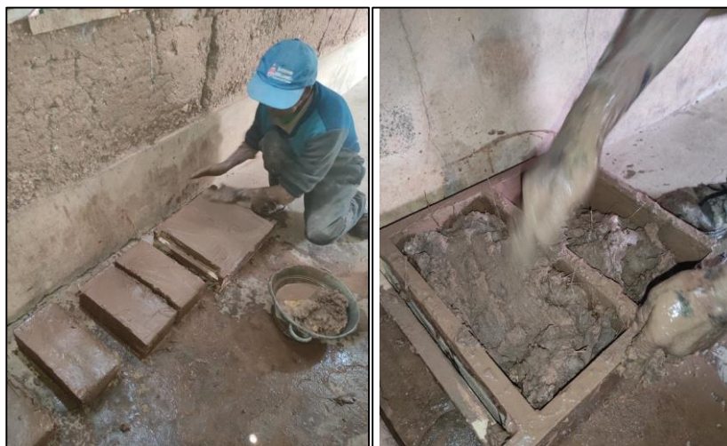
Figura 27: Moldeo de los especímenes
