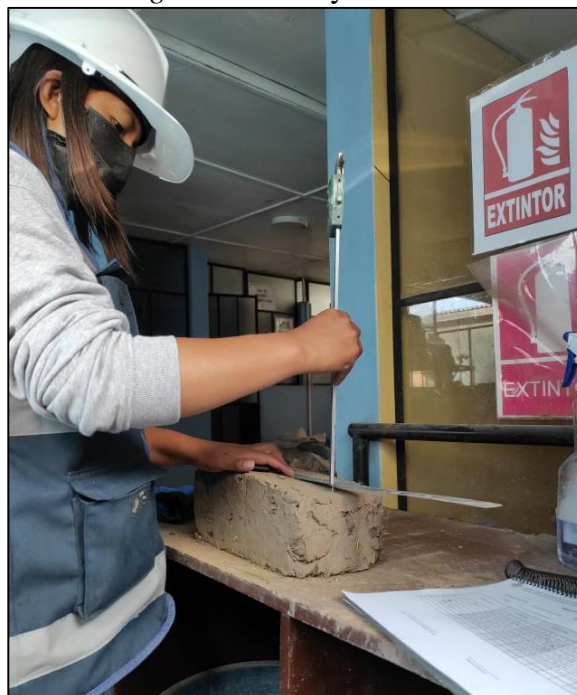
Figura 32: Ensayo de alabeo
