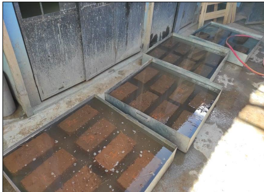
Figura 35: Saturación de unidades de adobe
