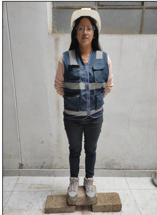
Figura 31: Control de calidad de los adobes
