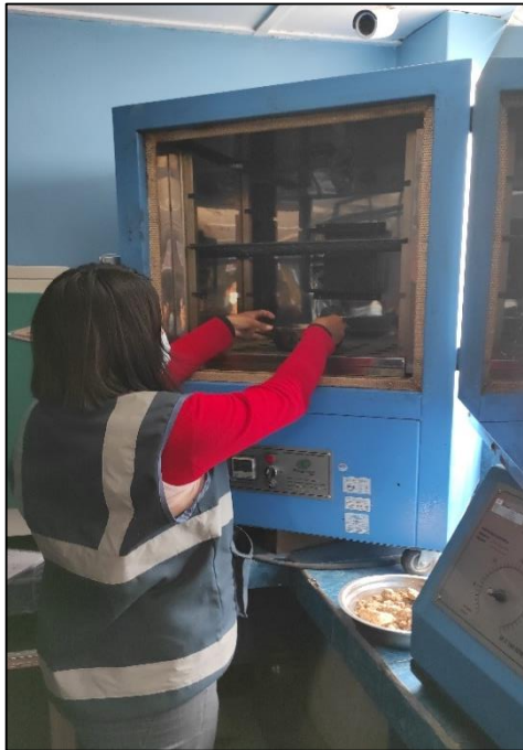
Figura 20: Secado de la muestra en el horno
