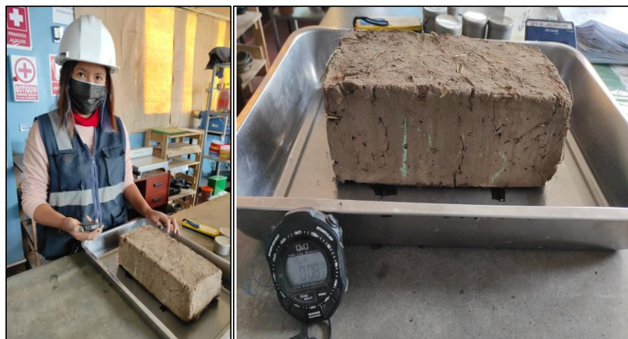
Figura 34: Ensayo de Succión
