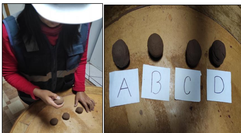
Figura 17: Desarrollo de la prueba de Presencia de arcilla
