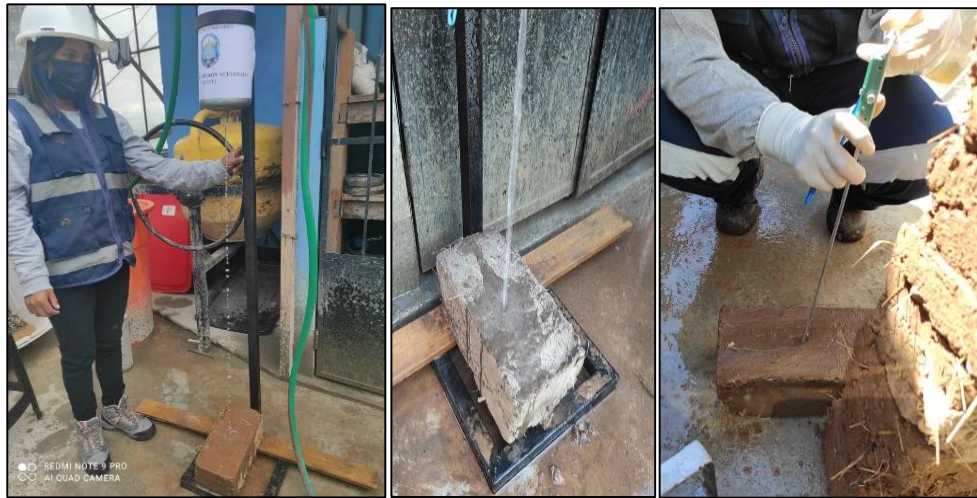
Figura 37: Desarrollo del ensayo de Erosión Acelerada
