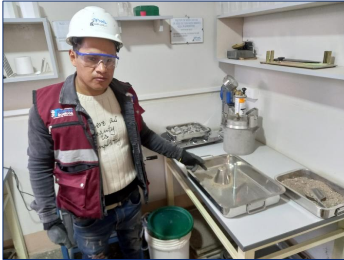
Figura 33. Determinación de la absorción del agregado fino.
