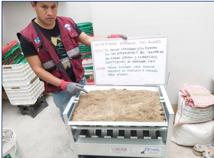
Figura 27. Cuarteo del agregado fino.
