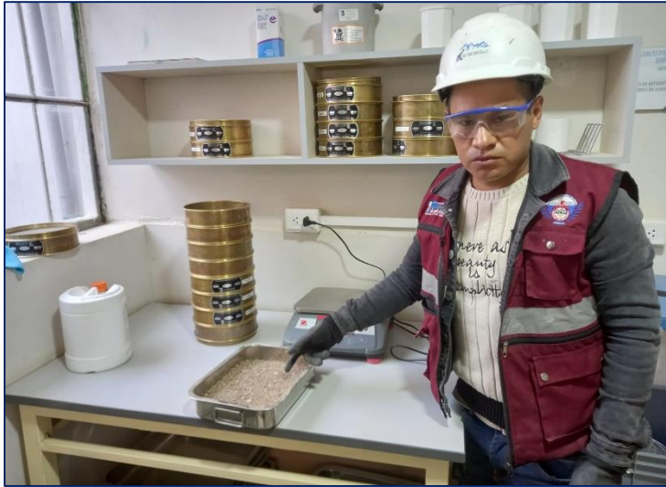
Figura 30. Ensayo de granulometría del agregado fino.
