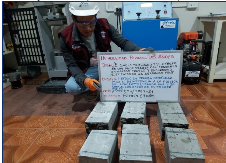
Figura 58. Rotura de las viguetas del concreto patrón.
