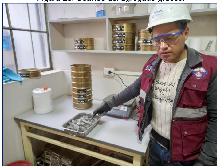
Figura 29. Ensayo de granulometría del agregado grueso.
