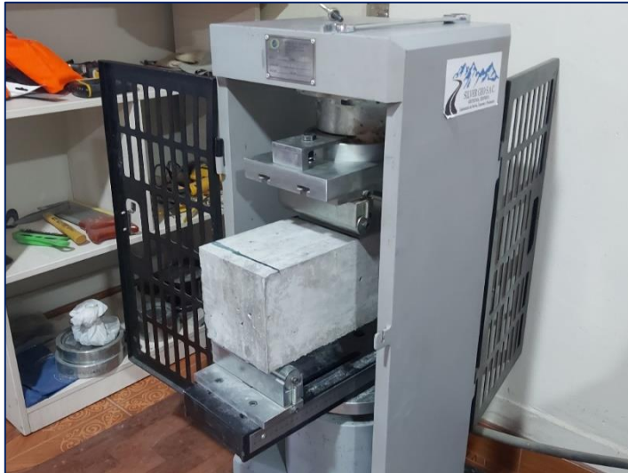
Figura 61. Rotura de las viguetas en la máquina de compresión.
