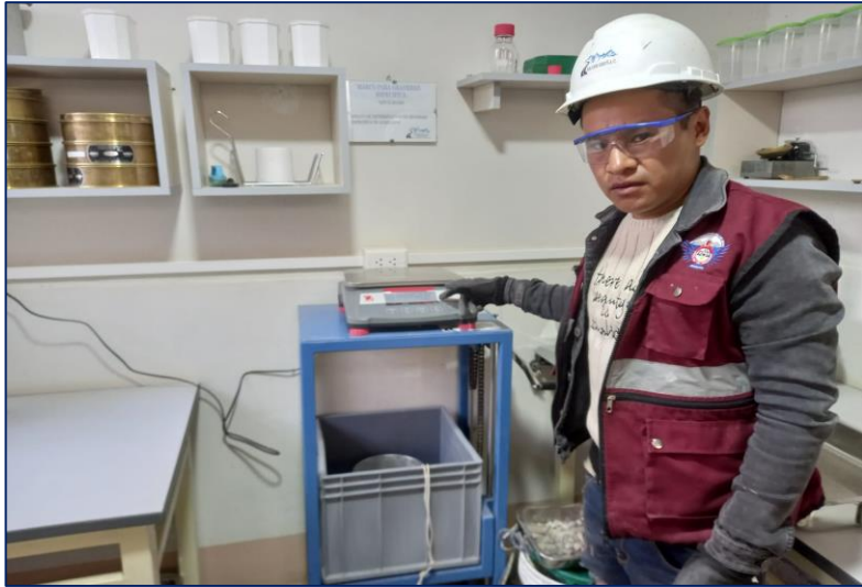
Figura 36. Determinación del peso específico del agregado grueso.
