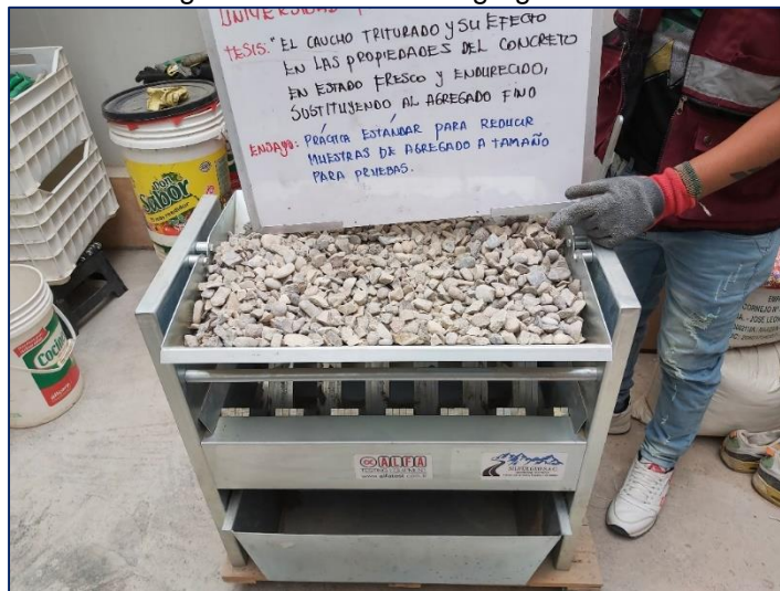
Figura 28. Cuarteo del agregado grueso.
