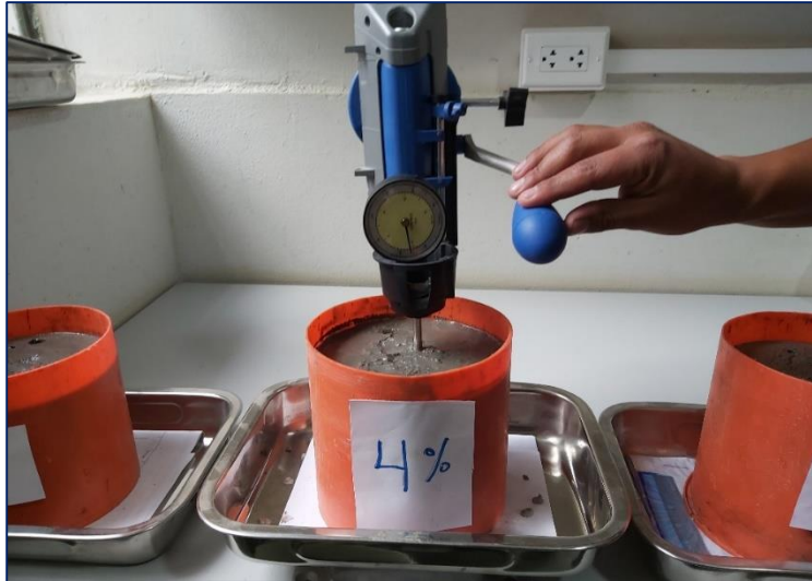
Figura 54. Ensayo del tiempo de fragua del concreto con caucho triturado.
