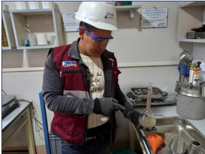
Figura 34. Determinación del peso específico del agregado fino.
