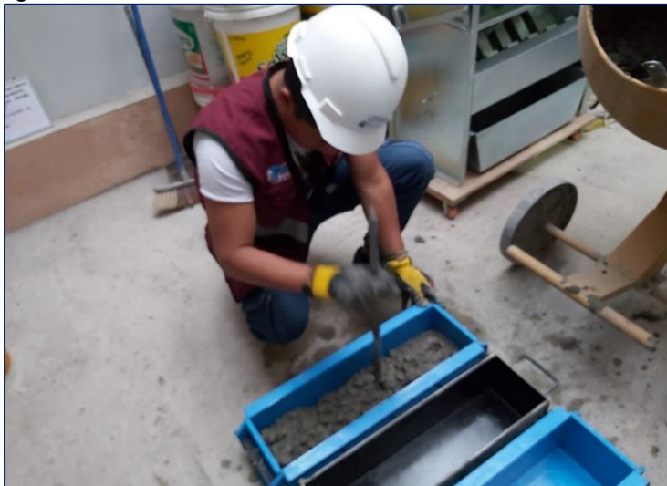
Figura 43. Preparación de vigas de concreto patrón.
