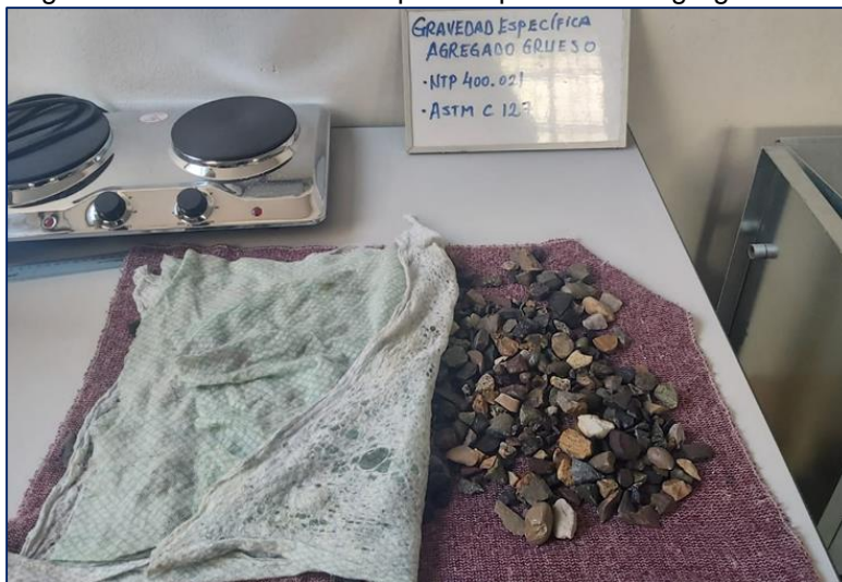
Figura 35. Determinación de la absorción del agregado grueso.
