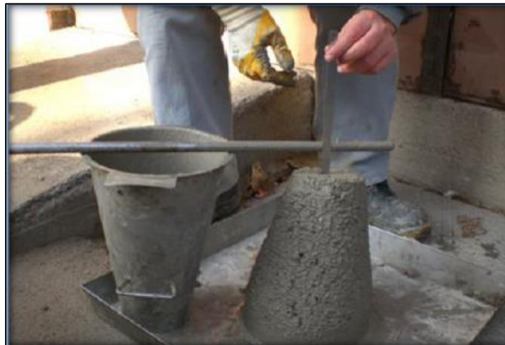
Figura 3. Medición del asentamiento del concreto. Fuente: Chinchano (2020).
