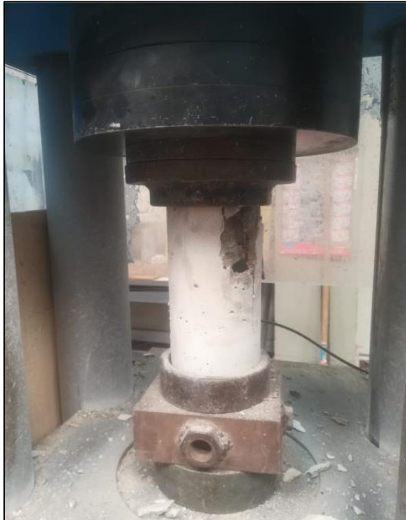
Figura 4. Vista del ensayo para determinar la resistencia a compresión del concreto. Fuente: Flores y Aguila (2018).
