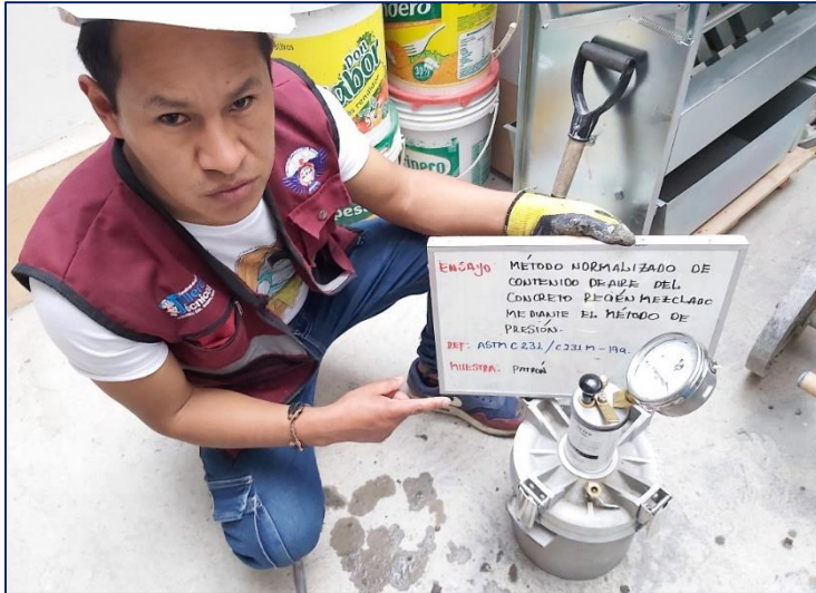
Figura 45. Determinación del contenido de aire en el concreto.
