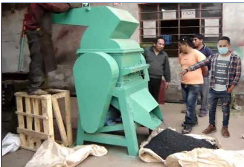
Figura 38. Proceso de trituración del caucho reciclado.
