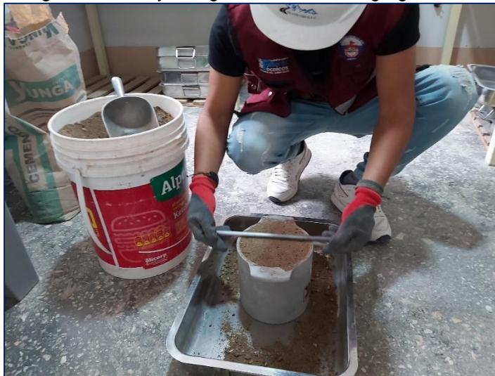
Figura 31. Determinación de peso unitario compactado del agregado fino.
