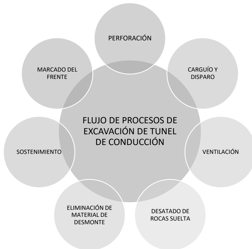
Figura 27- Flujo de procesos de la excavación del túnel de conducción – Hidroeléctrica Cerro del Águila.
