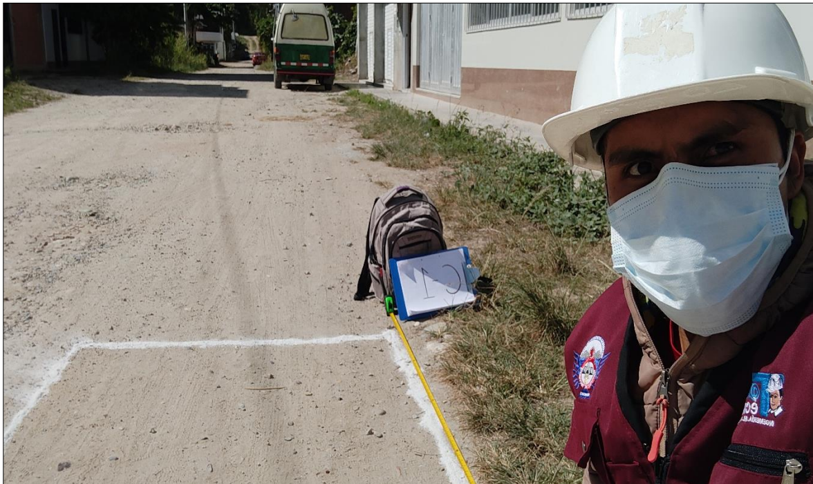
Fotografía 11: Calicata para el Estudio y Ensayo de Mecánica de Suelos.
