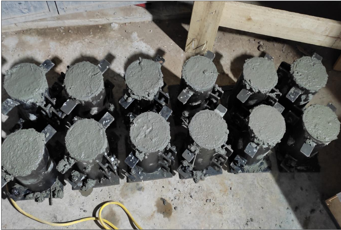
Fotografía 27: Especímenes de Muestra Patrón con adición del 1.5% de Fibra de Guadua.
