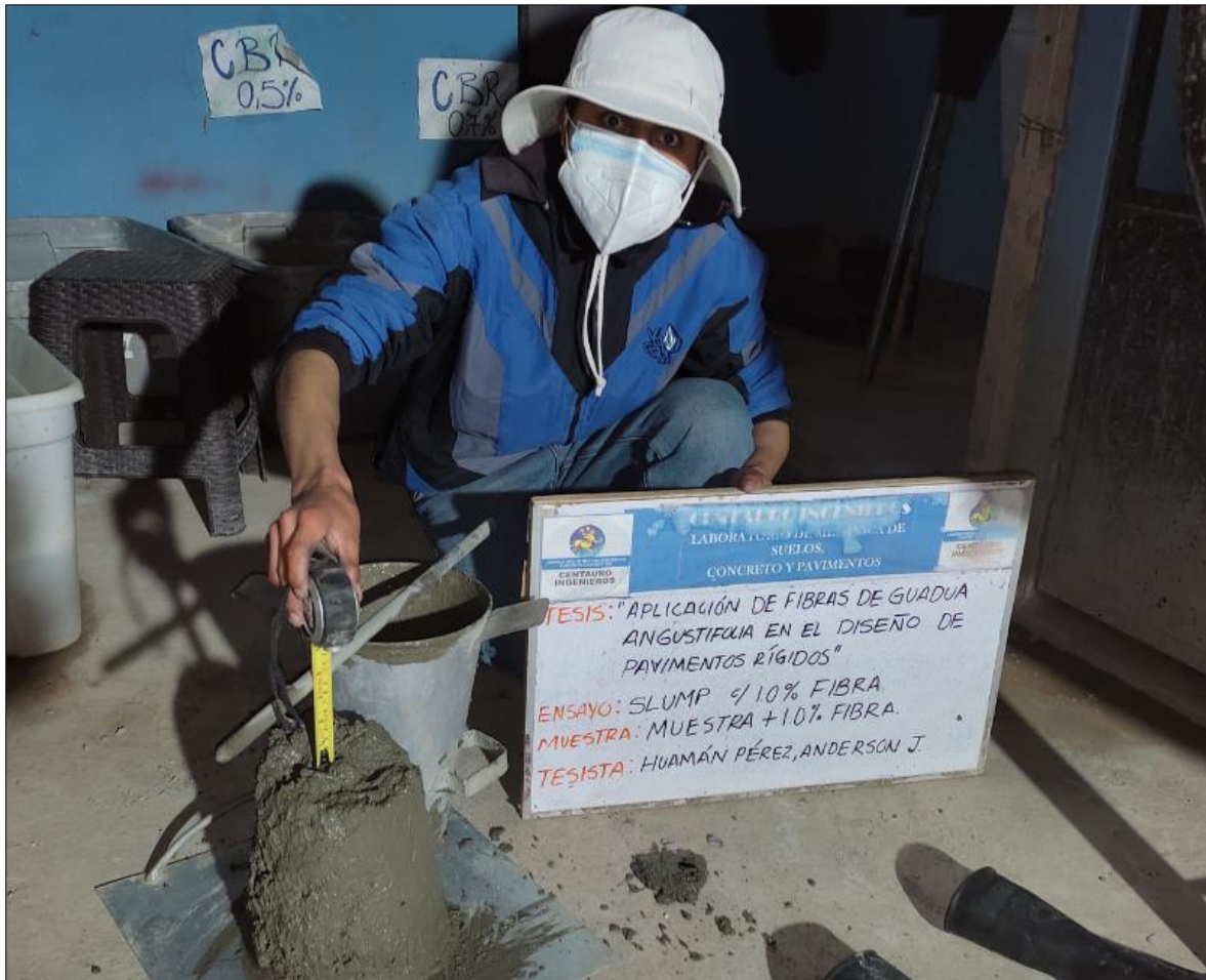
Fotografía 29: Slump de la Muestra Patrón con adición del 1.0% de Fibra de Guadua.
