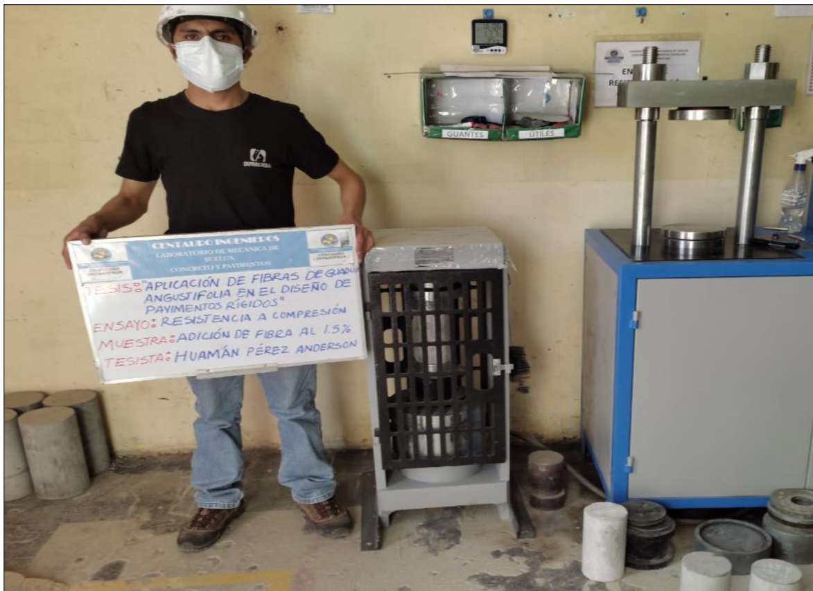
Fotografía 32: Resistencia a Compresión de la Muestra Patrón con Adición del 1.5% de Fibra, ensayada a la edad de 28 Días.
