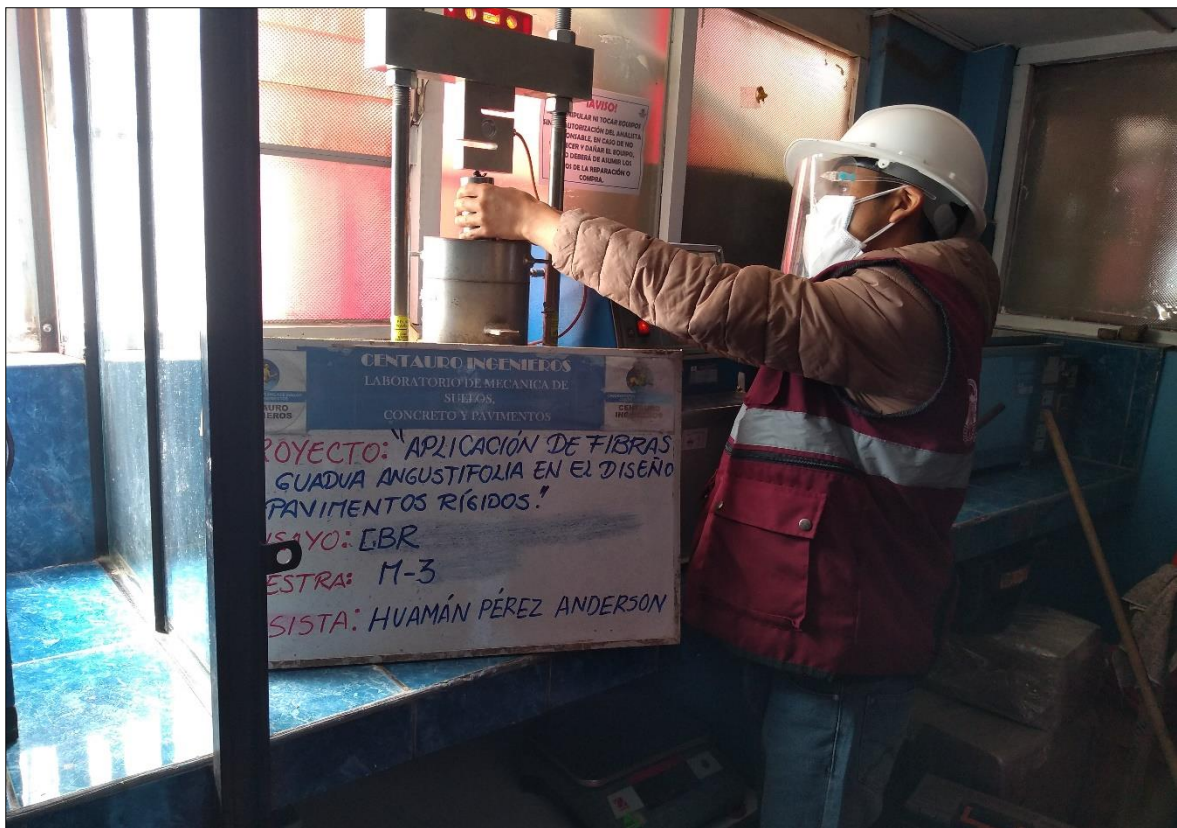
Fotografía 20: Ensayo de CBR.
