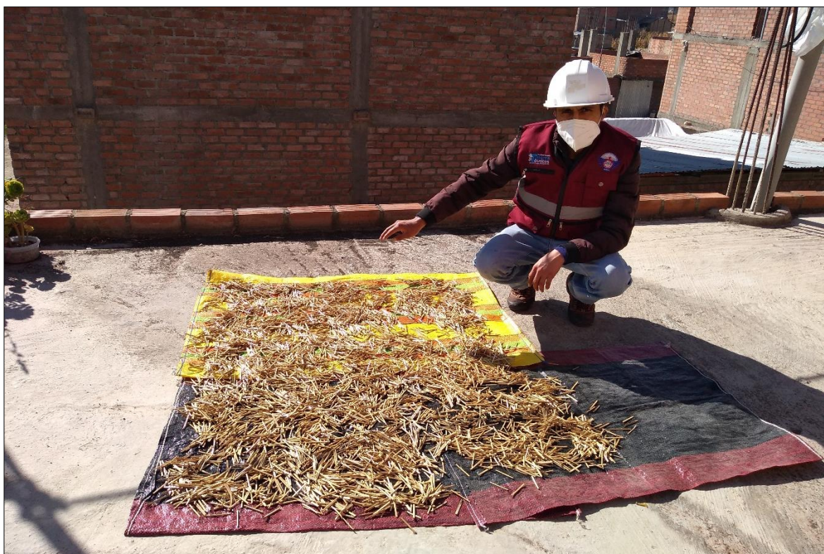
Fotografía 7: Secado de fibras de Guadua Angustifolia, por 24 Horas, luego de ser impermeabilizados, de dimensiones 2mm x 2mm x 5cm.
