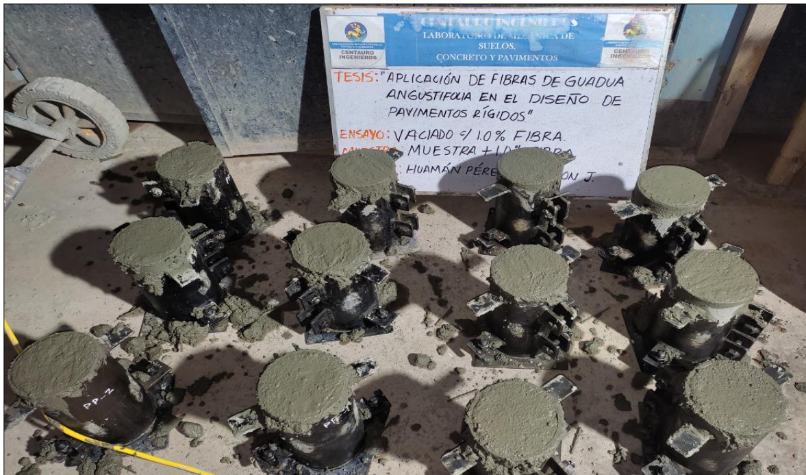
Fotografía 30: Especímenes de Muestra Patrón con adición del 1.0% de Fibra de Guadua.
