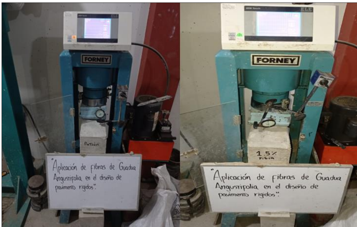
Fotografía 33: Muestras Sometidas a Ensayo de Flexotracción (Módulo de Rotura), ensayada a los 28 Días.
