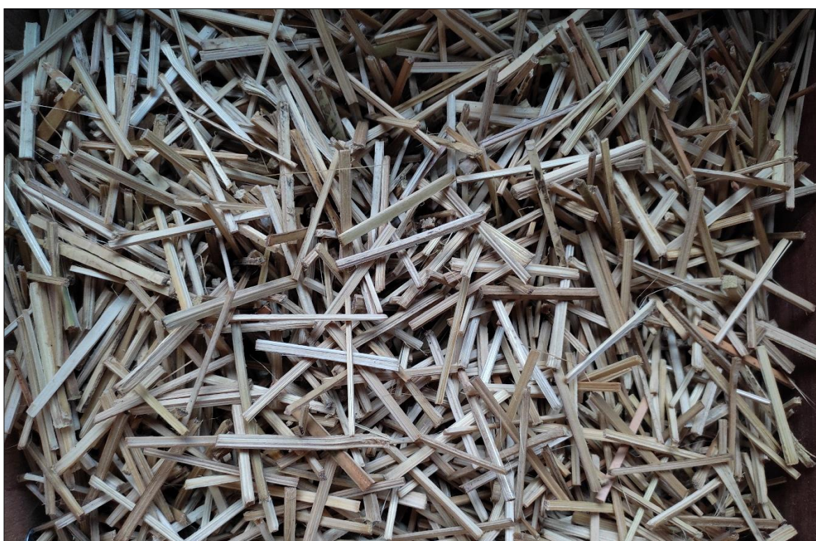
Fotografía 8: Obtención de fibras de Guadua Angustifolia, de dimensiones 2mm x 2mm x 5cm.
