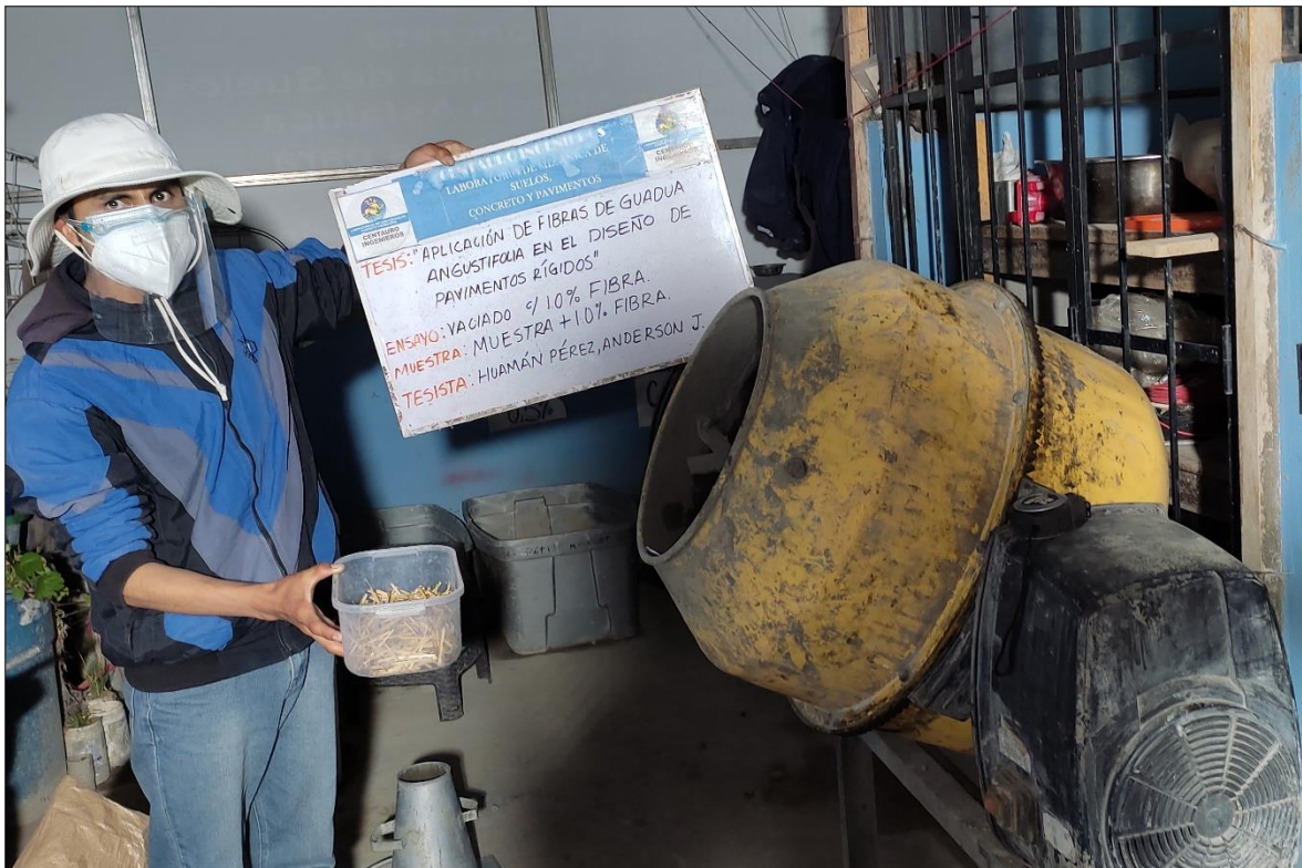
Fotografía 28: Vaciado de Muestra Patrón con adición del 1.0% de Fibra de Guadua Angustifolia.
