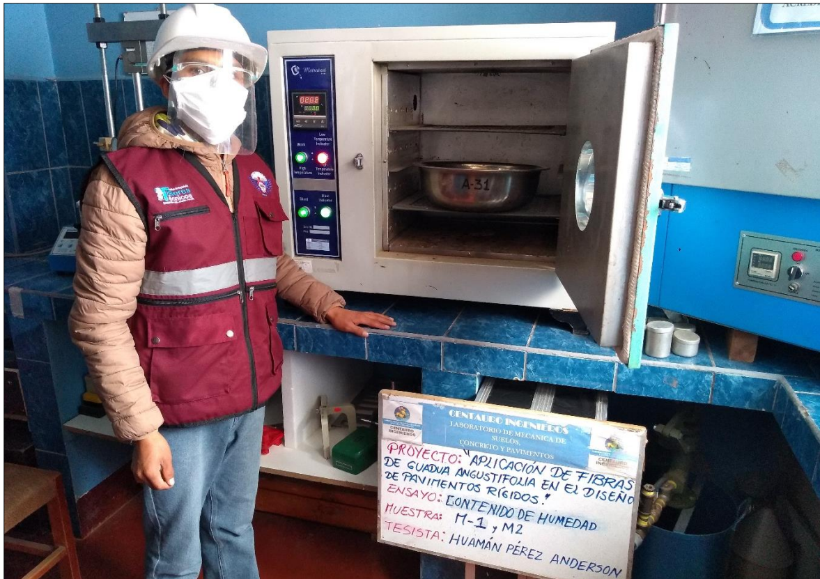
Fotografía 19: Ensayo de Contenido de Humedad.
