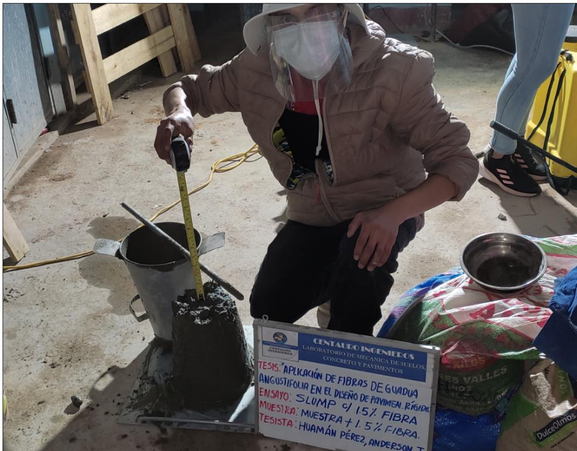
Fotografía 26: Slump de la Muestra Patrón con adición del 1.5% de Fibra de Guadua.
