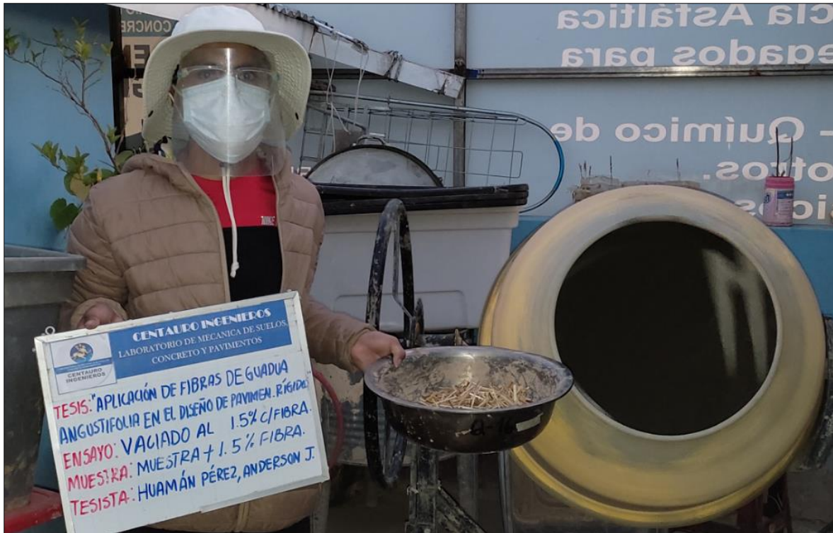
Fotografía 25: Vaciado de la Muestra Patrón con adición del 1.5% de Fibra de Guadua.
