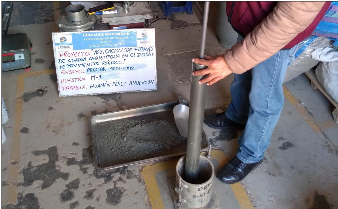
Fotografía 23: Ensayo de Proctor Modificado.
