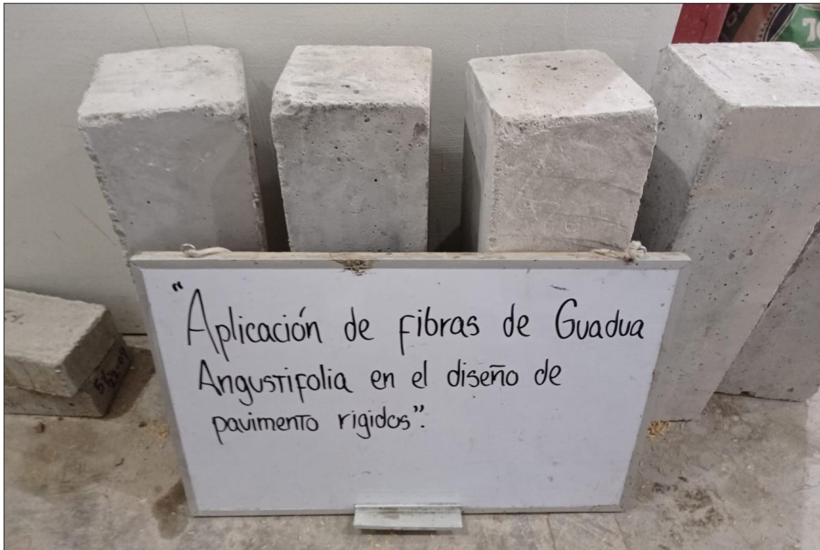
Fotografía 33: Muestras de Viga Patrón.
