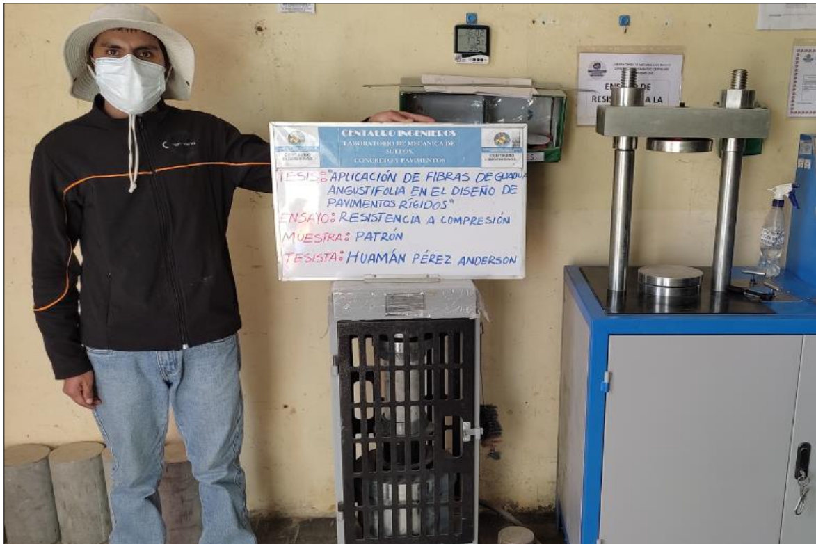
Fotografía 31: Resistencia a Compresión de la Muestra Patrón a la edad de 28 Días.
