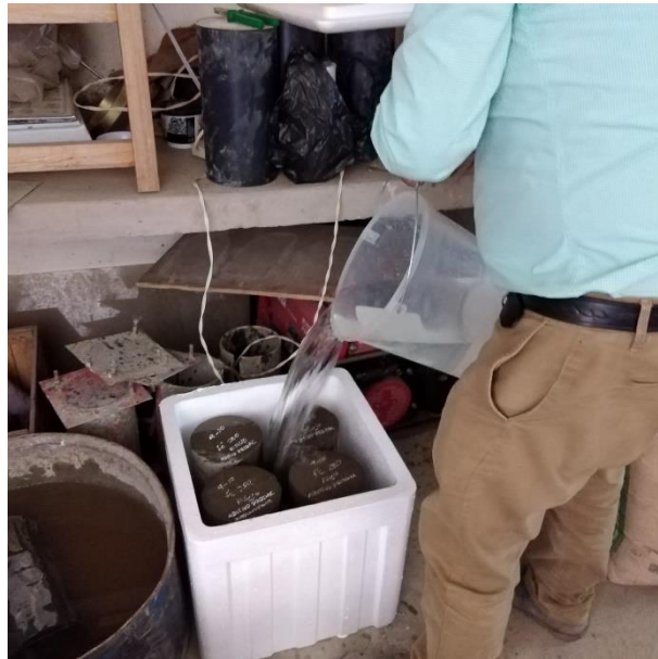
Foto 1.- Probetas de ensayo para medir la resistencia
