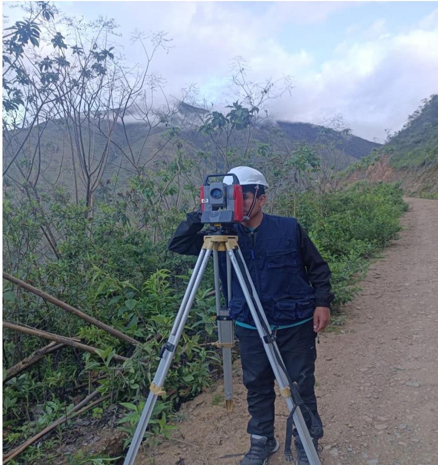
Figura N° 05: Toma de puntos topográficos en el kilómetro 4+ 000.
