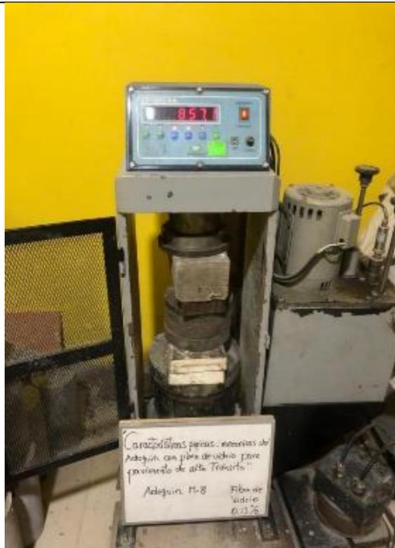
**Vista 19: Ensayo A Compresión De La Muestra M-8**
