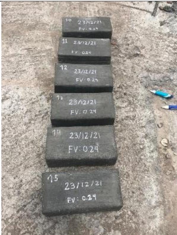
**Vista 14:** Desencofrado de adoquín y colocación los datos de la muestra.
