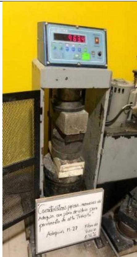
**Vista 26: Ensayo A Compresión De La Muestra M-27**
