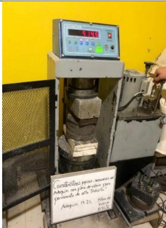
**Vista 25: Ensayo A Compresión De La Muestra M-26**
