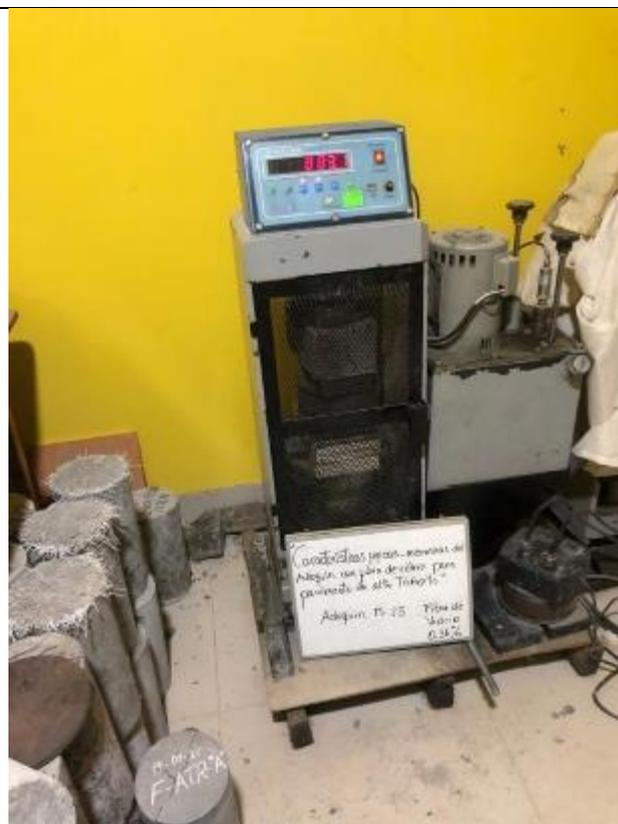
**Vista 24: Ensayo A Compresión De La Muestra M-25**
