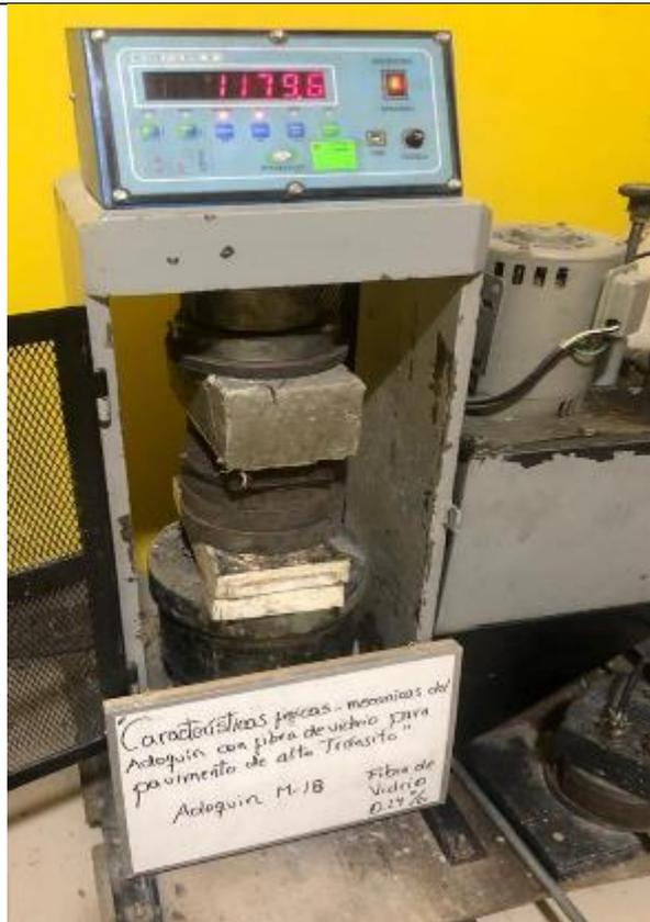
**Vista 23: Ensayo A Compresión De La Muestra M-18**
