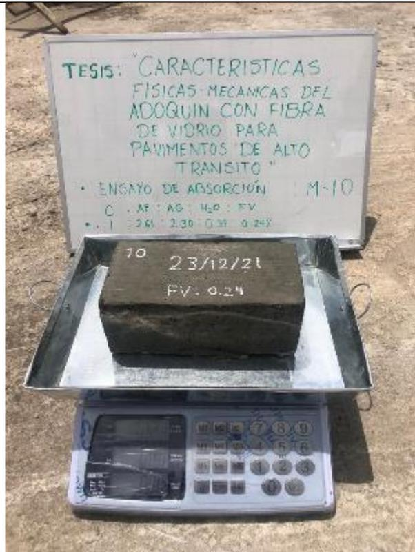
**Vista 15:** Ensayo de absorción y peso de adoquín M-10.
