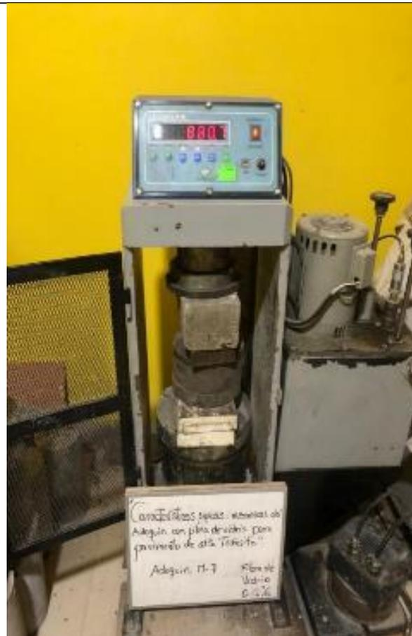
**Vista 18: Ensayo A Compresión De La Muestra M-7**
