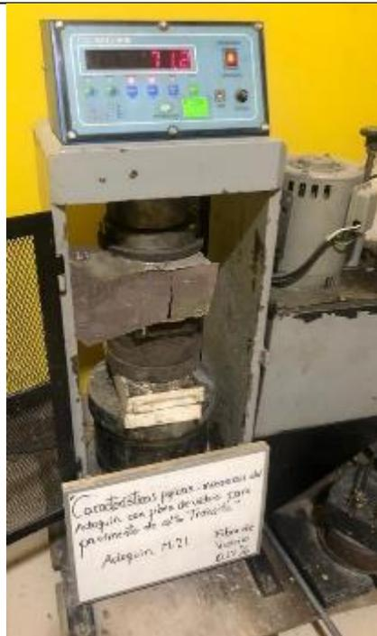
**Vista 17: Ensayo a flexión de la muestra M-21**
