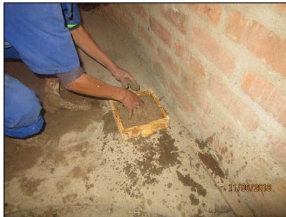
Gráfico 42. Proceso de colocación de la mezcla en el molde
