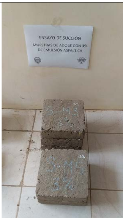
Muestras con incorporación de 3% y 5% de emulsión asfáltica para ensayo de succión
