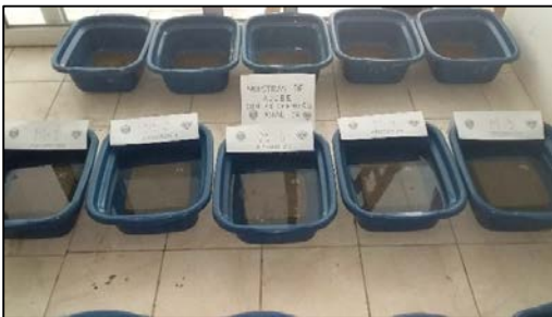
Gráfico 67. Ensayo de absorción – unidades de adobe con 3% emulsión asfáltica
