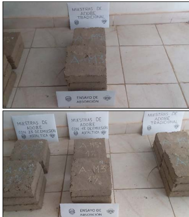
Muestras con incorporación de 0% y 1% de emulsión asfáltica para ensayo de absorción
