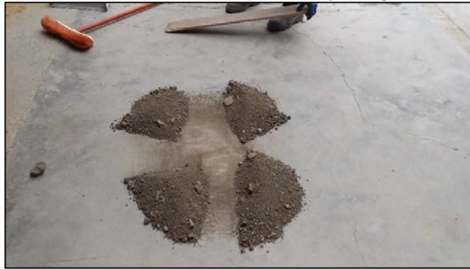
Gráfico 51. Proceso de cuarteo para ensayo de granulometría
