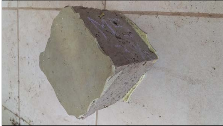
Gráfico 61. Refrentado de la superficie de muestra
