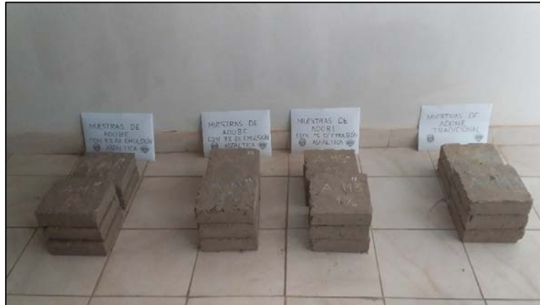
Gráfico 57. Muestras preparadas para ensayo de absorción
