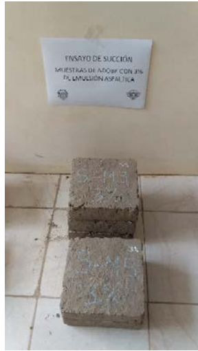
Gráfico 55. Muestra 3% emulsión asfáltica - Succión
