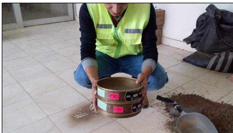
Gráfico 59. Tamizado de material por la malla N° 100
