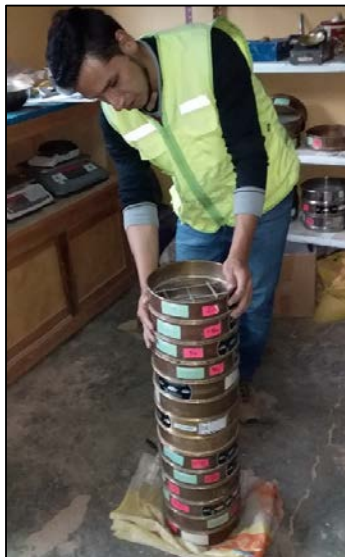
Gráfico 52. Proceso de tamizado
