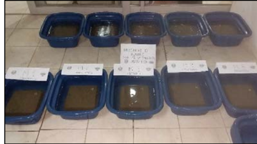
Gráfico 66. Ensayo de absorción – unidades de adobe con 1% emulsión asfáltica
