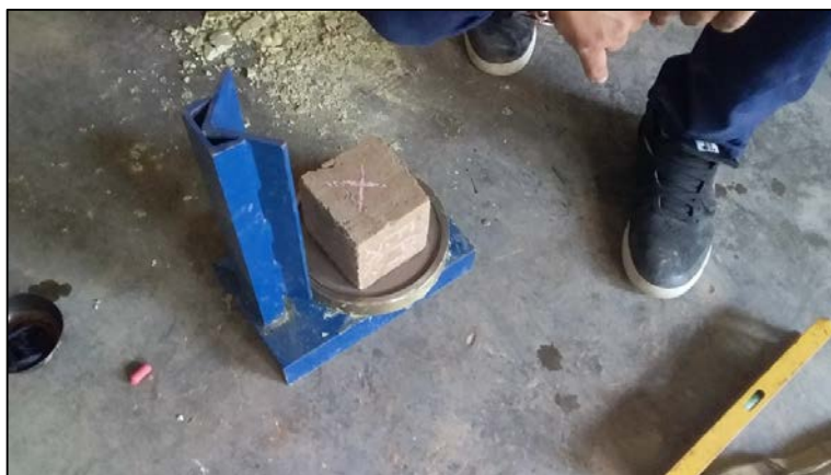
Gráfico 60. Refrentado de la superficie de muestra
