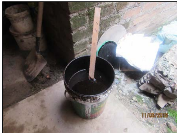
Gráfico 44. Emulsión asfáltica de rotura rápida
