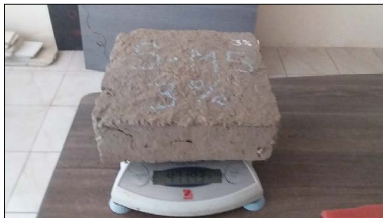
Gráfico 57. Pesado de muestras ensayo succión antes del ensayo
