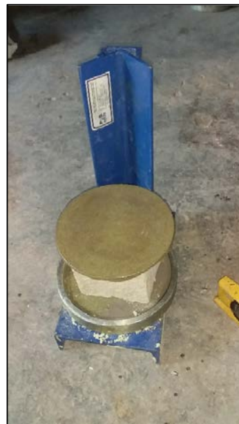
Refrentado de muestras con azufre y material pasante de la malla N° 100
