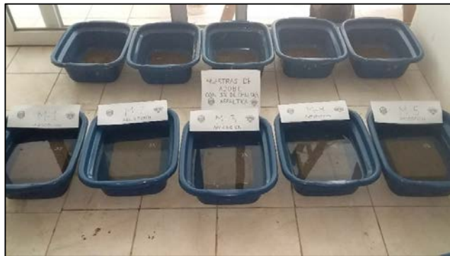
Muestras sumergidas con 0% y 1% de emulsión asfáltica (ensayo absorción)
