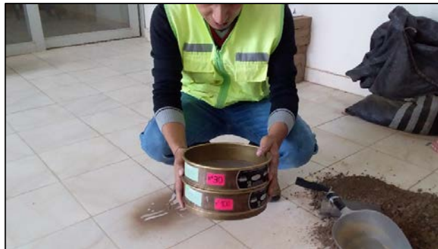
Tamizado de suelo con el materia pasante de la malla N°100 para refrentado de las muestras
