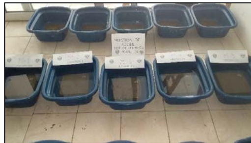
Gráfico 68. Ensayo de absorción – unidades de adobe con 5% emulsión asfáltica
