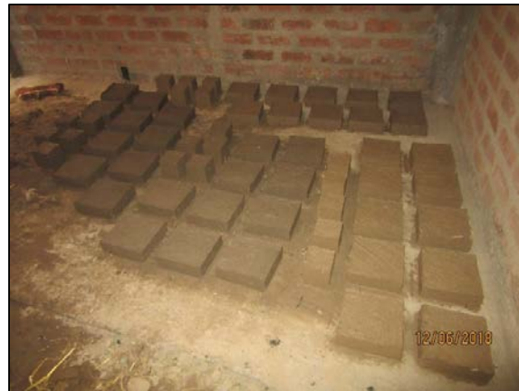
Gráfico 49. Unidades de adobe tradicional y con incorporación de emulsión asfáltica al 1%,3% y 5%
