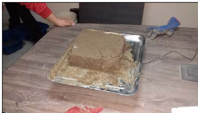
Pesado de las muestras de con 1% de emulsión asfáltica después de la inmersión (24 horas)
