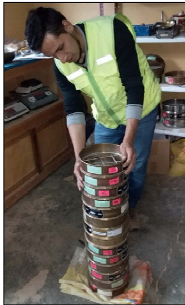
Proceso de tamizado de muestra
