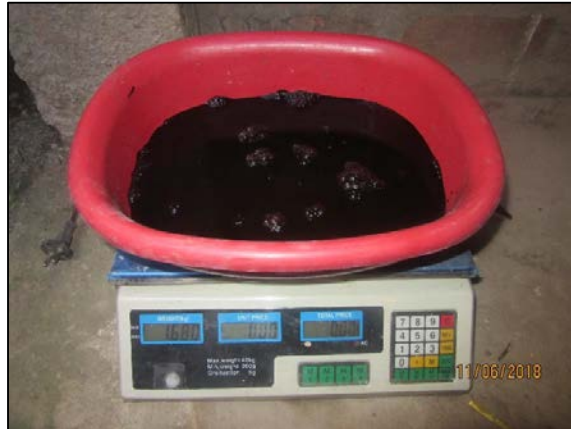
Gráfico 45. Pesado de la emulsión asfáltica
