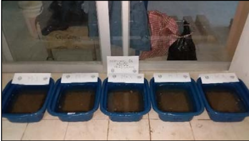
Gráfico 65. Ensayo de absorción – unidad de albañilería de adobe tradicional
