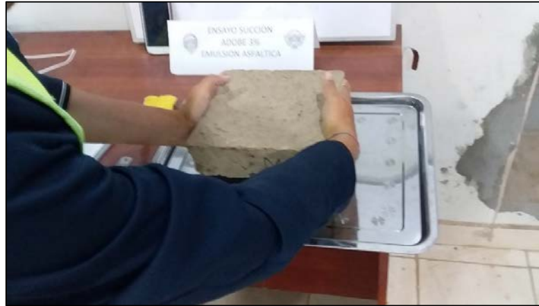
Gráfico 59. Colocado de muestras para ensayo de succion
