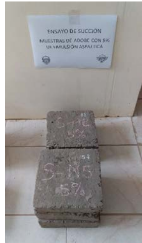
Gráfico 56. Muestra 5% emulsión asfáltica – succión
