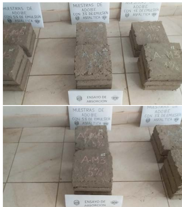
Muestras con incorporación de 3% y 5% de emulsión asfáltica para ensayo de absorción
