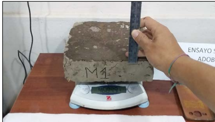
Gráfico 56. Peso de la unidad después del ensayo de succión
