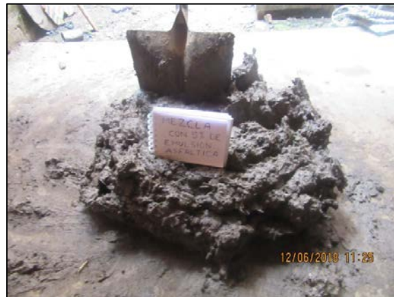
Gráfico 48. Mezcla con 5% de emulsión asfáltica
