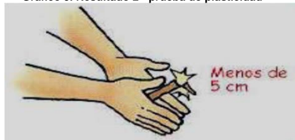
Gráfico 9. Resultado 2 - prueba de plasticidad
