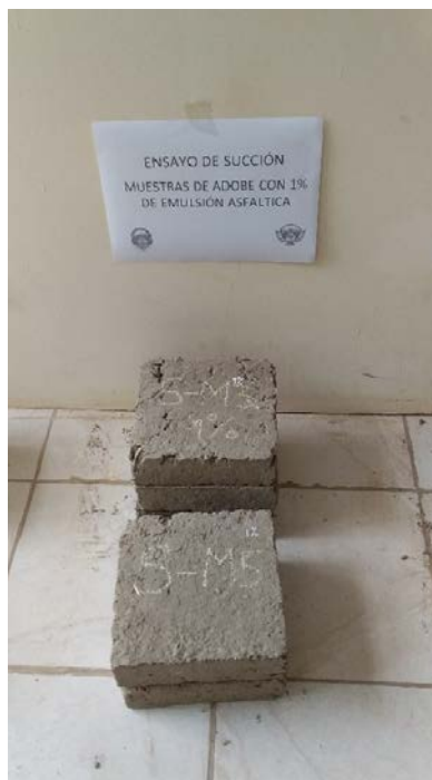
Muestras con incorporación de 0% y 1% de emulsión asfáltica para ensayo de succión
