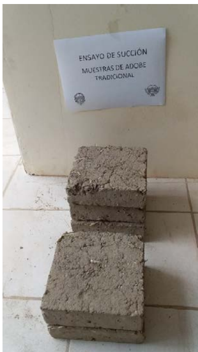
Muestras con incorporación de 0% y 1% de emulsión asfáltica para ensayo de succión
