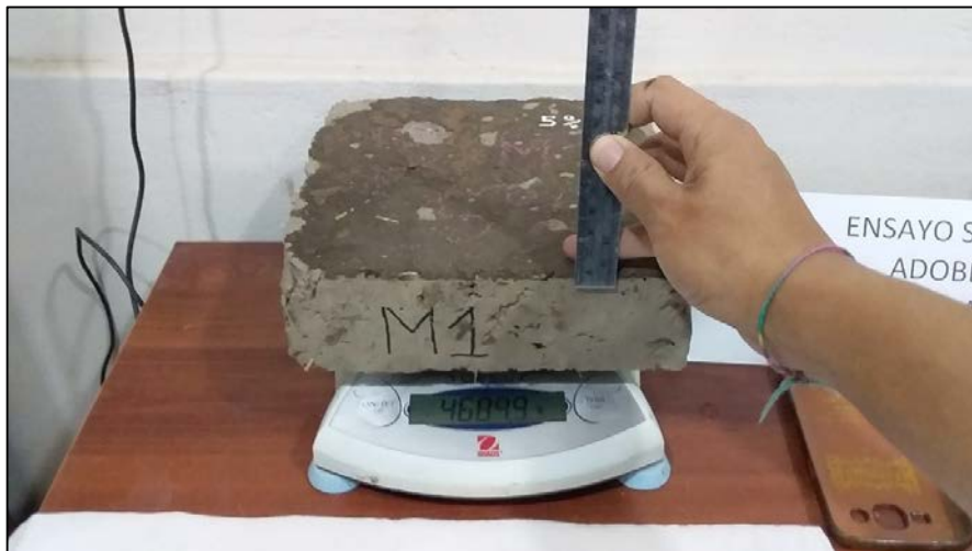
Pesado de la muestra después del secado superficial
