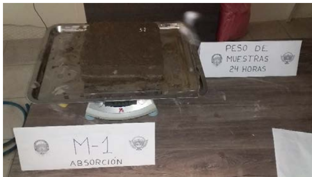
Pesado de las muestras de con 3% de emulsión asfáltica después de la inmersión (24 horas)
