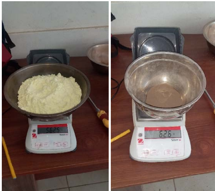
Pesado de proporciones de azufre y material pasante malla N° 100
