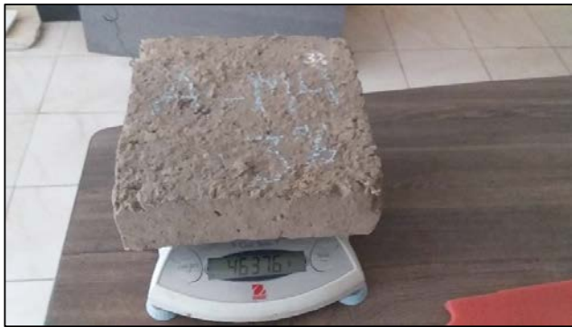
Pesado de muestras para ensayo de absorción
