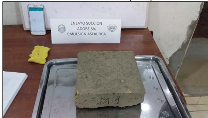
Gráfico 54. Prueba de succión (1 min)
