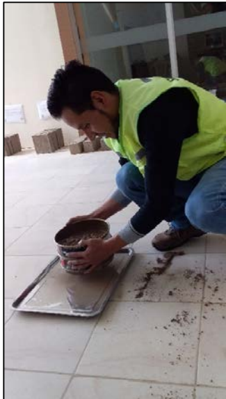
Tamizado de suelo con el materia pasante de la malla N°100 para refrentado de las muestras
