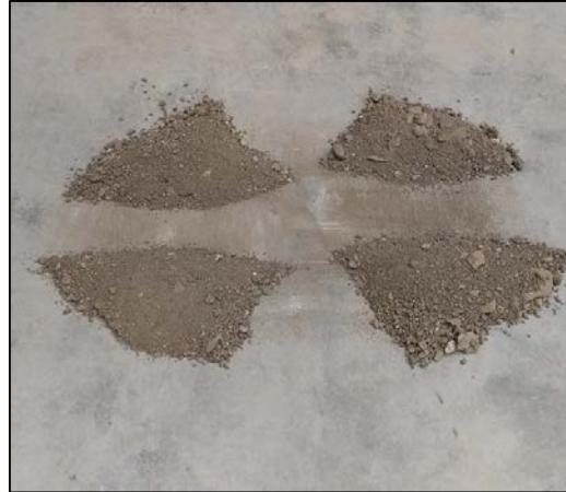
Selección de muestra y cuarteo para ensayo de granulometría
