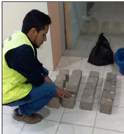
Gráfico 58. Muestras para ensayo resistencia a la compresión
