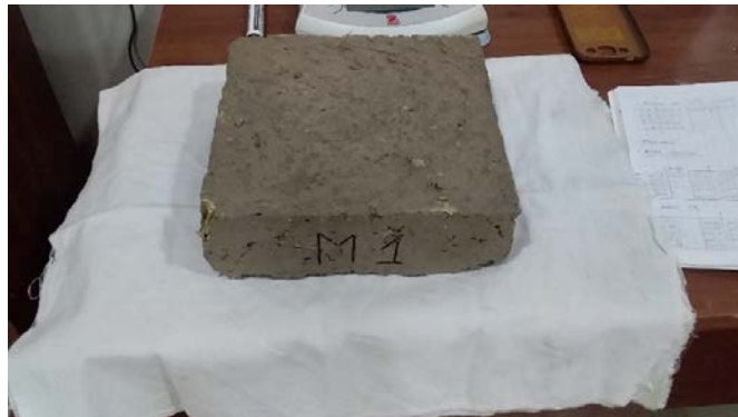
Gráfico 55. Secado de la muestra
