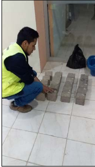
Muestras totales para ensayo de resistencia a la compresión
