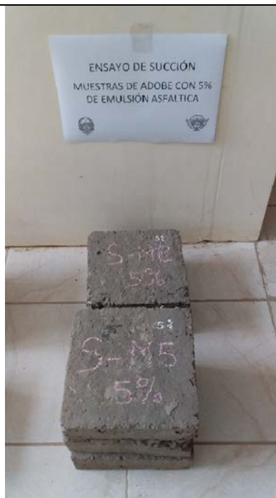
Muestras con incorporación de 3% y 5% de emulsión asfáltica para ensayo de succión
