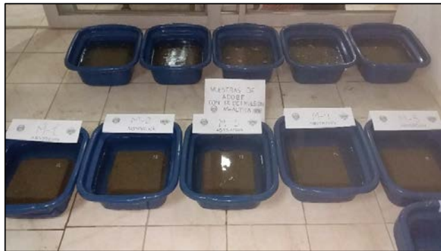
Muestras sumergidas con 0% y 1% de emulsión asfáltica (ensayo absorción)
