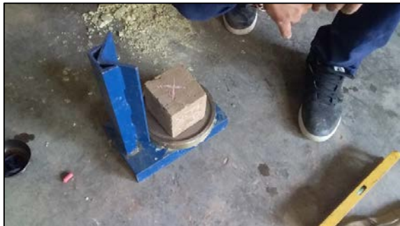
Refrentado de muestras con azufre y material pasante de la malla N° 100
