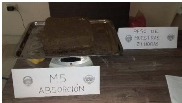
Pesado de las muestras de con 3% de emulsión asfáltica después de la inmersión (24 horas)
