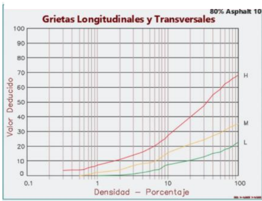
Figura 18. Curvas de valores deducidos - grieta longitudinales y transversales.
