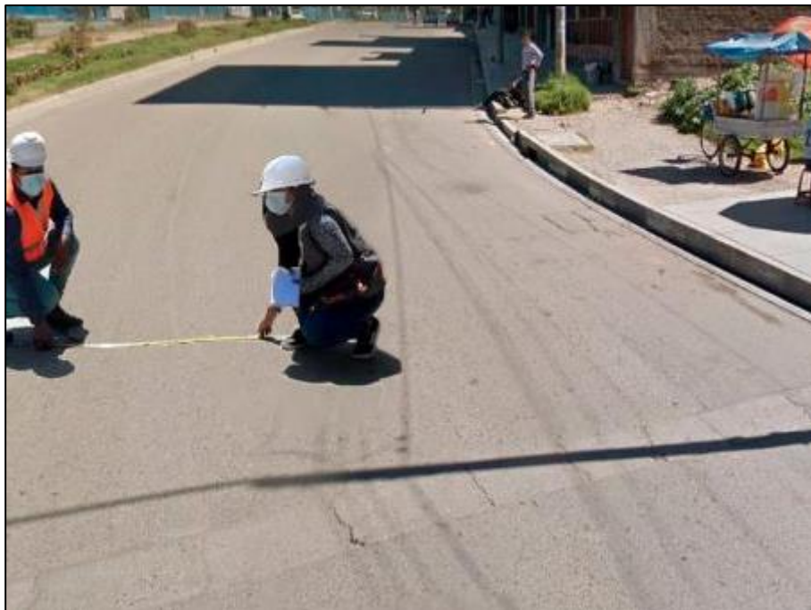
Figura 46, Grietas longitudinales y ahuellamiento en el carril izquierdo Av. Huancavelica progresiva 0+229.8 – 0+268.1
