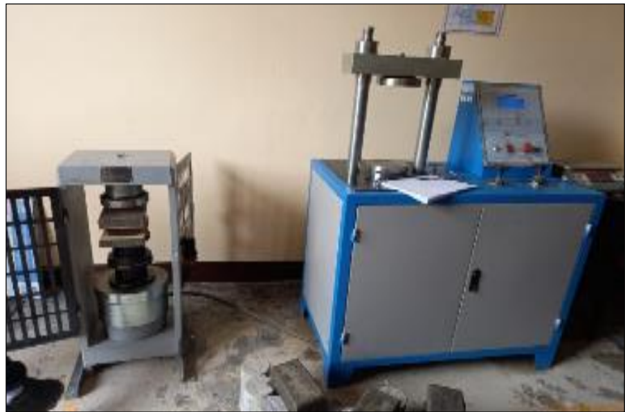
Figura 30. Máquina del ensayo de resistencia a la compresión , Por elaboración propia,2021.
