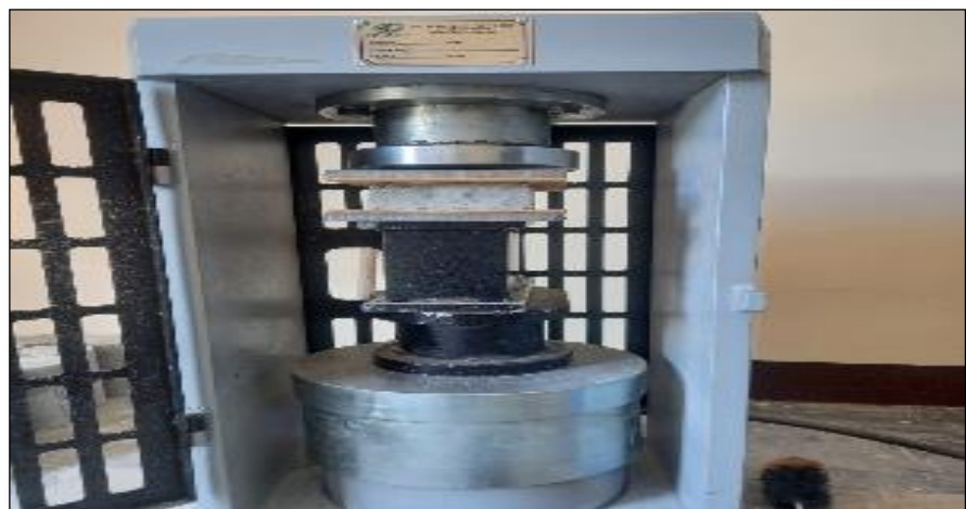
Figura 33. Rotura de ensayo de resistencia a la compresión , Por elaboración propia,2021.
