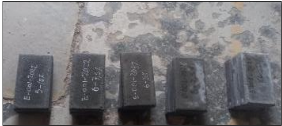
Figura 31. Etiquetado de adoquín de concreto con adición de PVC , Por elaboración propia,2021.
