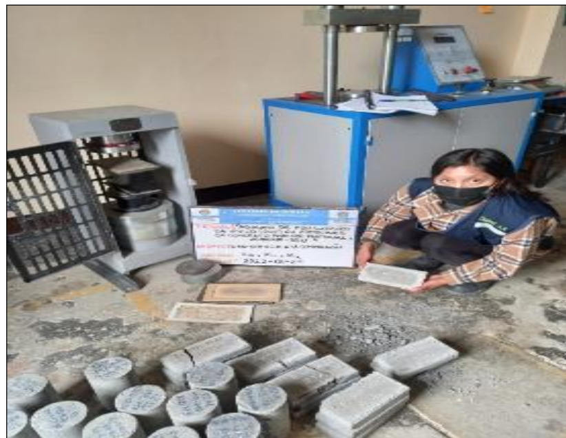
Figura 38. Ensayo a la compresión a la edad de 28 días , Por elaboración propia,2021.
