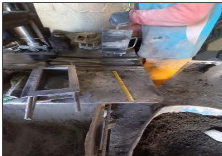
Figura 27. Maquina vibrocompactación del adoquín , Por elaboración propia,2021.
