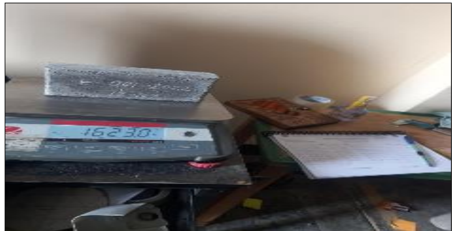
Figura 32. Toma de datos de la dimensiones y peso del adoquín , Por elaboración propia,2021.
