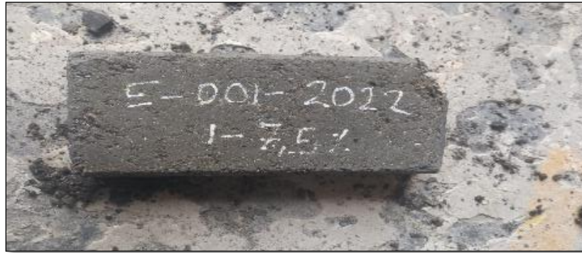
Figura 34. Espécimen sometido a la resistencia a la compresión , Por elaboración propia,2021.
