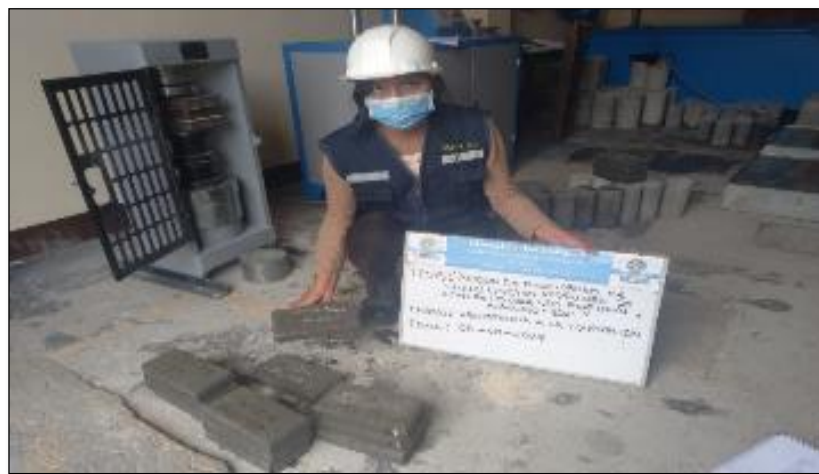
Figura 35. Ensayo a la compresión a la edad 7 días , Por elaboración propia,2021.
