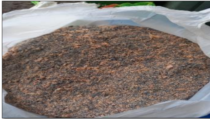
Figura 25. Viruta de policloruro de vinilo PVC , Por elaboración propia,2021.
