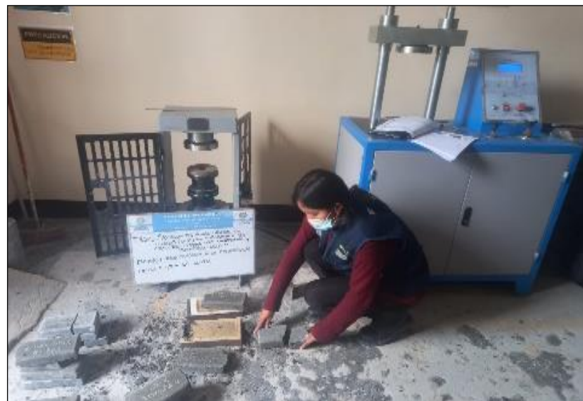
Figura 36. Ensayo a la compresión a la edad de 14 días , Por elaboración propia,2021.
