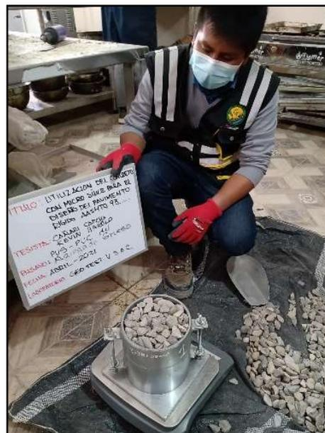
*Figura 12: Densidad (peso unitario) y los vacíos en el agregado grueso.*
