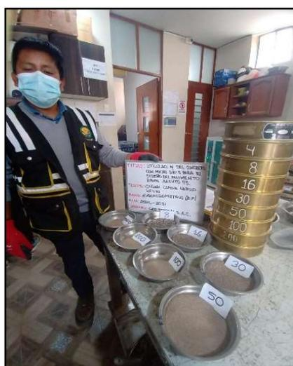
*Figura 6: Análisis granulométrico del agregado fino.*
