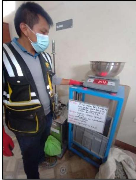
*Figura 13:* Contenido de humedad total de agregados por secado.
