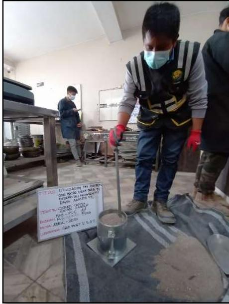
*Figura 8:* Densidad (peso unitario) y los vacíos en los agregados.
