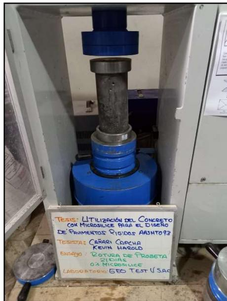
*Figura 16:* Ensayo de resistencia a la compresión.
