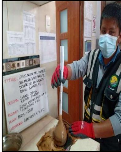
*Figura 7: Densidad relativa (peso específico) y absorción del agregado fino.*
