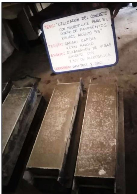
Figura 17: Ensayo de resistencia a la flexotracción.
