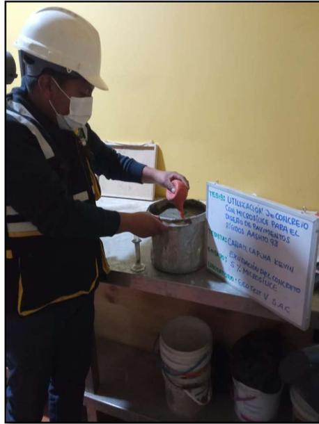
*Figura 14: Asentamiento de concreto fresco.*
