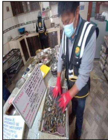
*Figura 11:* Densidad relativa (peso específico) y absorción del agregado grueso.
