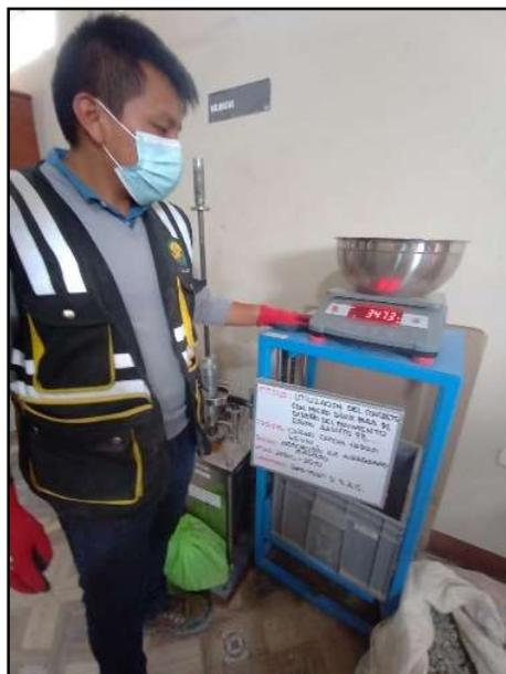
*Figura 9:* Contenido de humedad total de agregados por secado.
