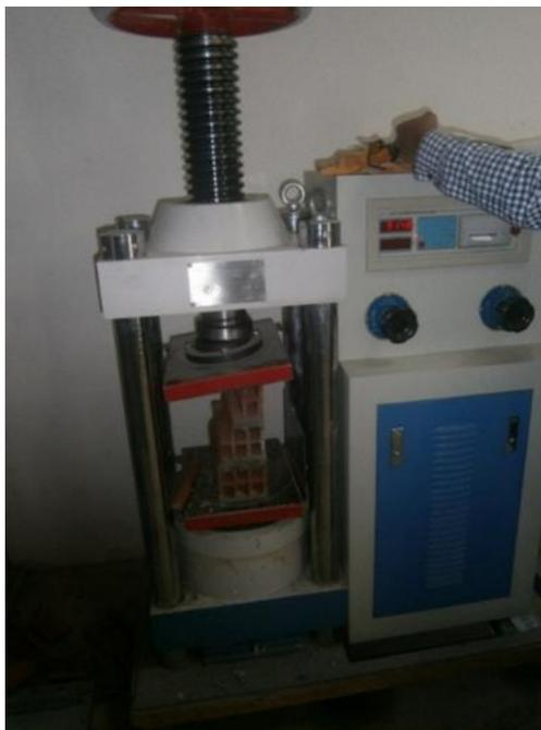
**Figura N°8 – Ensayo de prisma de albañilería**
