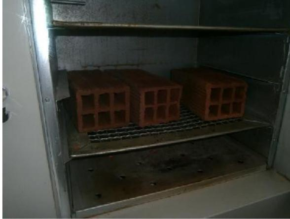
**Figura N°6 – Colocación de los especímenes al horno de secado.**
