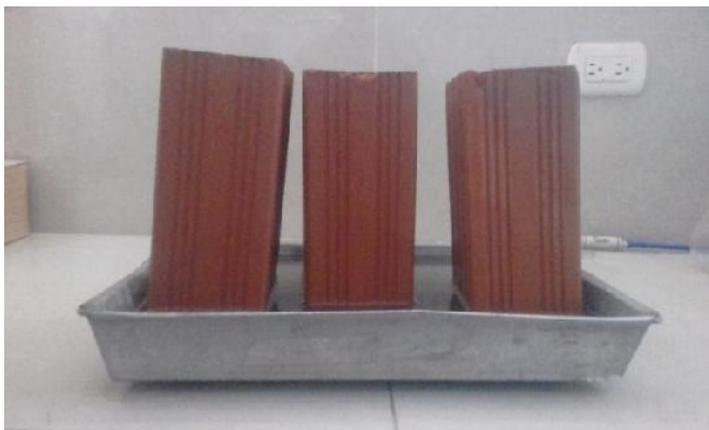
Figura N°7 – Especímenes en agua destilada
