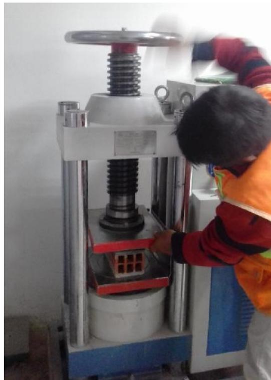
**Figura N°4 – Se realiza el ensayo a la unidad de albañilería**
